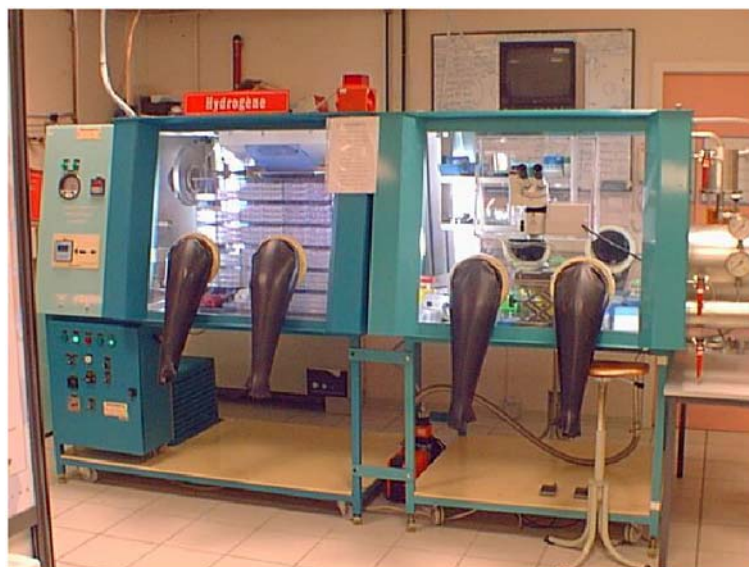
Figure II.4 : Vue de la boîte à gants. Le poste de gauche permet le stockage des boîtes de cristallisation alors que celui de droite est utilisé pour la manipulation des cristaux et la réalisation des gouttes.
