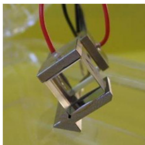
FIG. 2.3 – Cellule de Pockels en RTP. Deux cristaux tournés de 90^\circ autour de l'axe optique sont nécessaires pour la compensation thermique.
