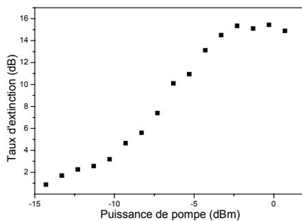
Figure 2 : Fonction de transmission du régénérateur.
