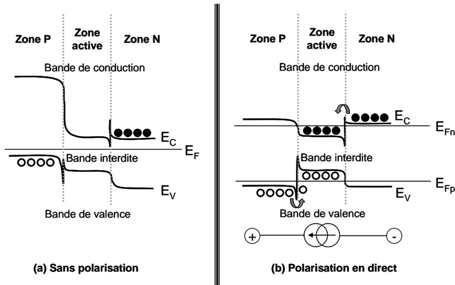
Figure 4.2 : Schématisation d'une double hétéro-jonction
