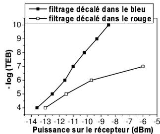
Figure 2 : Mesure de TEB à 80 Gbit/s avec filtrage dans le bleu et dans le rouge.
