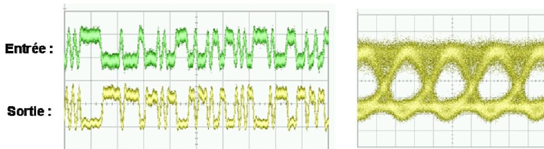
Figure 6.14 : Etude expérimentale du TASR en réponse au format NRZ.
