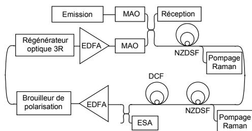
Figure 4 : Schéma de la boucle à recirculation.
