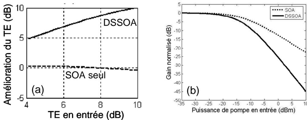
Figure 5.28 : Comparaison numérique des fonctions caractéristiques du DSSOA et d'un SOA seul.
