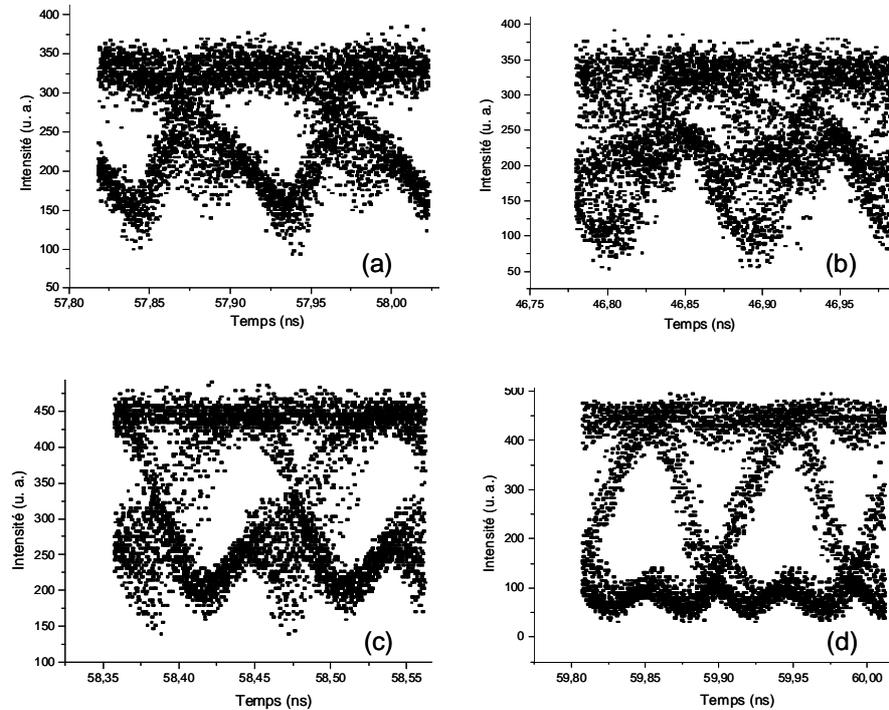
Figure 5.20 : Diagrammes de l'œil significatifs du comportement du NOLM-SOA en réflexion. (a) :  $\Delta T = +30$  ps ; (b) :  $\Delta T = +65$  ps ; (c) :  $\Delta T = -30$  ps ; (d) : Conversion de format ( $\Delta T = +30$  ps).
