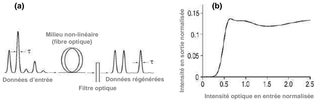
Figure 3.12 : Technique de régénération par association auto-modulation de phase et filtrage décalé.
