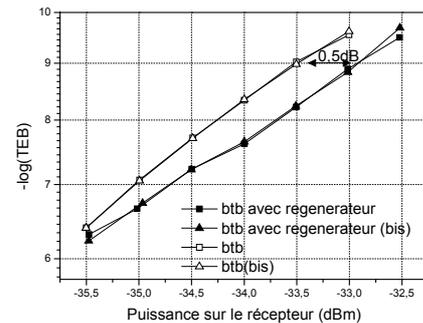
Figure 3 : Mesure de la pénalité du régénérateur.
