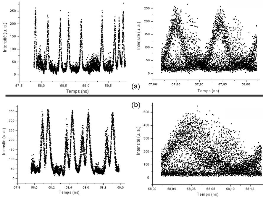
Figure 5.19 : Etude expérimentale de l'impact du paramètre  $\Delta T$  sur la sortie transmission du NOLM-SOA du point de vue de la séquence (à gauche) et du diagramme de l'œil correspondant (à droite).
