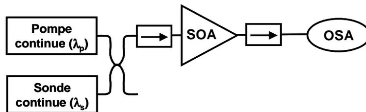
Figure 4.21 : Schéma de montage d'une caractérisation de gain statique en configuration pompe/sonde.
