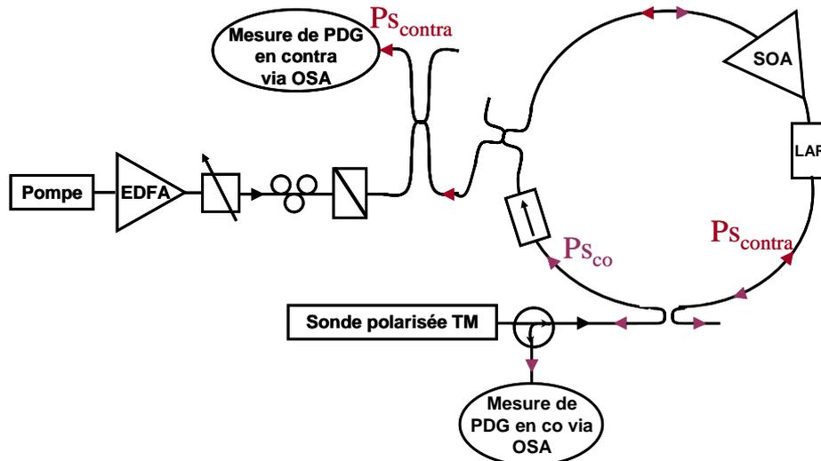
Figure 5.52 : Mesure de dépendance à la polarisation du SOA dans la configuration du NOLM-SOA via utilisation du montage sans interférences.
