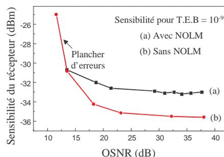
Figure 5: Caractérisation du récepteur en présence du régénérateur
