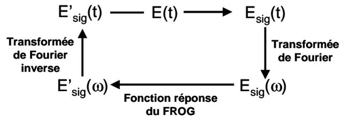
Figure 6.10 : Schéma de principe de l'algorithme d'inversion.
