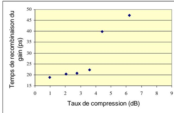
Figure 6.5 : Etude expérimentale du lien entre le temps de récupération du gain et le taux de compression : exemple de résultats obtenus avec les SOA utilisés dans les fonctions optiques étudiées
