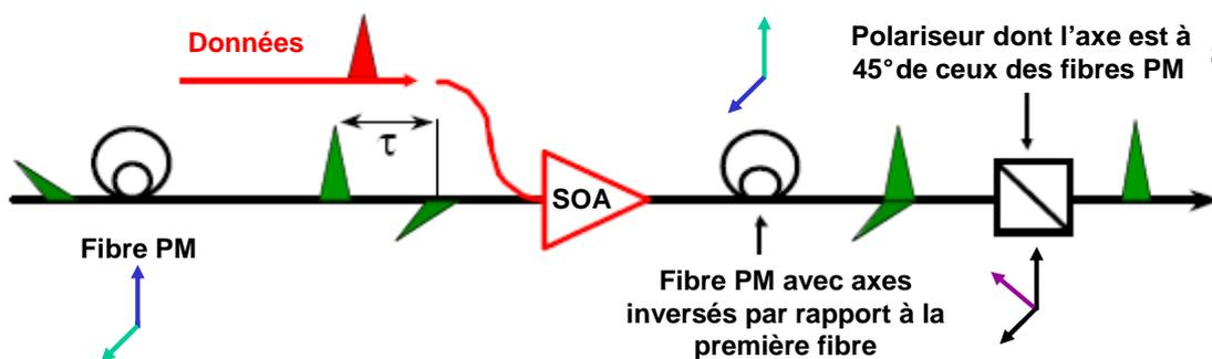
Figure 3.7 : Schéma de principe d'un interféromètre UNI.
