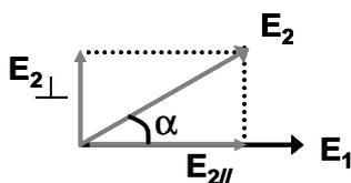
Figure D- 4 : Cas de polarisation rectilignes quelconques.
