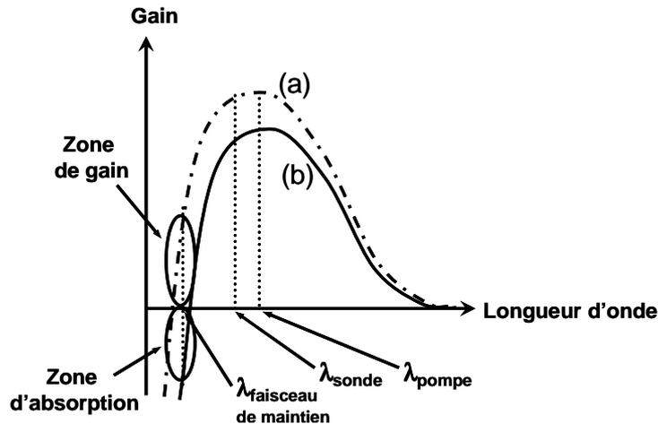
Figure 6.2 : Principe du cas d'un faisceau de maintien à une longueur d'onde proche de la transparence.
