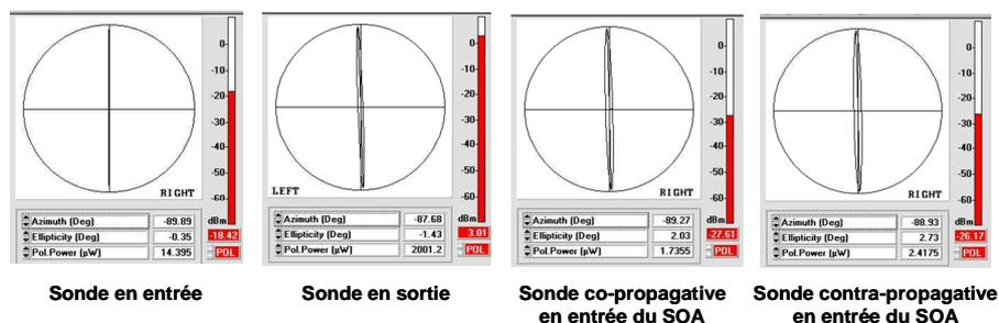
Figure 5.50 : Maintien de la polarisation de la sonde dans le montage expérimental du NOLM-SOA.
