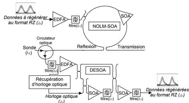
Figure 1 : Schéma de principe du régénérateur.
