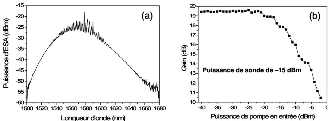
Figure 6.7 : Caractérisation statique d'un SOA « nouvelle génération ».
