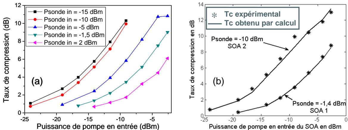
Figure 5.30 : Etude expérimentale des taux de compression de chacun des SOA du DSSOA. (a) : Mesure du taux de compression pour différentes puissances de sonde fixées ; (b) : Validation de la mesure.
