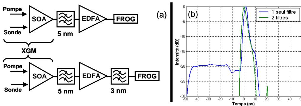
Figure 6.30 : Impact de l'introduction d'un second filtre.
