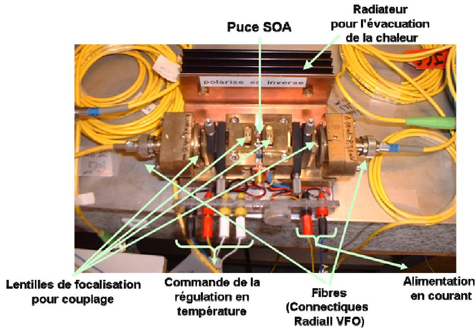
Figure 4.16 : Module SOA pour couplage via lentilles.
