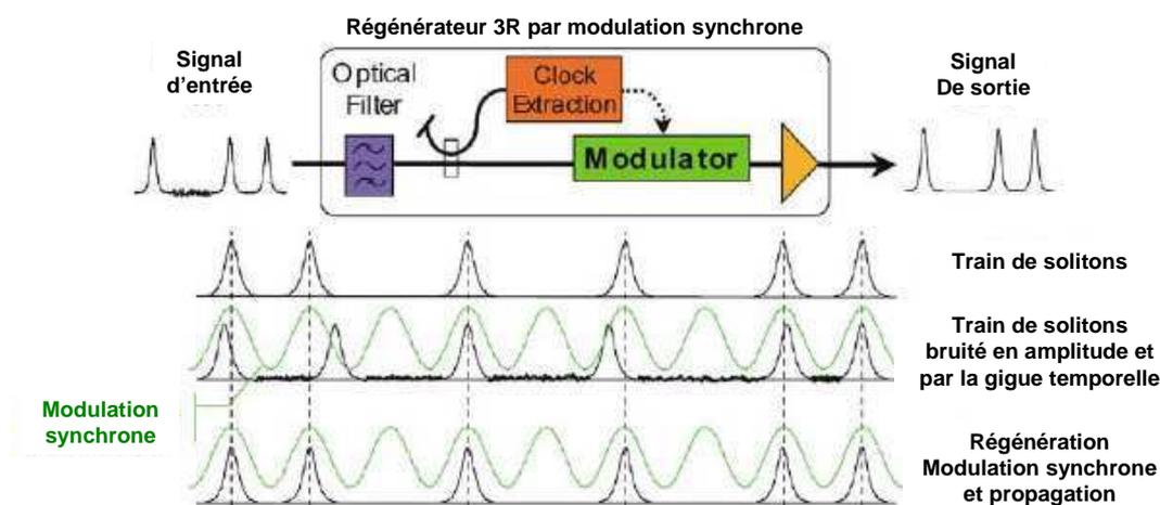
Figure B- 1 : Principe général de la régénération 3R par modulation synchrone.
