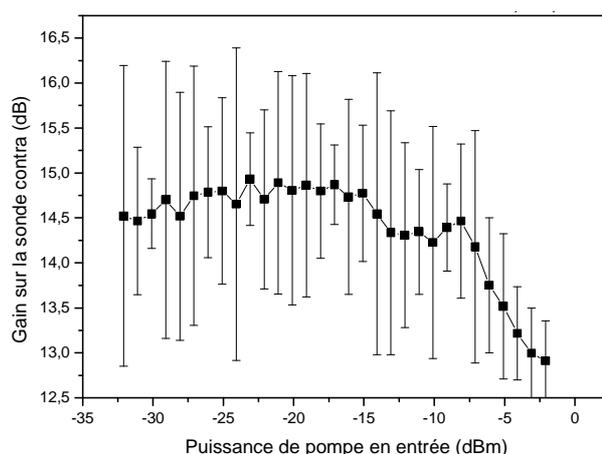
Figure C- 11 : Fluctuations de gain en contra-propagation dues à des interférences dans le montage.
