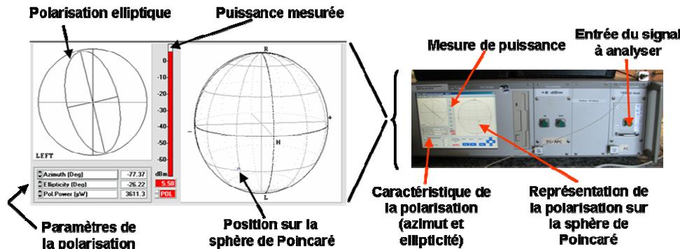
Figure C- 8 : Polarimètre utilisé au laboratoire.
