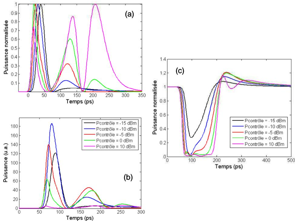
Figure 5.11 : Etude numérique de l'influence de la puissance de l'impulsion de contrôle sur le fonctionnement du NOLM-SOA ( $\Delta T = 20$  ps et  $P_{\text{sonde}} = -35$  dBm).
