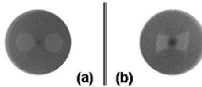
Figure C- 6 : Photographies des extrémités de deux fibres à maintien de polarisation.
