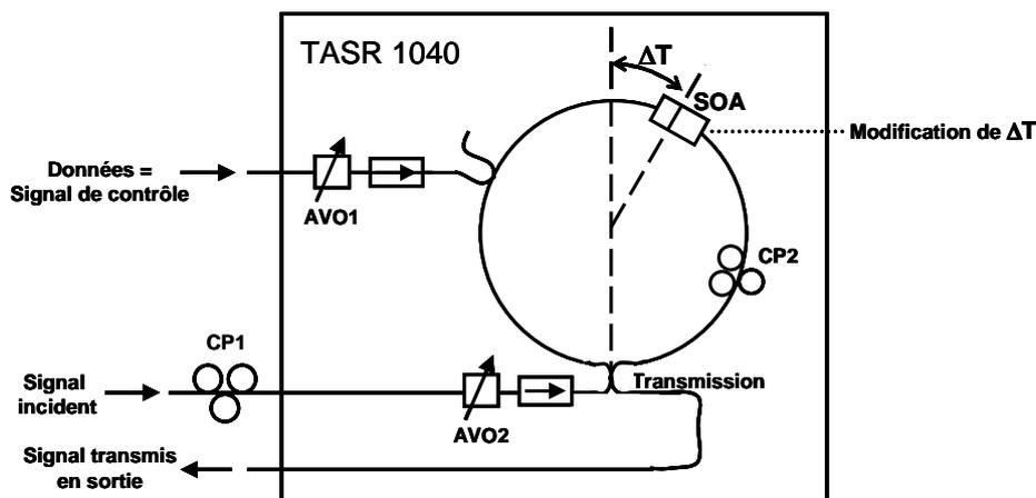
Figure D- 1 : Schématisation du TASR 1040.
