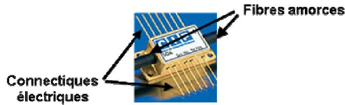
Figure 4.12 : Amplificateur à semi-conducteurs monté en boîtier « butterfly ».
