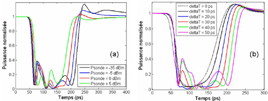
Figure 5.13 : Etude de l'influence du décalage du SOA dans la boucle, symbolisée par  $\Delta T$ .
