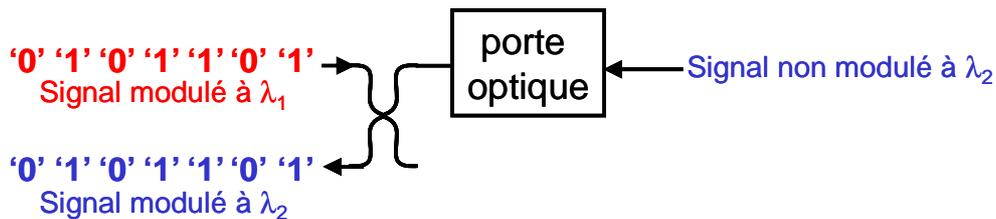
Figure 2.3 : Porte en modulation croisée en contra-propagation.
