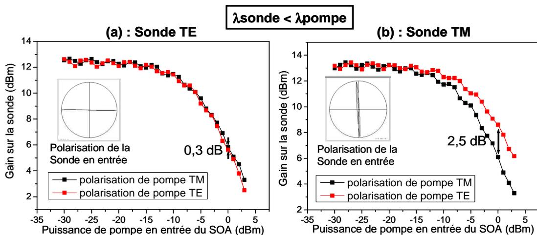
Figure 5.58 : Mesure de la PDG du SOA en pompe/sonde co-propagatives quand  $\lambda_s < \lambda_p$ .
