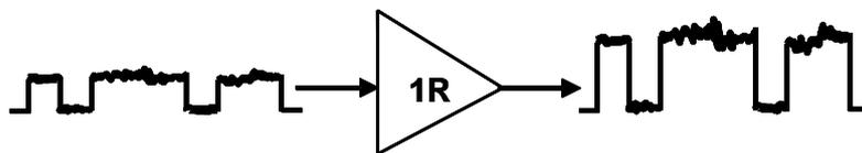
Figure 2.5 : Principe de la régénération 1R.
