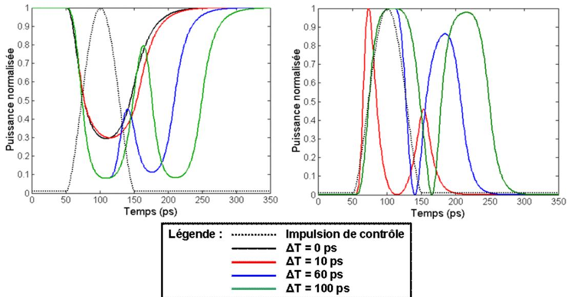
Figure 5.5 : Étude numérique de l'influence du décalage du SOA sur les sorties réflexion et transmission.
