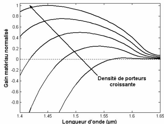
Figure 4.5 : Courbes de gain en fonction de la longueur d'onde pour différentes densités de porteurs.
