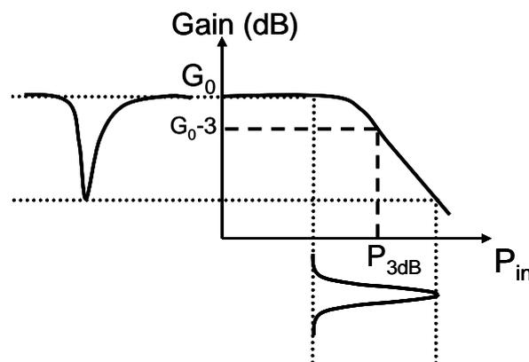
Figure 4.20 : Courbe de gain statique d'un SOA et illustration de la compression de gain.
