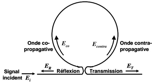
Figure 5.1 : Schéma de principe d'une boucle de Sagnac.
