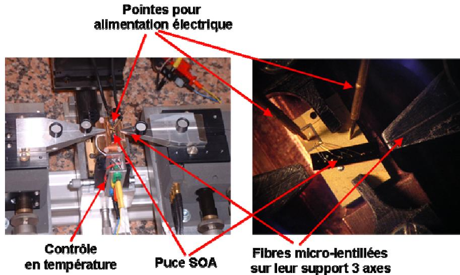
Figure 4.15 : Banc de couplage via fibres micro-lentillées.
