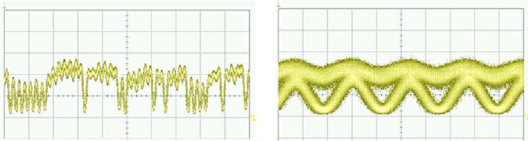
Figure 6.18 : Acquisitions à l'oscilloscope en sortie du TASR dans le cas d'un signal d'entrée au format RZ.
