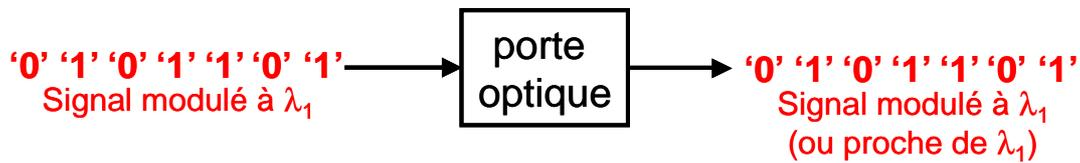
Figure 2.4 : Principe de fonctionnement des dispositifs tout-optiques en auto-modulation.
