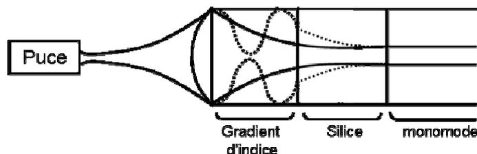
Figure 4.14 : Schéma d'une fibre micro-lentillée avec propagation des faisceaux.
