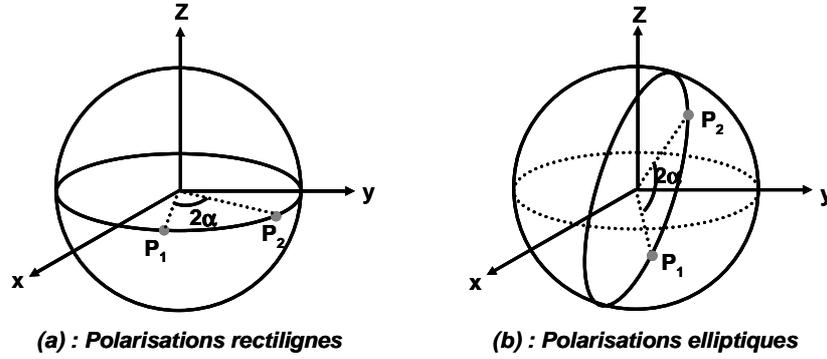
Figure D- 5 : Représentation de la polarisation des deux ondes sur la sphère de Poincaré.
