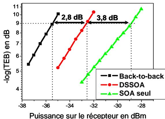
Figure 5.32 : Comparaison des pénalités introduites expérimentalement par le DSSOA et par un SOA seul.
