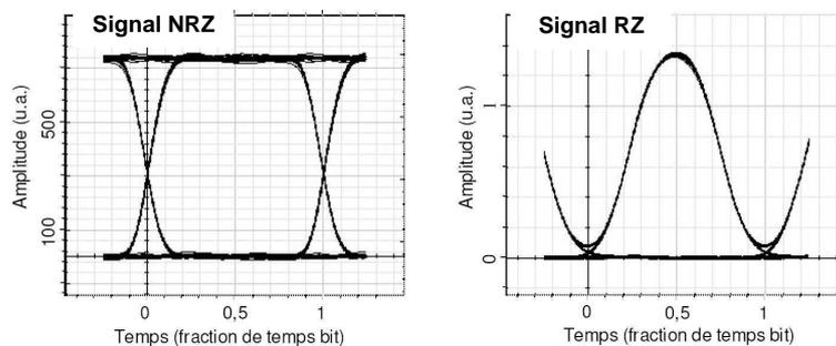
Figure 1.13 : Diagrammes de l'œil d'un signal NRZ, à gauche, et d'un signal RZ, à droite.
