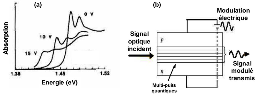
Figure 3.10 : Principe du modulateur à électro-absorption.
