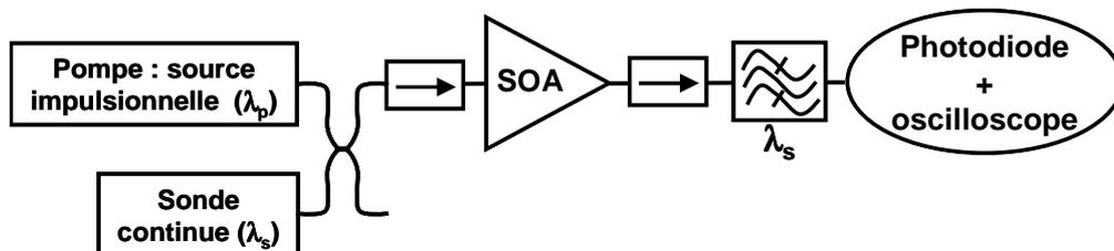
Figure 4.23 : Schéma simplifié d'un banc de caractérisation dynamique.
