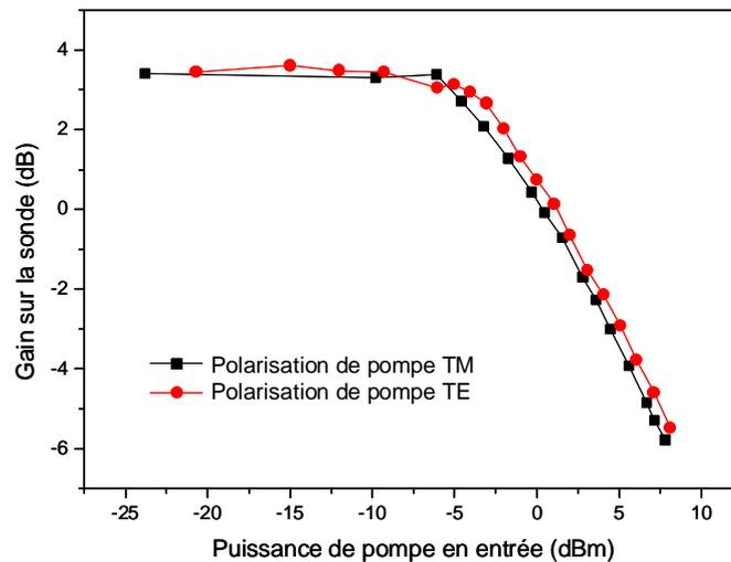
Figure 5.51 : Mesure de PDG du NOLM-SOA.
