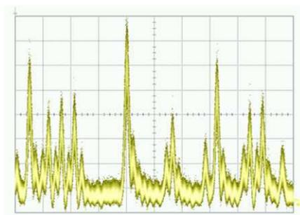
Figure D- 7 : Séquence transmise par le TASR 1040 lorsque les polarisations des ondes co et contra-propagatives sont optimisées pour être colinéaires à l'entrée du coupleur où elles interfèrent.
