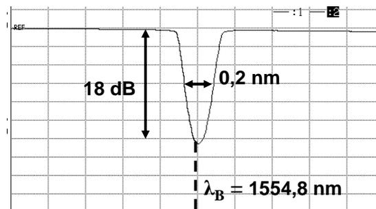
Figure 6.25 : Transmission du filtre de Bragg utilisé.
