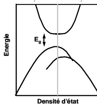
Figure C- 4 : Schéma de bandes d'un semi-conducteur contraint.
