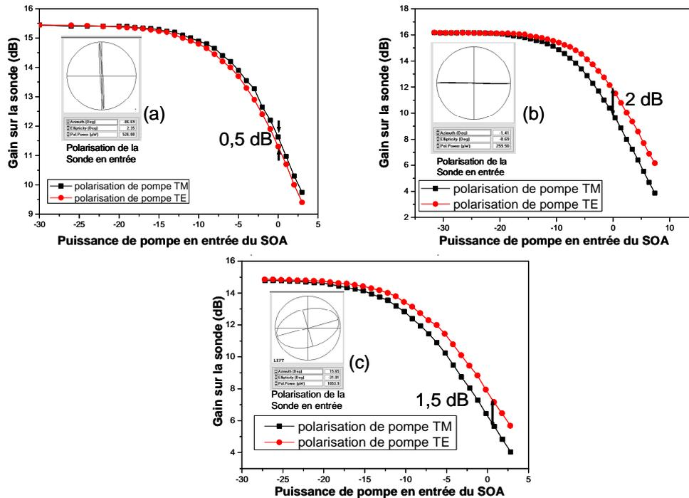
Figure 5.57 : Mesure de la PDG du SOA dans différentes configurations de polarisation de sonde. (a) : Polarisation de sonde TM (comme dans le NOLM-SOA) ; (b) : Polarisation de sonde TE ; (c) : Polarisation de sonde elliptique (comme dans le double étage)
