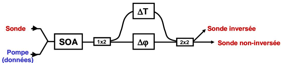
Figure 3.6 : Schéma de principe de l'interféromètre DI.
