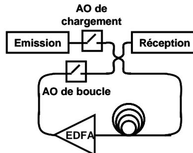
Figure 2.13 : Schéma de principe d'une boucle à recirculation.
