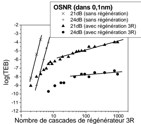
Figure 5.45 : Evolution expérimentale du taux d'erreur binaire en fonction du nombre de tours de boucle (ce qui équivaut à la longueur de transmission ou au nombre de cascades de régénérateurs).
