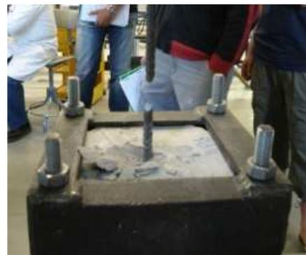
Figure 3.21 – Deux modes de rupture lors des essais d'arrachement
