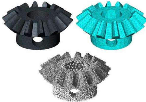
Figure 2.5 – Exemple d’une forme complexe obtenue par la méthode de [Jerier *et al.*, 2009]
