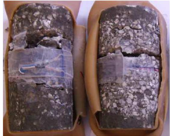
Figure 1.17 – Faciès de rupture pour les pressions de confinement de 650MPa (à gauche) et 200MPa (à droite) [Gabet, 2006]
