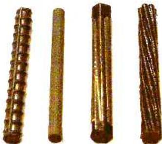
Figure 3.11 – Différents types de barres en acier [Cox *et al.*, 2000]
