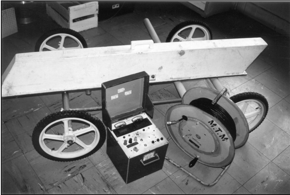
Fig. 2.3 : Le SH3, avec sa boîte d'acquisition et son câble de connexion.
