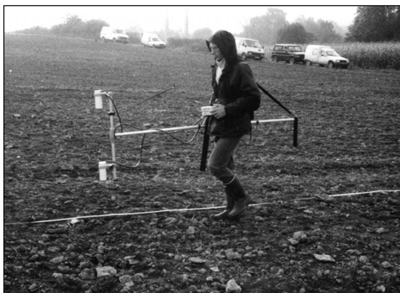
Fig. 2.2 : Le gradiomètre au Césium G858 de Geometrics
