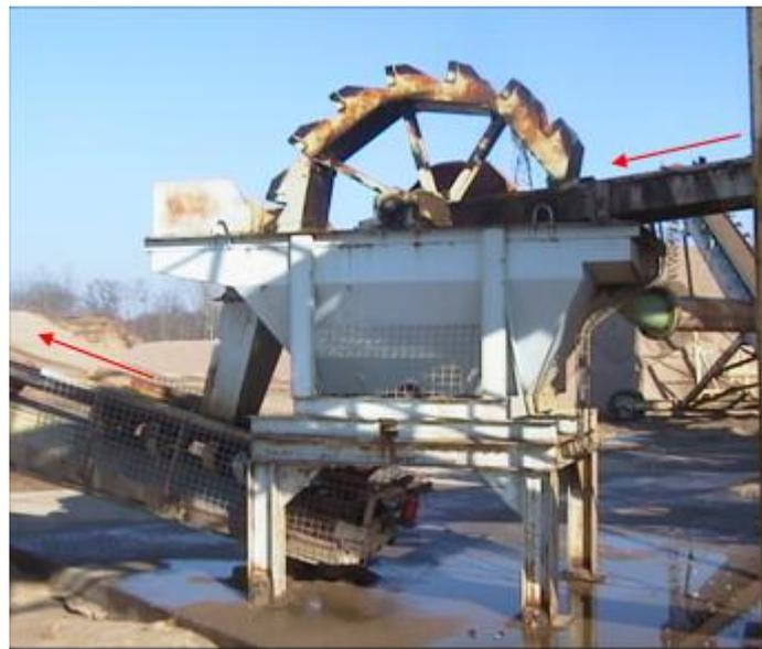
Fig. 40 : Roue à sable
