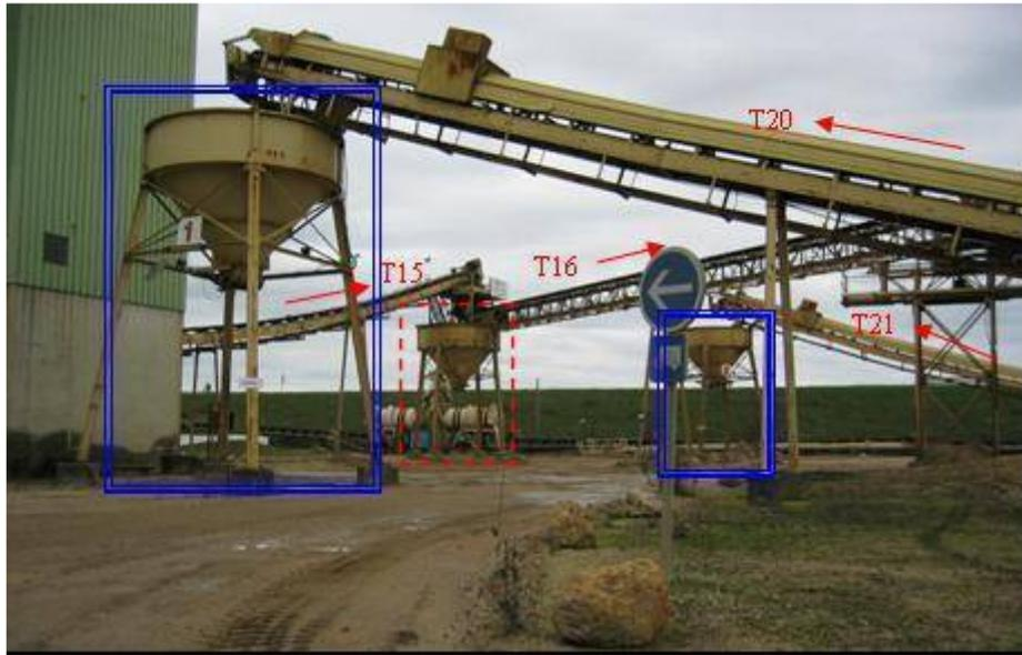
Fig. 34 : Les trémies de stockage et de déstockage à la sortie de l'installation de traitement
