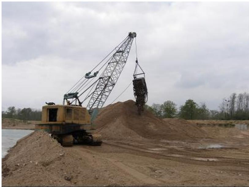
*Fig. 38 : L'extraction par la dragueline sur le site n°3*
