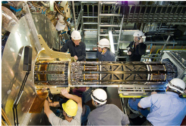
FIGURE 2.11: Insertion du détecteur à pixels au sein d'Atlas en juin 2007.
