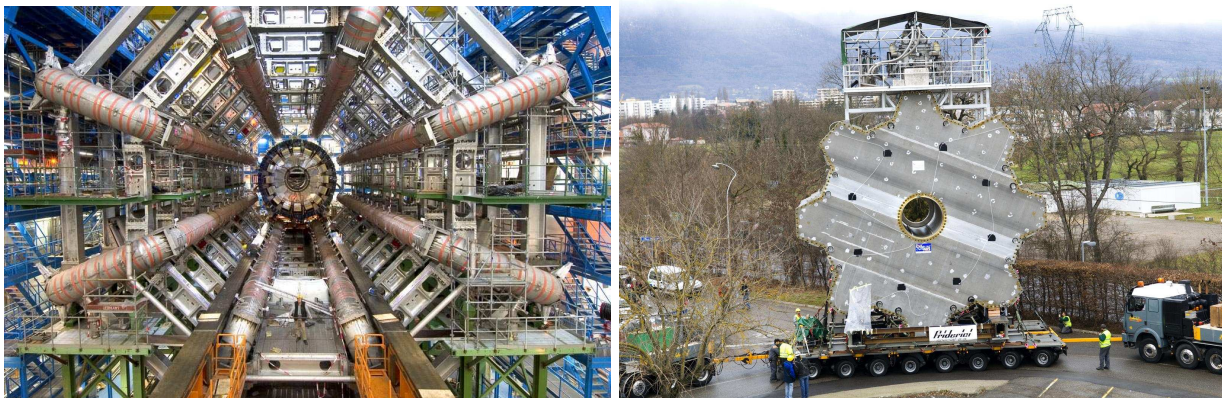
FIGURE 2.22: Gauche : Vue des huit aimants toroïdaux tonneau installés dans la caverne. Droite : Transfert d'un des deux aimants toroïdaux bouchons.
