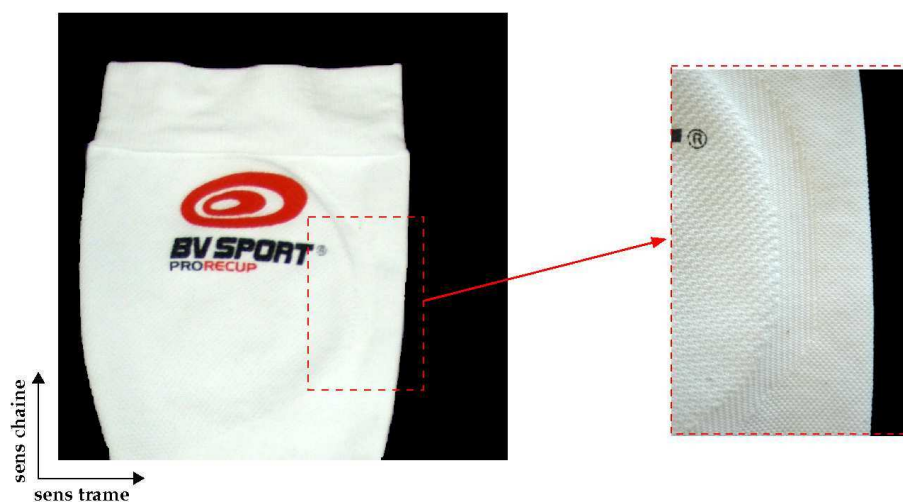
Figure 4.2 – Différence de structuration du tricot entre la partie située sur le mollet et celle sur le tibia pour la chaussette C
