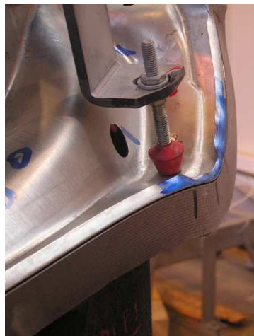
FIG. 5.12 – Photographie de la partie de l'ouvrant X7 porte arrière présentant des plis au présertissage.
