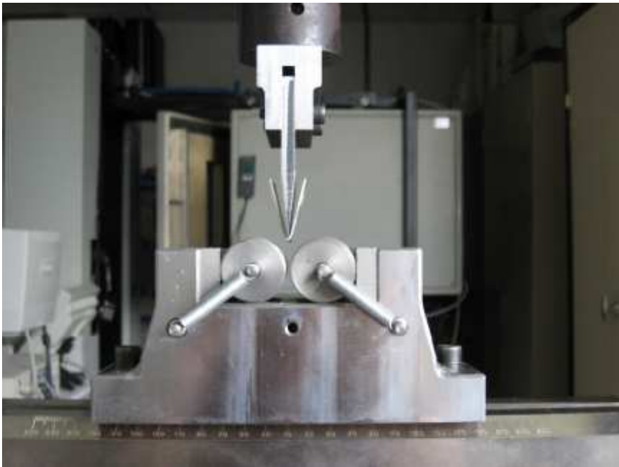
FIG. 6.42 – Photographie du dispositif de pliage développé par L. Fermen [75] d'après un dispositif proposé par Pechiney [54].
