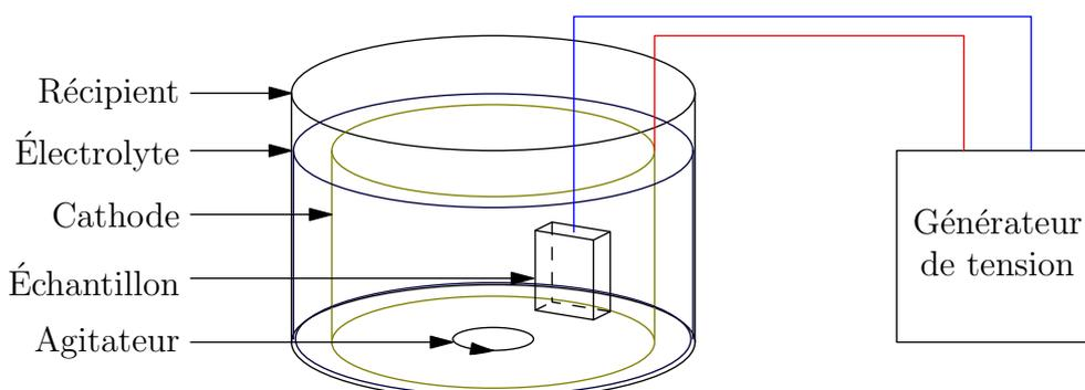
**Fig. II.5** : Polissage électrolytique : schéma du dispositif utilisé.
