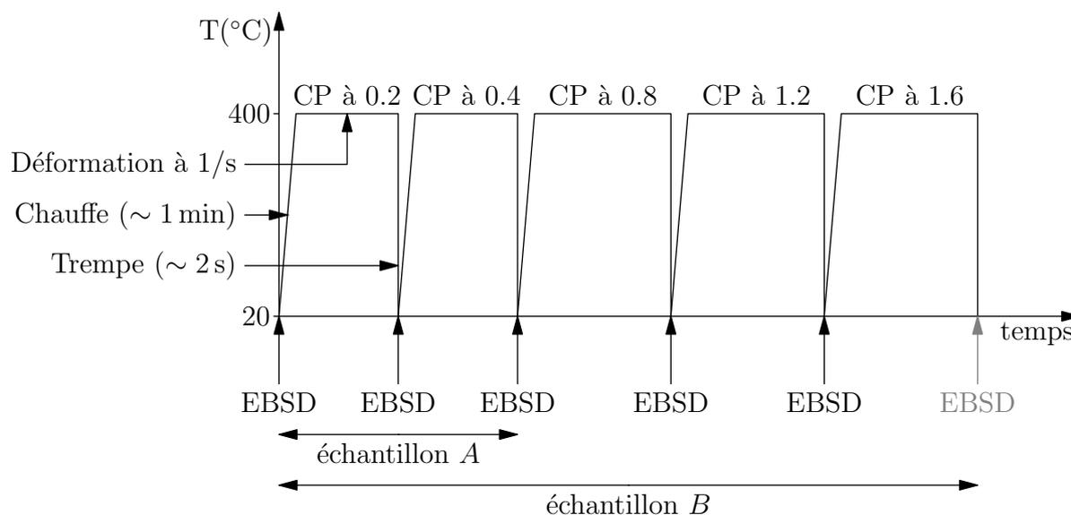
**Fig. II.1** : Déroulement de l'étude expérimentale : cycles de déformation et de caractérisation microstructurale appliqués aux échantillons A et B.
