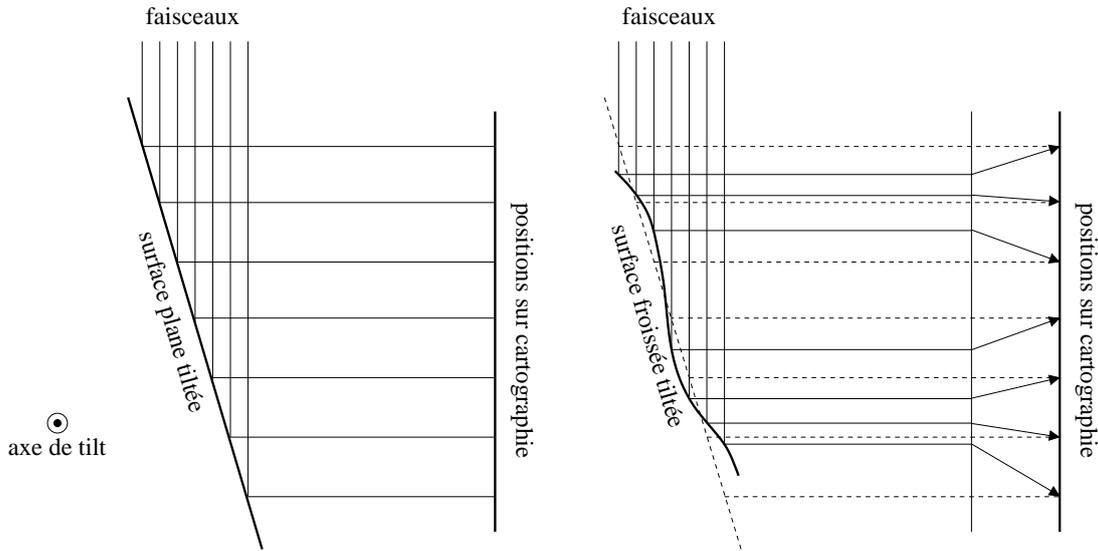
**Fig. IV.6 :** Influence de l’aspect froissé de la surface interne sur les distances apparaissant sur la cartographie. (a) Cas standard d’une surface plane, (b) cas d’une surface froissée, pour laquelle les distances ne sont pas respectées.
