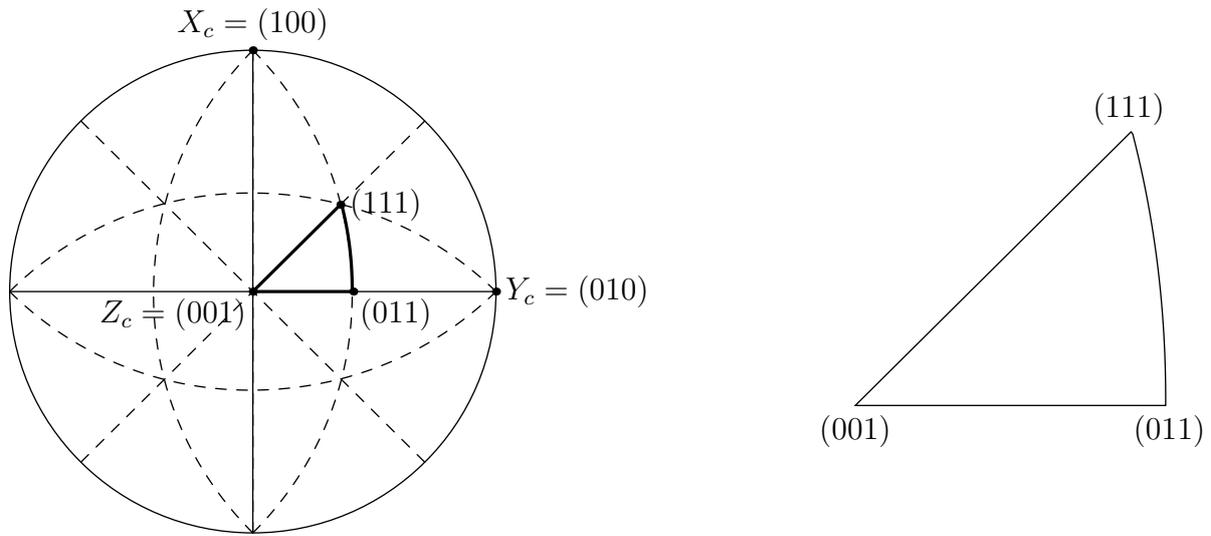
**Fig. A.3** : Description d'une orientation par une figure de pôles inverse. La figure de gauche représente le plan équatorial complet. Les lignes pointillées délimitent les parties équivalentes dans le cas d'un cristal de symétrie cubique. Les lignes épaisses délimitent la partie suffisante, le *triangle cristallographique (standard)*, reproduit sur la figure de droite.
