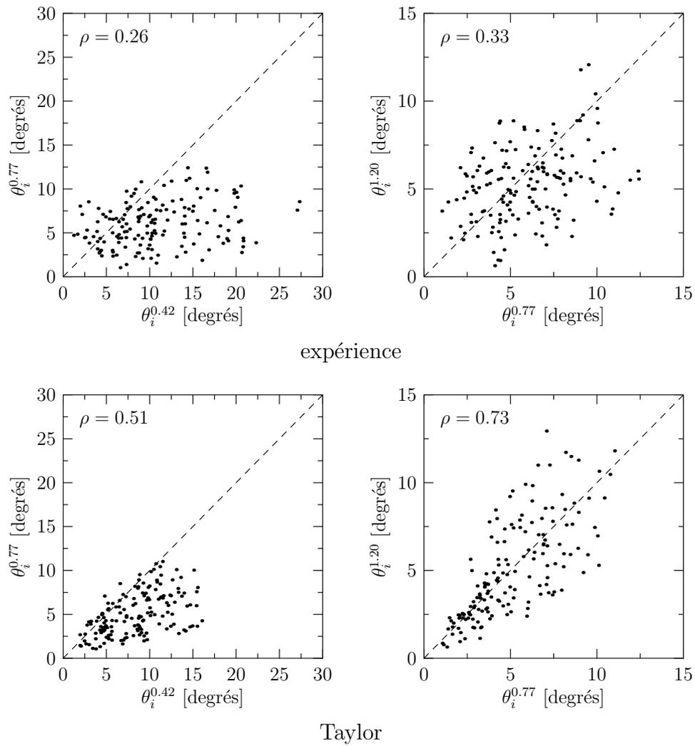
**Fig. VI.7 :** Chemins de rotation expérimentaux et simulés : corrélations entre les angles de rotation aux incréments de déformation successifs. ( $\rho$  : coefficient de corrélation linéaire.)
