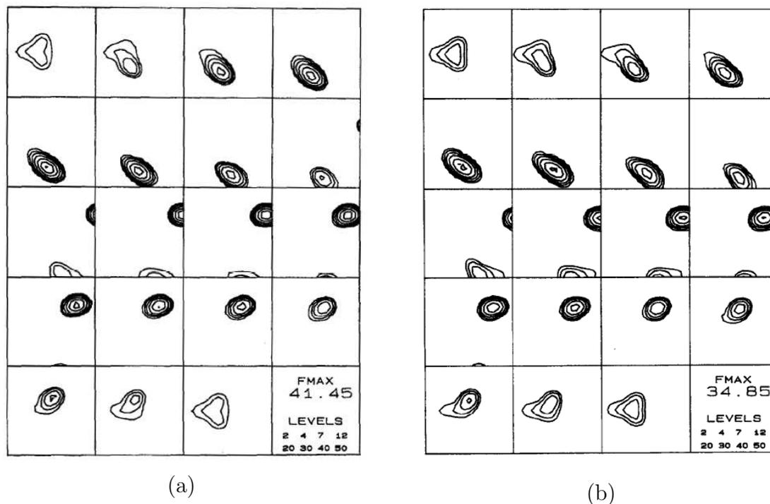
**Fig. I.3** : Textures de compression plane simulées d'un alliage d'aluminium (systèmes octaédriques seuls, comportement viscoplastique avec  $m = 0.1$ ) à  $\varepsilon = 2.0$  [51]. (a) Modèle de Taylor FC, (b) modèle autocohérent (VPSC).
