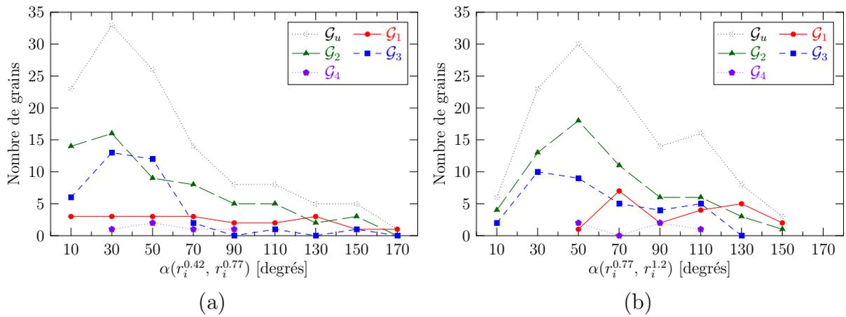
**Fig. V.32 :** Chemins de rotation des grains des ensembles  $\mathcal{G}_i$  : angles  $\alpha$  entre axes de rotation successifs. (a) Premier et deuxième incréments, (b) deuxième et troisième incréments.
