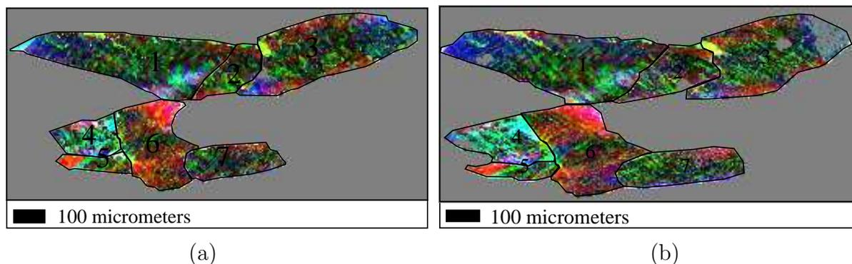
**Fig. IV.9** : Effet de la surface interne sur les microtextures : champs de désorientations par rapport aux orientations moyennes en (a) surface et (b) sous-surface. Représentation en vecteur de Rodrigues; DL = rouge, DT = vert, DN = bleu; amplitude de 0 à 10° (de foncé à clair). La similarité de (a) et (b) confirme la faible influence de la surface interne.
