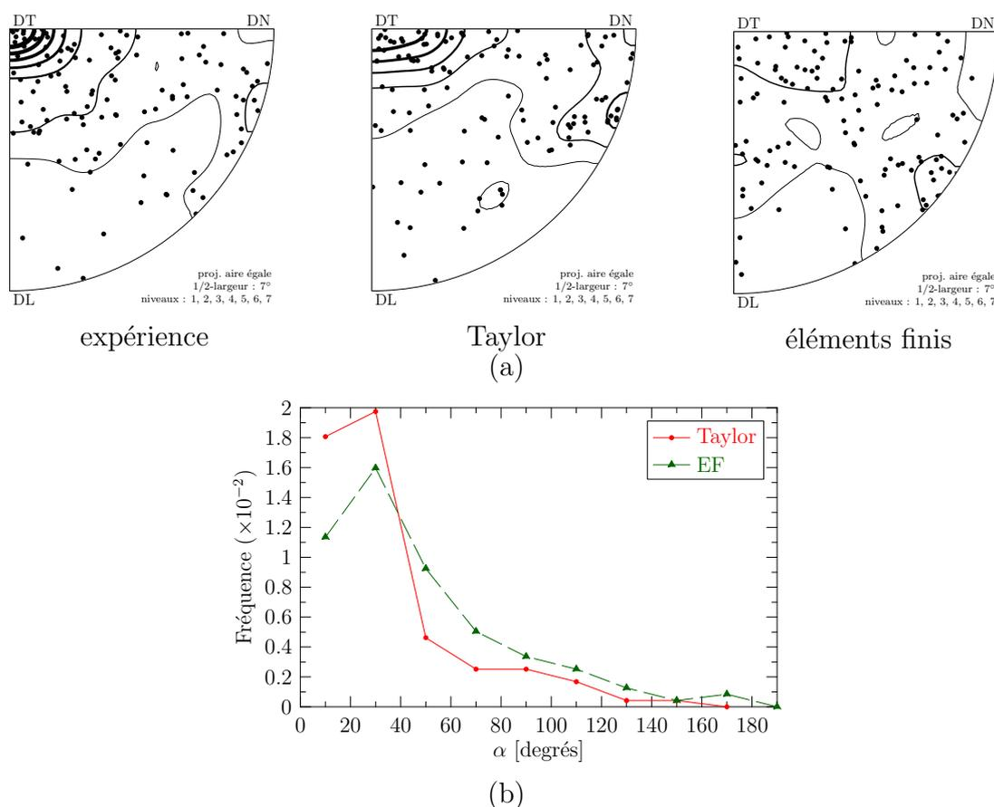
**Fig. D.3** : Comparaison des axes de rotations expérimentaux et prédits par les modèles de Taylor et EF. (a) Distributions globales, (b) distribution des angles  $\alpha$  entre les axes expérimentaux et simulés.
