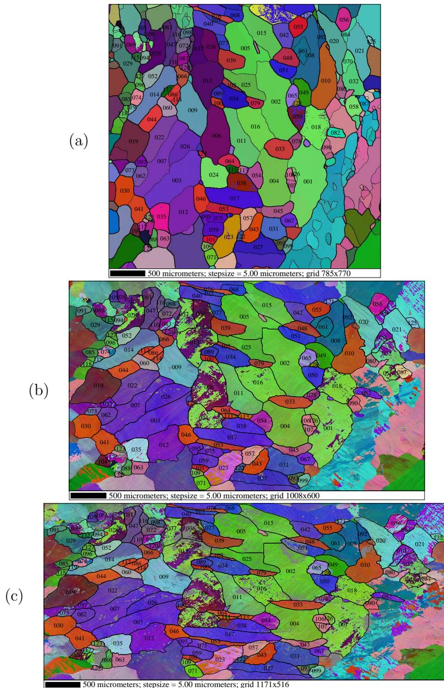
**Fig. B.2** : Microtextures de l'échantillon A. (a)  $\varepsilon = 0$ , (b)  $\varepsilon = 0.25$ , (c)  $\varepsilon = 0.40$ . Cartographies selon vecteur de Rodrigues. Les contours représentent : (a) les désorientations locales (épais  $> 15^\circ$ , fin  $> 5^\circ$ ), (b, c) les contours des grains précédemment définis.
