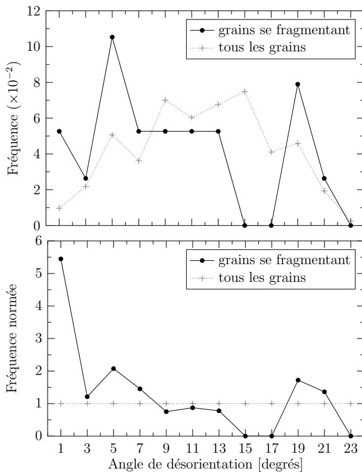
**Fig. V.20** : Fragmentation : symétrie par rapport aux axes de l'échantillon. L'angle de désorientation représente la distance au plan de symétrie le plus proche (voir le corps du texte pour le calcul de cette désorientation).
