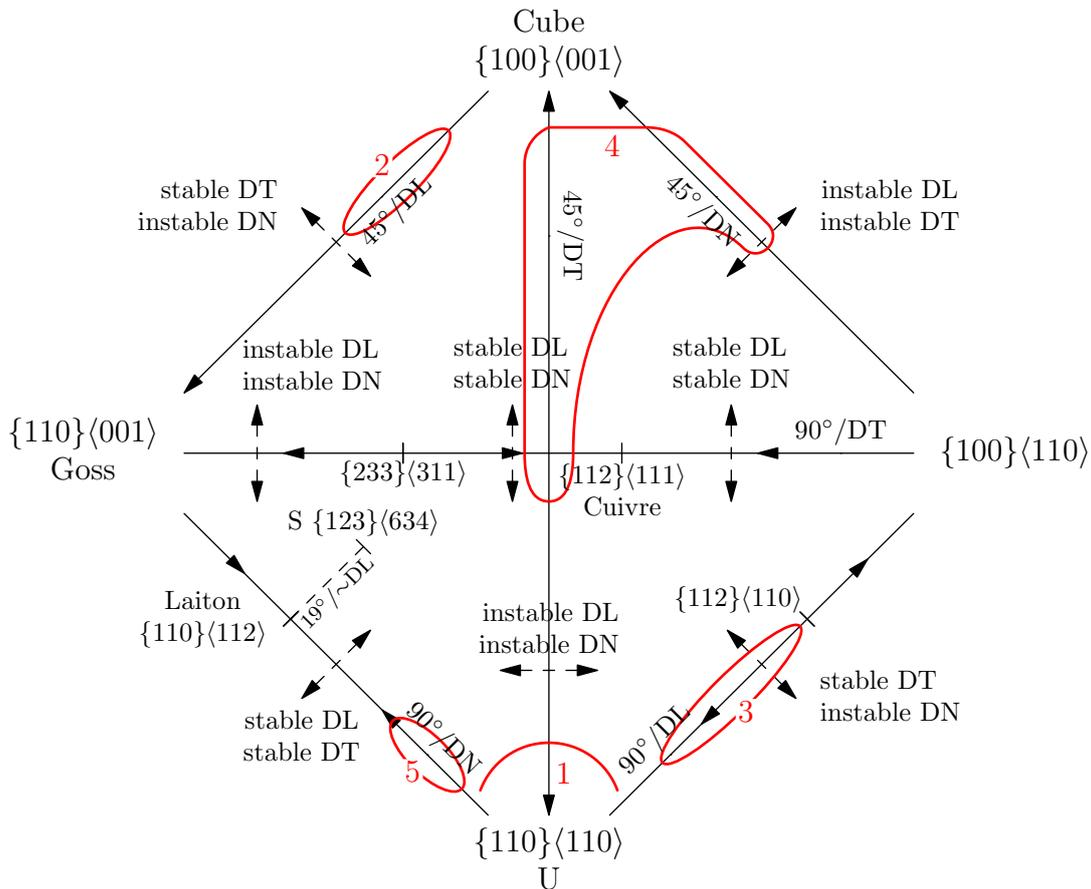
**Fig. V.21** : Fragmentation : cas des orientations symétriques. Réseau représentant l'ensemble des orientations symétriques, conditions de stabilité de ces orientations (flèches), et localisation approximatives des 5 ensembles de grains subissant une fragmentation.
