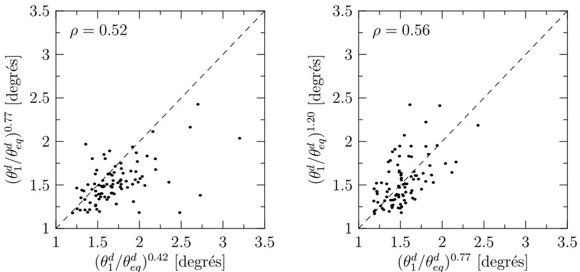
**Fig. V.15** : Dispersions intragranulaires : corrélation des anisotropies, aux déformations successives. Chaque point représente un grain. Voir le corps du texte pour la définition de  $\theta_1^d/\theta_{eq}^d$ .
