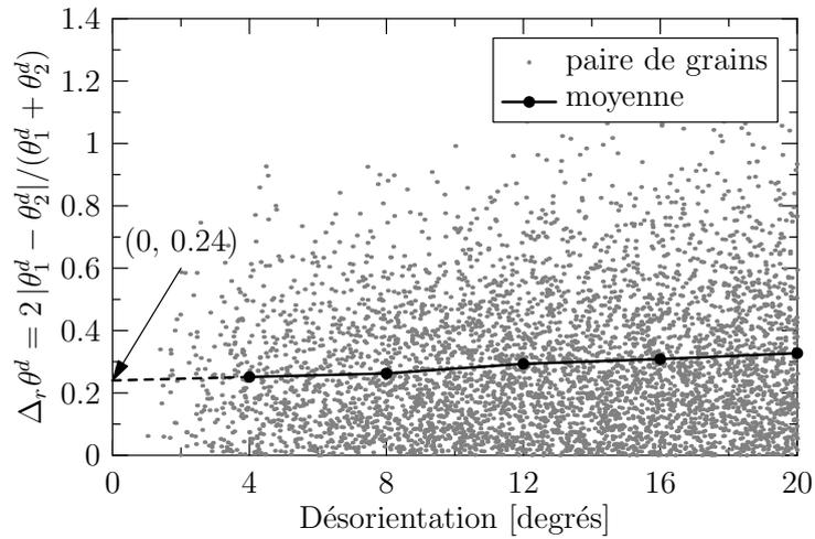
**Fig. V.24** : Variabilité des dispersions intragranulaires à  $\varepsilon = 1.2$  en fonction de la désorientation entre orientations courantes ( $\varepsilon = 1.2$ ). Voir le corps du texte pour la définition de  $\Delta_r \theta^d$ . Se référer à la figure V.23 pour la définition des nuages de points, et lignes. Le graphique est limité aux désorientations entre paires de grains inférieures à  $20^\circ$ .
