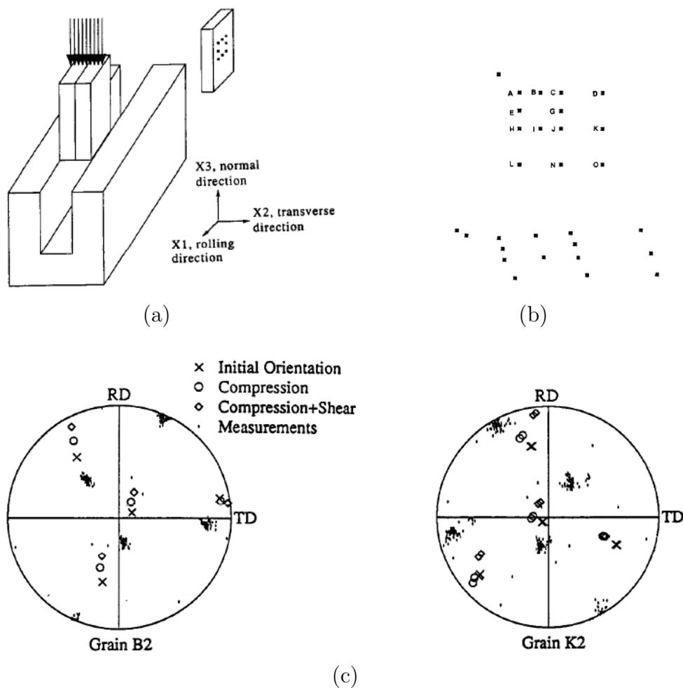
**Fig. I.6** : Suivi de grains dans un échantillon tranché en compression plane, par Panchanadeswaran *et al.* [13]. (a) Échantillon tranché et dispositif de compression plane. (b) Positions des empreintes de microdureté avant et après déformation (noter la composante de cisaillement). (c) Exemples de résultats pour deux grains ; échec du modèle de Taylor.
