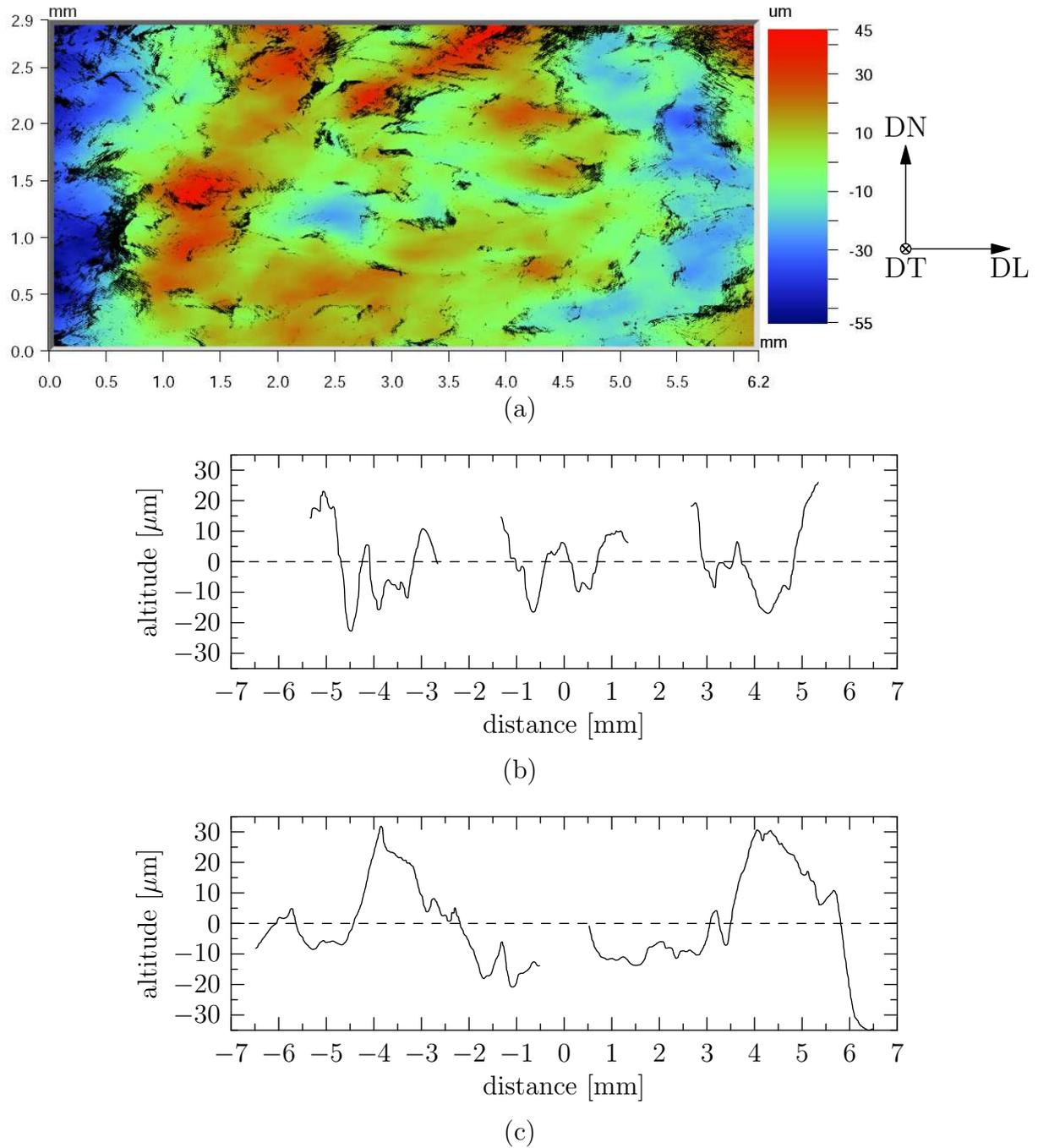
**Fig. IV.4** : Topographie de la surface interne déformée à 0.4. (a) Cas de l'échantillon A ; caractérisation par interférométrie optique effectuée par Alcan CRV. (b) et (c) Profils de rugosimétrie dans les directions DN et DL, respectivement (mesurés sur un autre échantillon). Noter les deux ordres de grandeur entre les abscisses et les ordonnées.
