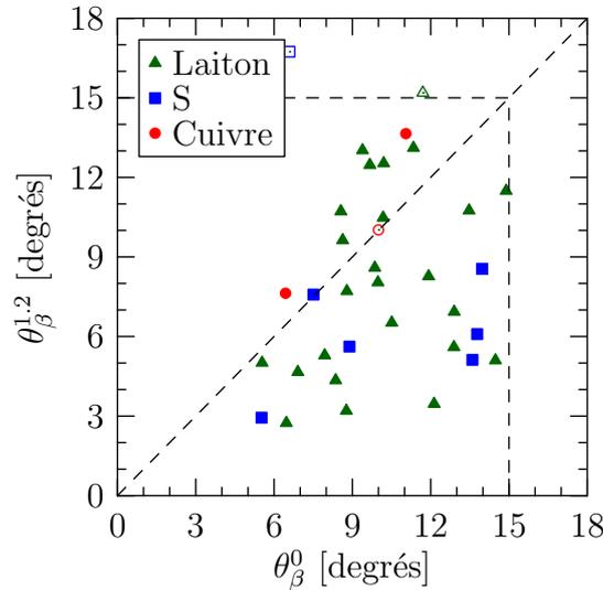
**Fig. V.28** : Stabilité des orientations initialement dans la fibre  $\beta$  : désorientations par rapport à la composante initiale à  $\varepsilon = 0$  et  $\varepsilon = 1.2$ . Les symboles ouverts représentent les grains ayant changé de composante.
