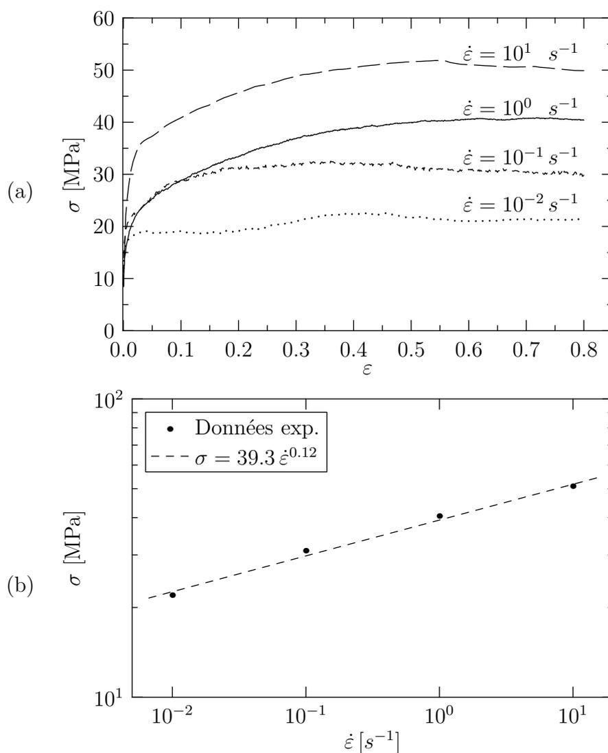
**Fig. B.1** : Détermination de la loi de comportement du matériau. (a) Courbes contrainte-déformation à différentes vitesses de déformation, (b) identification des paramètres  $a$  et  $m$  – les valeurs à saturation des contraintes sont considérées.
