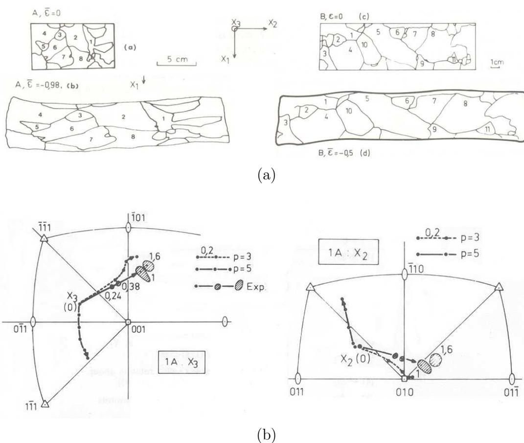
**Fig. I.4** : Suivi de grains dans des tôles multicristallines, par Skalli *et al.* [10]. (a) Tôles A et B, avant et après déformation. (b) Résultats pour le grain 1 de la tôle A, en accord avec le modèle pancake ( $p = 3$ ).
