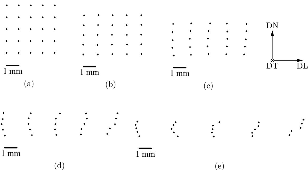
**Fig. IV.2** : Déformation subie par l'échantillon B, illustrée par son réseau d'empreintes de microdureté. (a)  $\varepsilon = 0$ , (b)  $\varepsilon = 0.19$ , (c)  $\varepsilon = 0.42$ , (d)  $\varepsilon = 0.77$  et (e)  $\varepsilon = 1.2$ .
