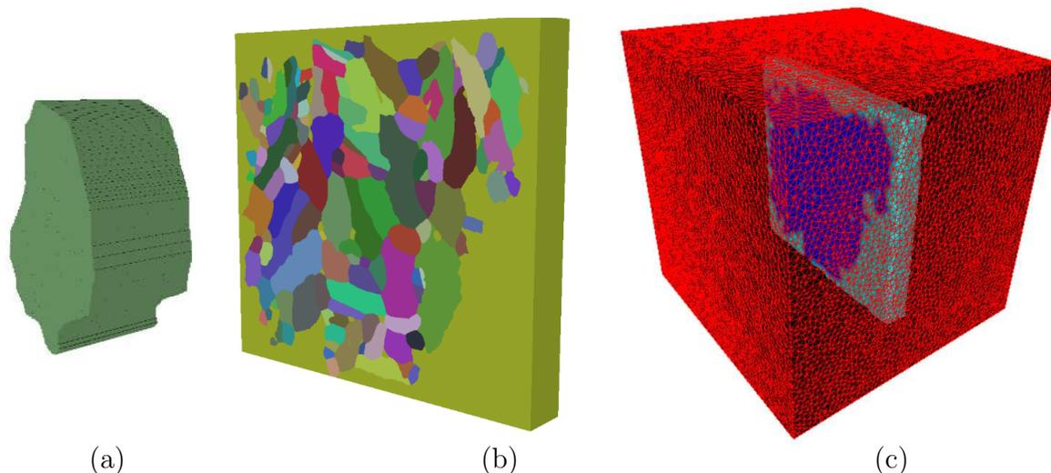
**Fig. D.1** : Modèle de microstructure employé pour la simulation EF. (a-b) Extension de la microstructure dans la direction DT par hypothèse de microstructure colonnaire, pour un grain et la microstructure complète, (c) la microstructure (en bleu) est placée dans un milieu englobant (en rouge).
