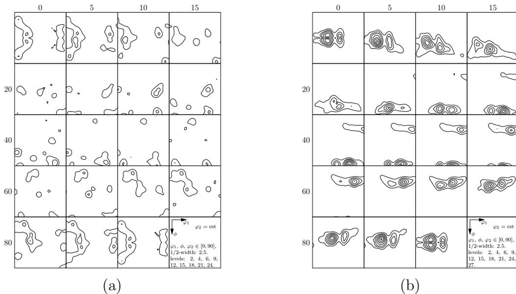
**Fig. V.1** : Macrotextures de l'échantillon B à (a)  $\varepsilon = 0$  et (b)  $\varepsilon = 1.2$ , construites en considérant toutes les mesures d'orientation des 176 grains suivis au cours de la déformation.
