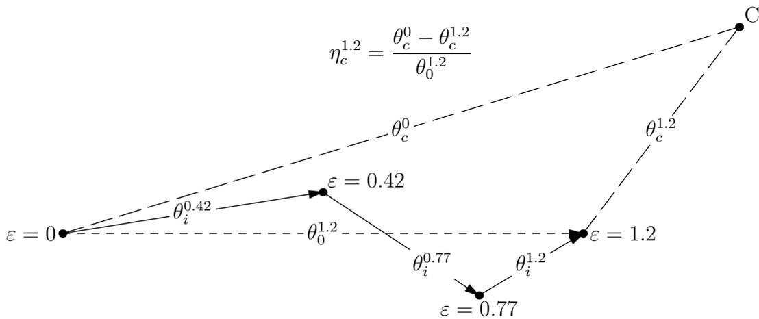
**Fig. V.34** : Définition du rendement de la convergence  $\eta_c$ .
