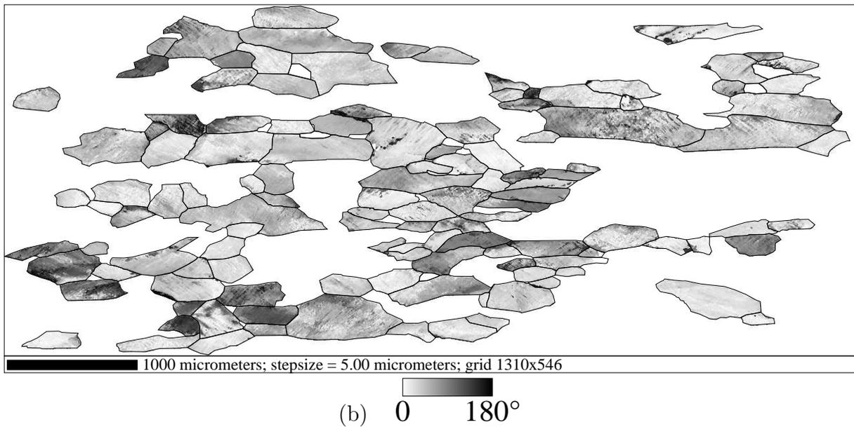
**Fig. VI.11** : Corrélation des axes de rotation incrémentaux entre expérience et simulation. (a) Distributions des angles  $\alpha$  entre axes de rotations successifs, (b) cartographies de  $\alpha$  à  $\epsilon = 0.42$  (les traits représentent les contours des grains considérés ( $\mathcal{G}_{u+}$ )).
