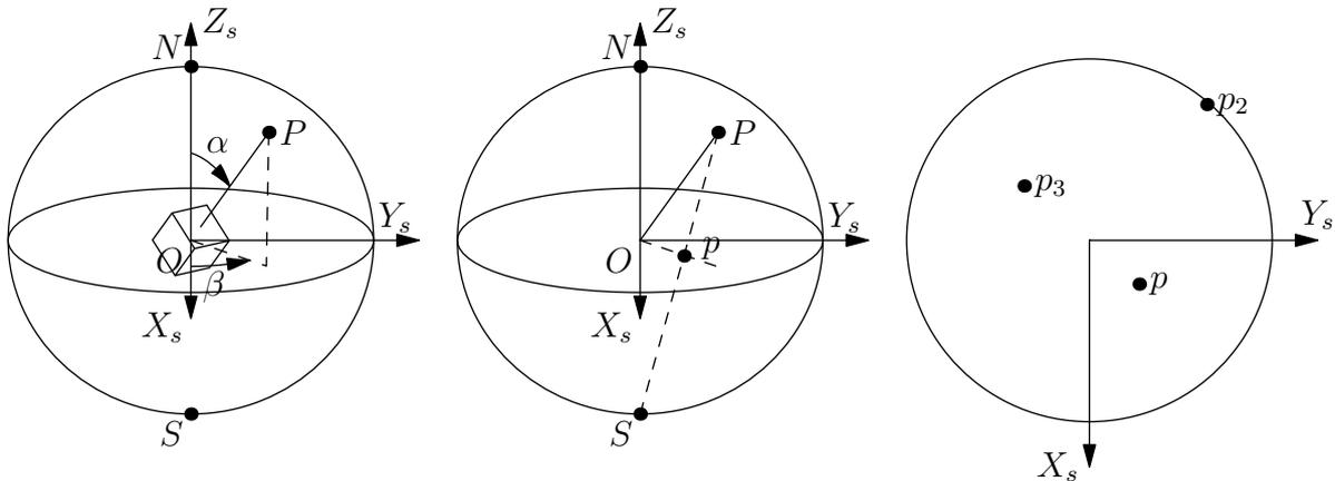
**Fig. A.2** : Description d'une orientation par une figure de pôles : principe de construction d'une figure de pôles  $\{100\}$  : (Gauche) Intersection du pôle avec la sphère de référence. (Milieu) Projection stéréographique sur le plan équatorial. (Droite) Figure de pôles  $\{100\}$ .
