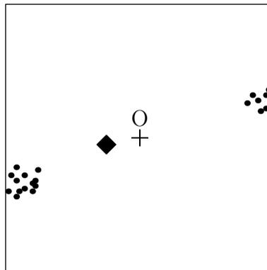
**Fig. III.10** : Calcul d'une orientation moyenne. Illustration schématique 2D de l'effet Umklapp. Le carré représente la zone fondamentale de l'espace des orientations, le nuage de points la distribution d'orientations soumise à l'effet Umklapp, et le losange l'orientation moyenne qui serait alors obtenue.
