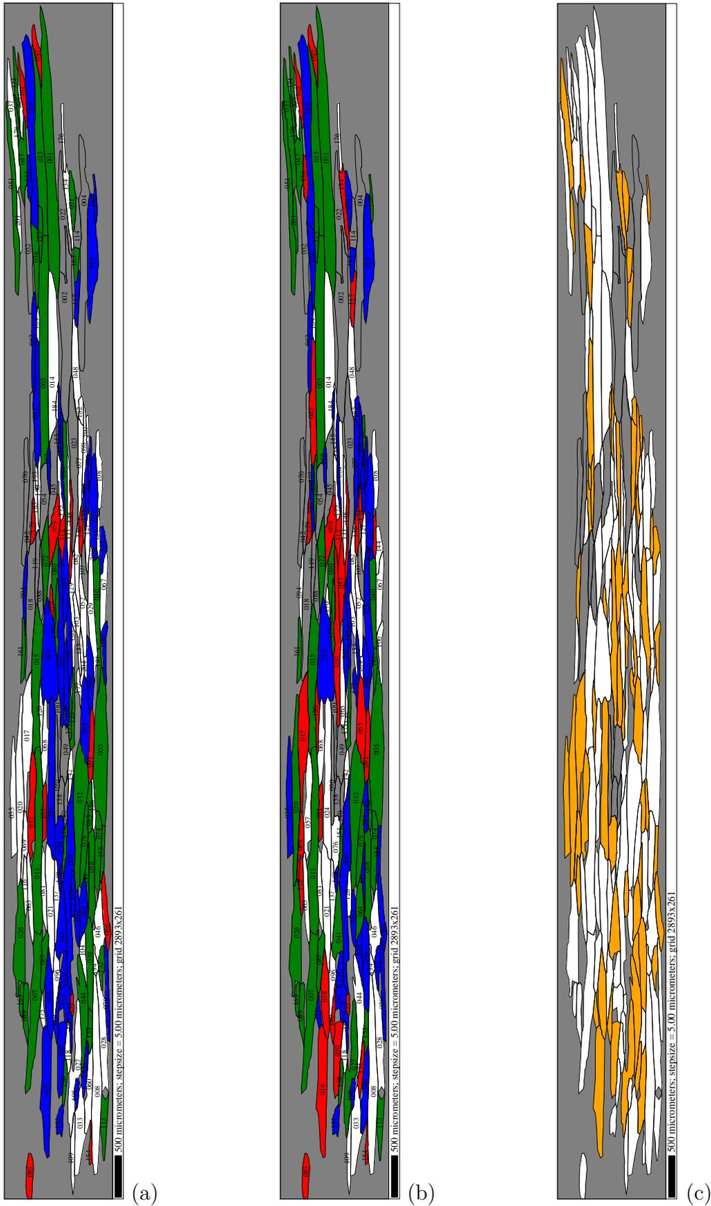
**Fig. VI.17** : Comparaison des composantes finales des grains : (a) expérience et (b) Taylor. Chaque grain est représenté par son orientation moyenne. Code de couleur : Cuivre en rouge, Laiton en vert, S en bleu et Autres en blanc. Les grains pour lesquels il y a un désaccord sont représentés en orange sur la figure (c).
