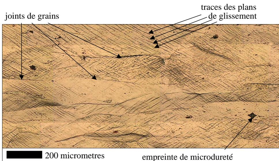
**Fig. IV.3** : Observation dans le plan de la surface interne ; une partie seulement de la surface est illustrée. Noter les traces des plans de glissement, les traces des joints de grains, et l'absence de traces de glissement entre les deux demi-échantillons.
