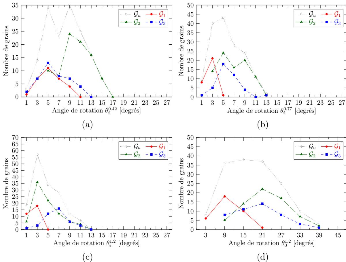
**Fig. VI.18** : Angles de rotation des grains des ensembles  $\mathcal{G}_i$ , pour le modèle de Taylor. (a-c) Incrémentaux, (d) par rapport à l'état initial, à  $\varepsilon = 1.2$ .
