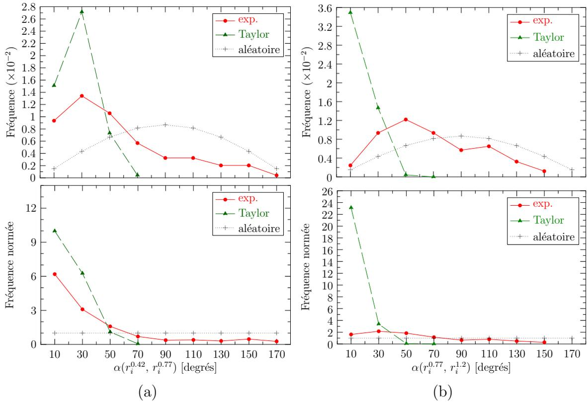
**Fig. VI.8 :** Chemins de rotation expérimentaux et simulés : corrélations entre les axes de rotation aux incréments de déformation successifs. (a) Premier et deuxième incréments, (b) deuxième et troisième incréments.
