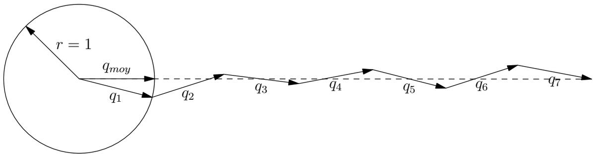
**Fig. III.9** : Calcul d'une orientation moyenne. Illustration, pour le cas 2D, de la sommation des vecteurs et de la normalisation, d'après [78].  $q_1, \dots, q_7$  sont les orientations à moyenner ;  $q_{moy}$  est l'orientation moyenne.
