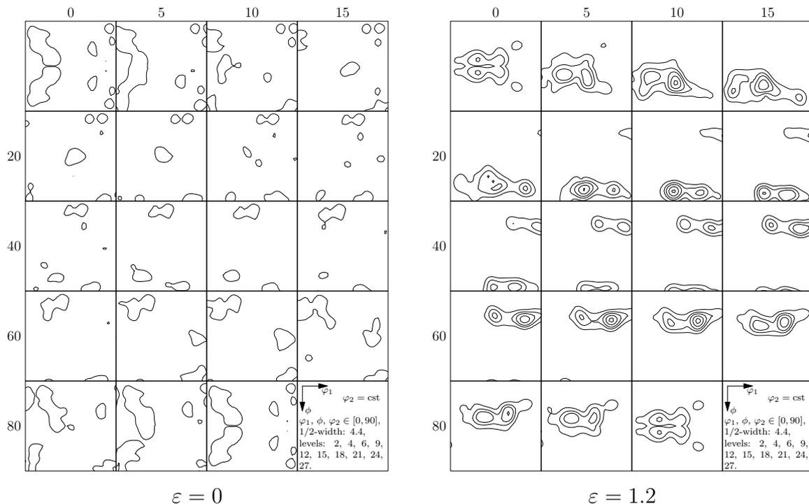
**Fig. V.26** : Macrotextures à  $\varepsilon = 0$  et  $\varepsilon = 1.2$  obtenues à partir des grains appartenant à  $\mathcal{G}_u$  en ne considérant qu'une orientation par grain. La dispersion, commune à tous les grains, est une distribution gaussienne de largeur égale à  $4.4^\circ$ .
