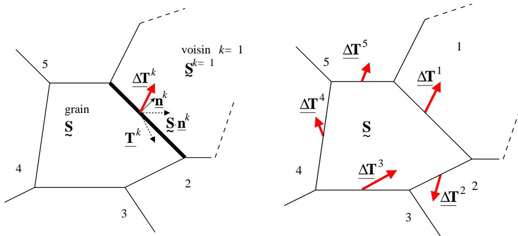
**Fig. VI.1** : Conditions mécaniques obtenues par application du modèle de Taylor : continuité du vecteur déplacement et discontinuité du vecteur contrainte aux joints de grains ( $\underline{\Delta T}^k$ ).
