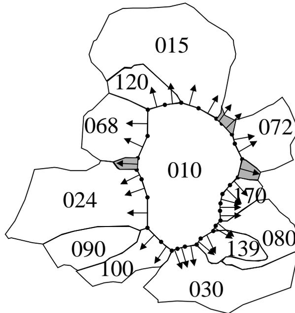
**Fig. VI.3** : Modélisation de la microstructure réelle. Illustration pour le grain 010 et ses voisins à  $\varepsilon = 0$ . Les joints de grains, courbes en réalité, sont discrétisés en segments rectilignes. Les grains grisés sont des voisins d'orientations inconnues.
