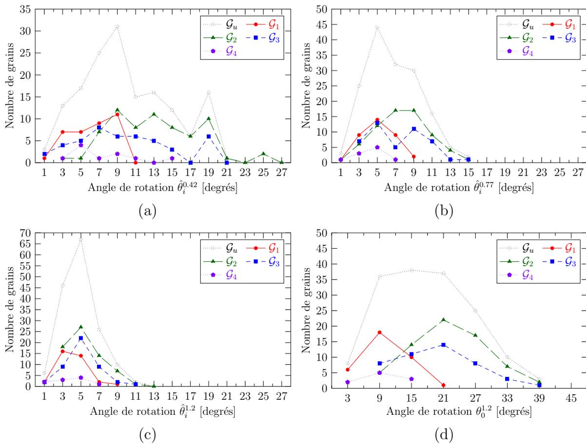
**Fig. V.29** : Angles de rotation des grains des ensembles  $\mathcal{G}_i$ , (a-c) incrémentaux et (d) par rapport à l'état initial, à  $\varepsilon = 1.2$ .
