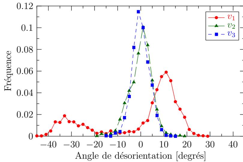
**Fig. V.18** : Caractérisation de la fragmentation : exemple du grain 002 à  $\varepsilon = 0.42$ . Distributions des angles de désorientation par rapport aux axes principaux d'anisotropie ( $v_1$ ,  $v_2$  et  $v_3$ ). La distribution associée à  $v_1$  est bimodale, ce qui signifie que le grain est fragmenté.
