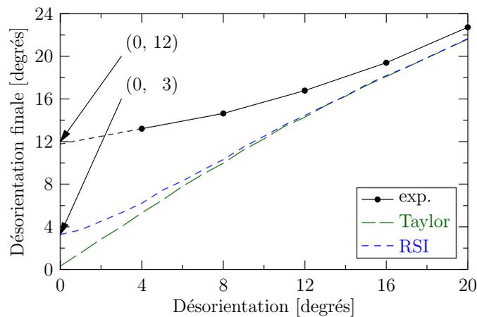
**Fig. VI.14** : Variabilité des orientations finales ( $\epsilon = 1.2$ ), dans l'expérience et pour les modèles de Taylor et RSI. Le graphique est limité aux désorientations entre paires de grains inférieures à  $20^\circ$ .
