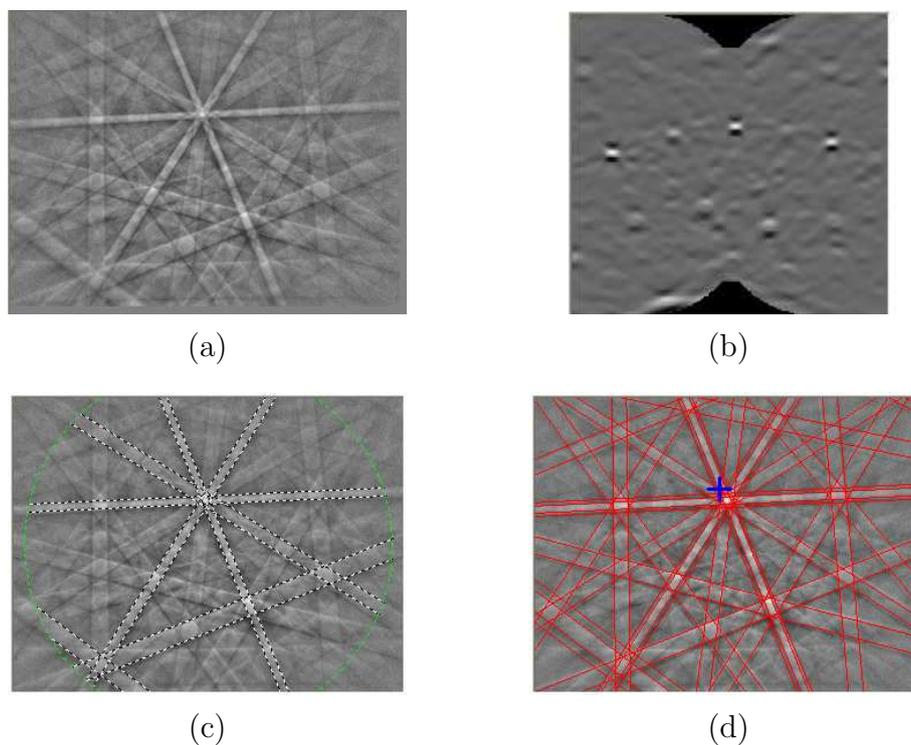
**Fig. II.9** : Méthode EBSD : détermination d’une orientation. (a) Diagramme de Kikuchi, (b) Transformée de Hough, (c) Détection des bandes de Kikuchi – le cercle vert contient la portion du diagramme de Kikuchi utilisée, (d) Indexation de l’orientation.
