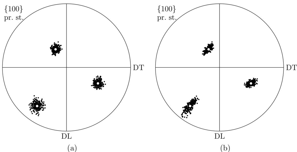
**Fig. III.8** : Dispersions locales d'orientations : exemple de dispersions simulées (a) isotrope et (b) anisotrope. Les points noirs représentent les orientations, et les points blancs l'orientation moyenne =  $(123) [63\bar{4}]$ . Les deux dispersions ont même désorientation moyenne ( $5.8^\circ$ ).
