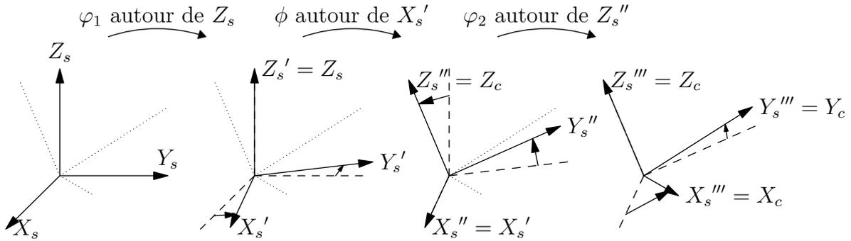
**Fig. A.4** : Description d'une orientation par les angles d'Euler définis selon la convention de Bunge  $(\varphi_1, \phi, \varphi_2)$ . Ligne pleine : SdC courant, tirets : SdC précédent, points : SdC final.
