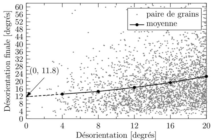
**Fig. V.25** : Variabilité des orientations finales ( $\varepsilon = 1.2$ ). Se référer à la figure V.23 pour la définition des nuages de points, et lignes. Le graphique est limité aux désorientations entre paires de grains inférieures à  $20^\circ$ .
