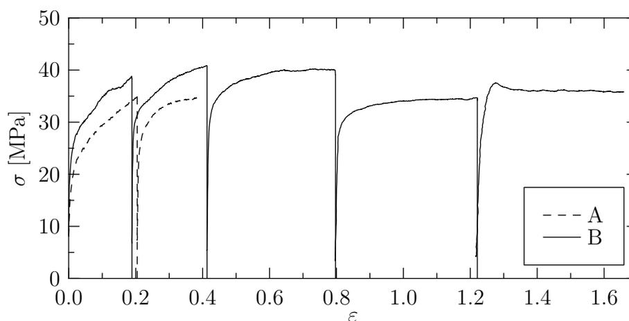
Fig. IV.1 : Courbes contrainte-déformation des échantillons A et B.
