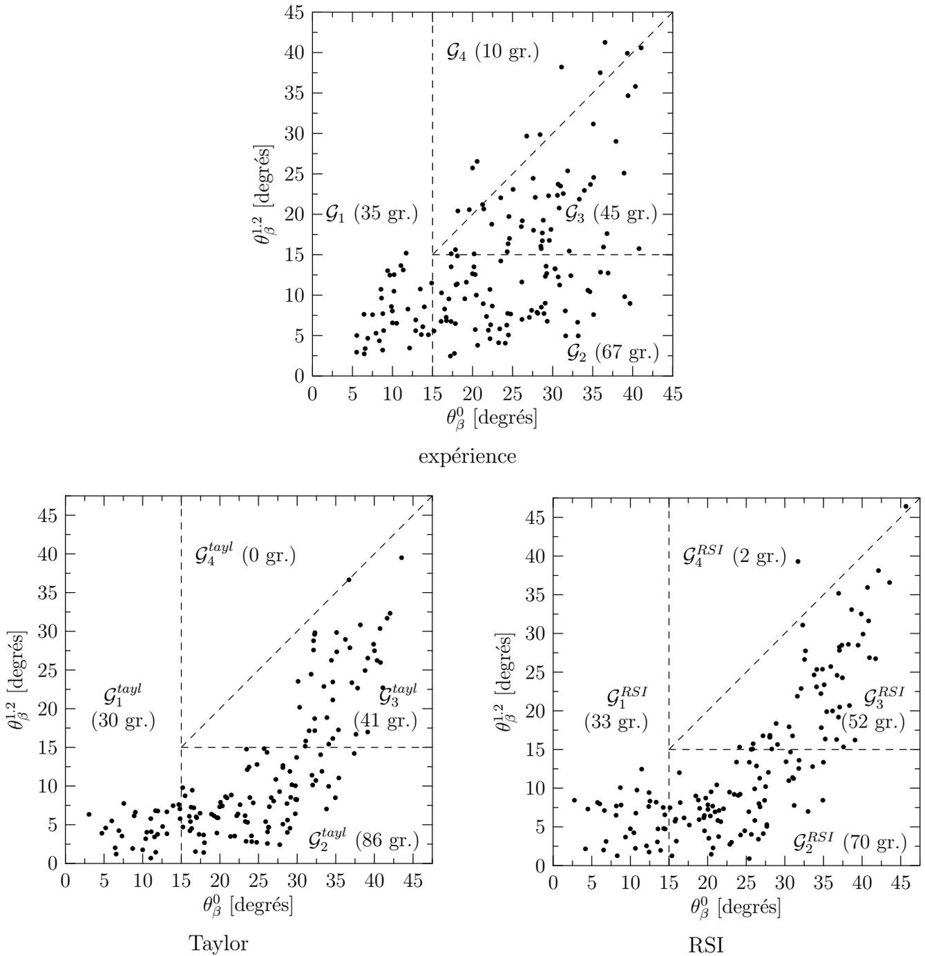
**Fig. VI.15** : Désorientations par rapport à la fibre  $\beta$  à  $\varepsilon = 0$  et  $1.2$  pour les modèles de Taylor et RSI (le cas expérimental est rappelé). Corrélations et classification des grains résultante.
