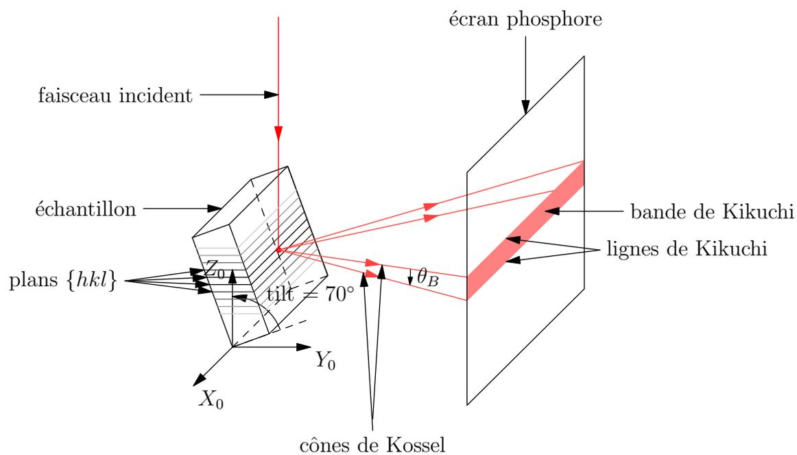
**Fig. II.8** : Méthode EBSD – formation d’un diagramme de Kikuchi.
