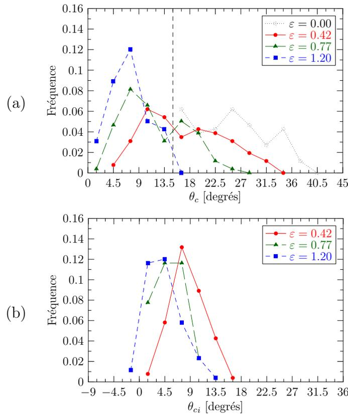
**Fig. VI.23** : Évolution des désorientations par rapport à la composante finale en fonction de la déformation (ensemble  $\mathcal{G}_2$ ). (a) Désorientations et (b) incréments de désorientation (voir le corps du texte pour la définition de  $\theta_{ci}$ ). Modèle de Taylor.
