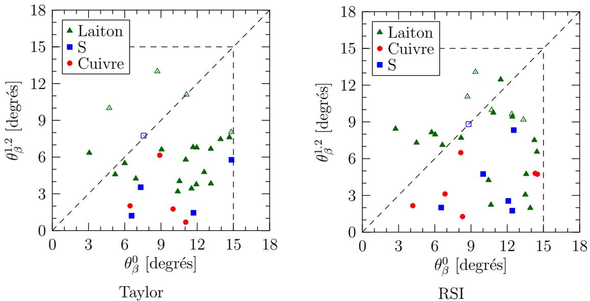
**Fig. VI.16** : Stabilité des orientations initialement dans la fibre  $\beta$  : désorientations par rapport à la composante initiale à  $\varepsilon = 0$  et  $\varepsilon = 1.2$ . Les symboles ouverts représentent le cas de grains ayant atteint une autre composante. Cas des modèles de Taylor et RSI.
