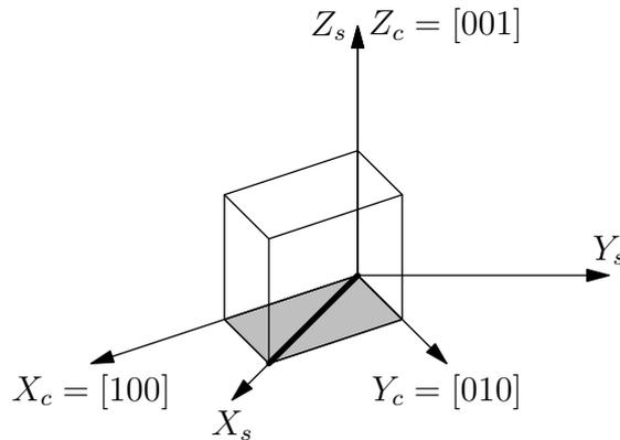
**Fig. A.1** : Description d'une orientation par les indices de Miller. Exemple de l'orientation  $(001)[110]$ . Le plan grisé est de normale  $(hkl) = (001)$  et le trait épais de direction  $[uvw] = [110]$ .
