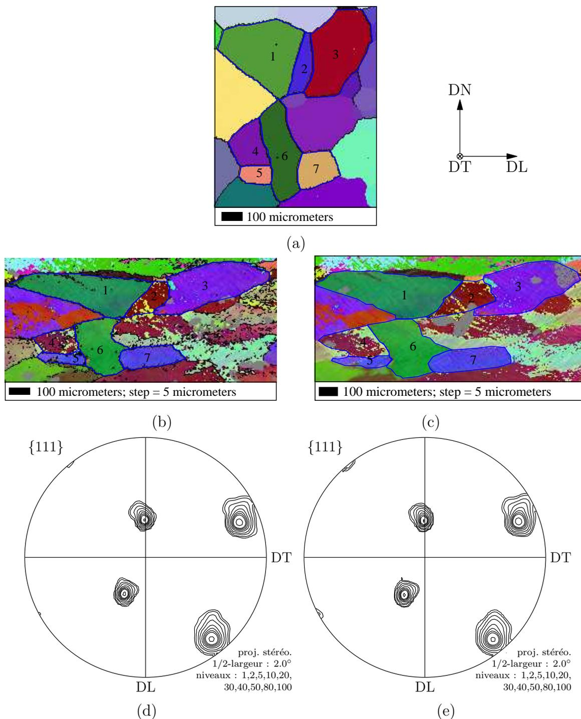
**Fig. IV.8** : Influence de la surface interne sur les microtextures (échantillon test). Les grains étudiés sont numérotés et délimités en bleu. (a)  $\varepsilon = 0$ , (b)  $\varepsilon = 0.5$  sur la surface interne, (c) idem, mais en sous-surface ( $-20 \mu\text{m}$ ). Cartographies selon vecteur de Rodrigues. (d) Orientations du grain 1 en surface, (e) idem, mais en sous-surface.
