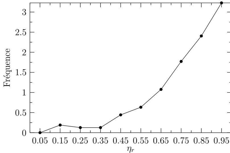
**Fig. V.11** : Rendements des rotations totales des grains (c.-à-d. calculés à  $\epsilon = 1.2$ ),  $\eta_r = \theta_0/\theta_{cum}$ , où  $\theta_0$  représente la rotation par rapport à l'état initial et  $\theta_{cum}$  la rotation cumulée (= somme des rotations incrémentales).
