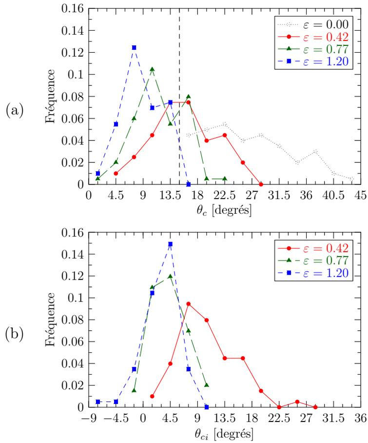
**Fig. V.35** : Évolution des désorientations par rapport à la composante finale en fonction de la déformation (ensemble  $\mathcal{G}_2$ ). (a) Désorientations et (b) incréments de désorientation (voir le corps du texte pour la définition de  $\theta_{ci}$ ).
