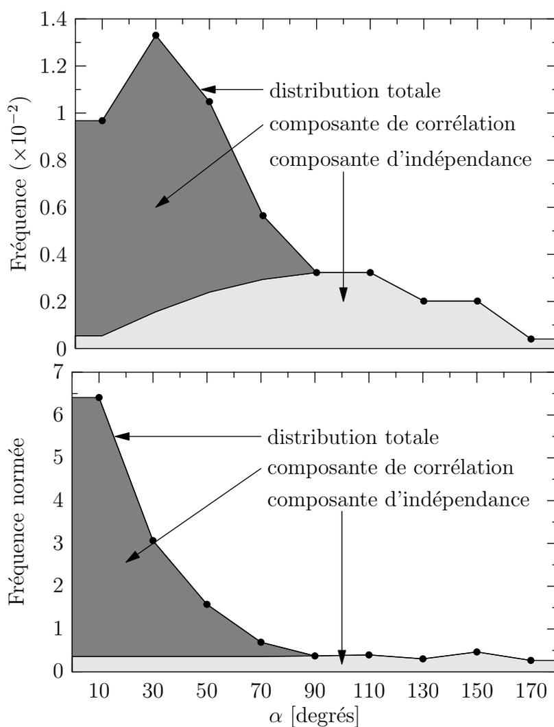
**Fig. B.3** : Rotations moyennes aux incréments de déformation successifs : décomposition schématique des distributions de  $\alpha (r_i^{0.42}, r_i^{0.77})$  en une composante d'indépendance et une composante de corrélation. (haut) Distributions standards et (bas) normalisées par rapport à l'« aléatoire ».  $\alpha (r_i^{0.42}, r_i^{0.77})$  représente l'angle entre les deux axes.
