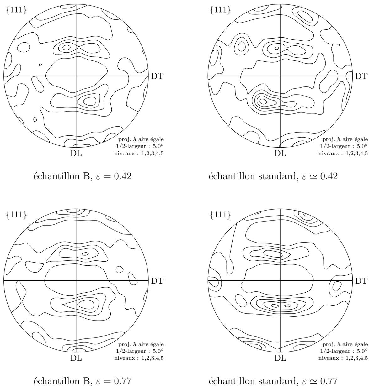
**Fig. IV.7 :** Influence de la surface interne sur les macrotextures. Comparaison des textures sur la surface interne d'un échantillon tranché à celles d'un échantillon standard, aux déformations de 0.42 et 0.77.
