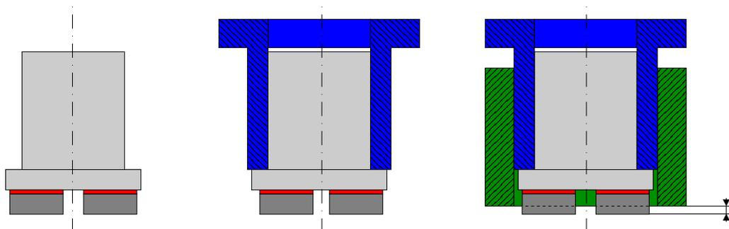
**Fig. II.4** : Élaboration d'un échantillon tranché : schéma du porte-échantillon micrométrique. Gauche : plot (gris clair), sur lequel sont collés deux échantillons (gris foncé, colle en rouge) ; centre : ajout du support (bleu) ; droite : ajout de la vis micrométrique (vert). Les éléments d'assemblages ne sont pas représentés. L'épaisseur de matériau abrasée par polissage est indiquée par la double flèche.
