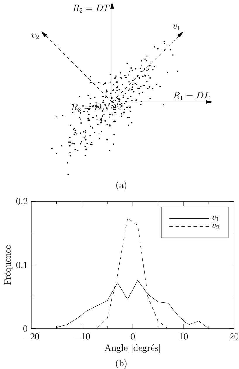
**Fig. III.12** : Propriétés d'anisotropie d'une dispersion d'orientations. (a) Représentation dans le plan  $R_1-R_2$  de la dispersion et de ses axes principaux. Les angles principaux sont ( $\theta_1 \simeq 6^\circ, \theta_2 = \theta_3 \simeq 2^\circ$ ). (b) Distributions angulaires correspondantes selon les axes  $v_1$  et  $v_2$ .
