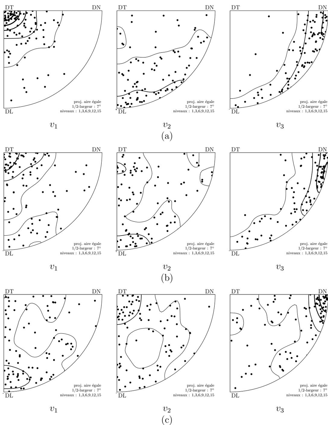
**Fig. V.16** : Dispersions intragranulaires : directions principales d'anisotropie à (a)  $\varepsilon = 0.42$ , (b)  $\varepsilon = 0.77$  et (c)  $\varepsilon = 1.2$ . Chaque point représente un grain. Les lignes de contour permettent de mettre en évidence les densités de répartition. Voir le corps du texte pour les définitions de  $v_1$ ,  $v_2$  et  $v_3$ .
