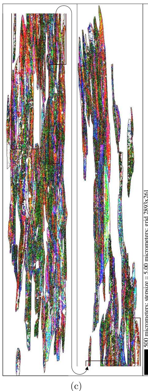
**Fig. V.16** : Champs de désorientations intragranulaires à (a)  $\varepsilon = 0.42$ , (b)  $\varepsilon = 0.77$  et (c)  $\varepsilon = 1.2$  (pour chaque grain, par rapport à son orientation moyenne). Représentation par vecteur de Rodrigues :  $(R,G,B) = a (|R_1|, |R_2|, |R_3|)$ , avec  $a = 32$ . Les zones encadrées sont les zones d'intérêt.
