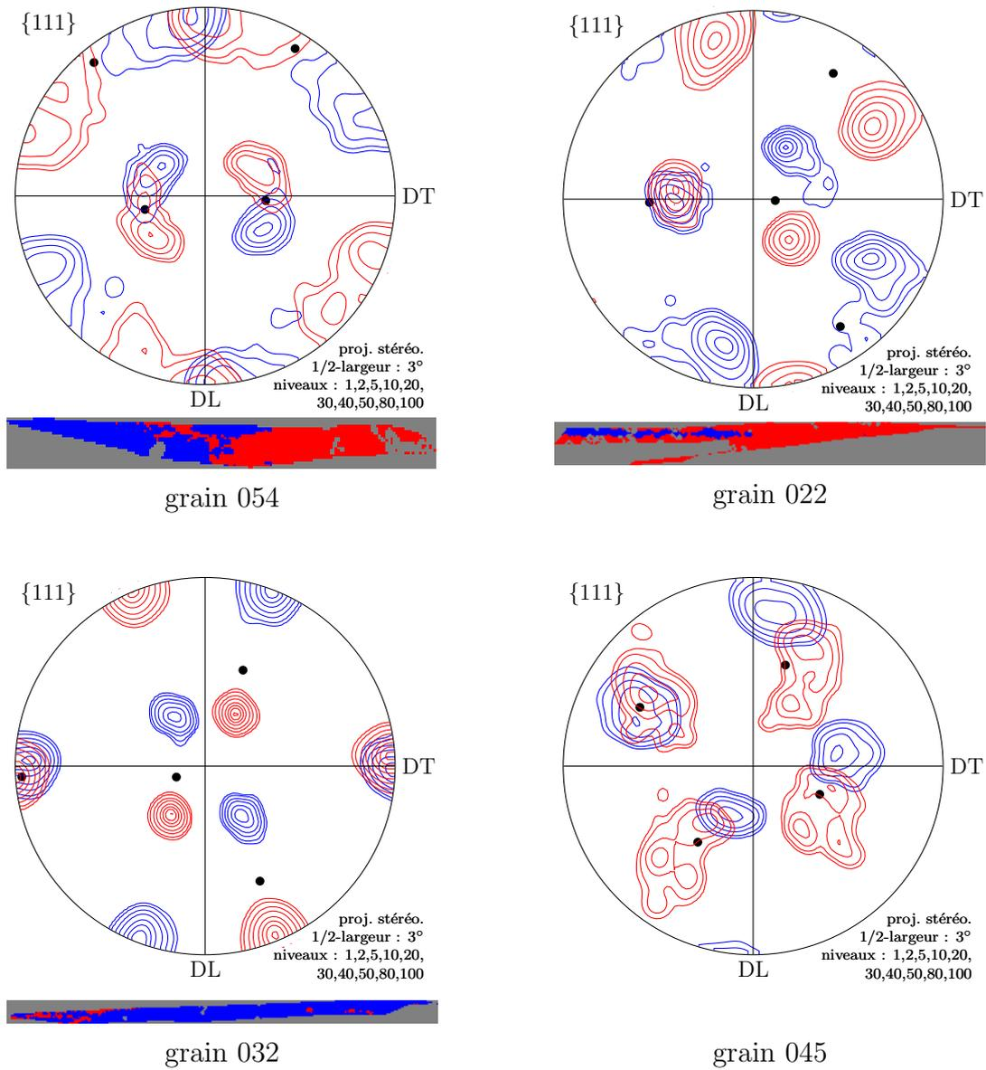
**Fig. V.22** : Fragmentation : exemples des grains 054, 022 et 032 et 045. Pour chaque grain, les deux modes sont représentés en rouge et bleu sur la figure de pôles et sur la microstructure. Pour le grain 045, la microstructure ne peut être construite, car les modes sont relativement chevauchés.
