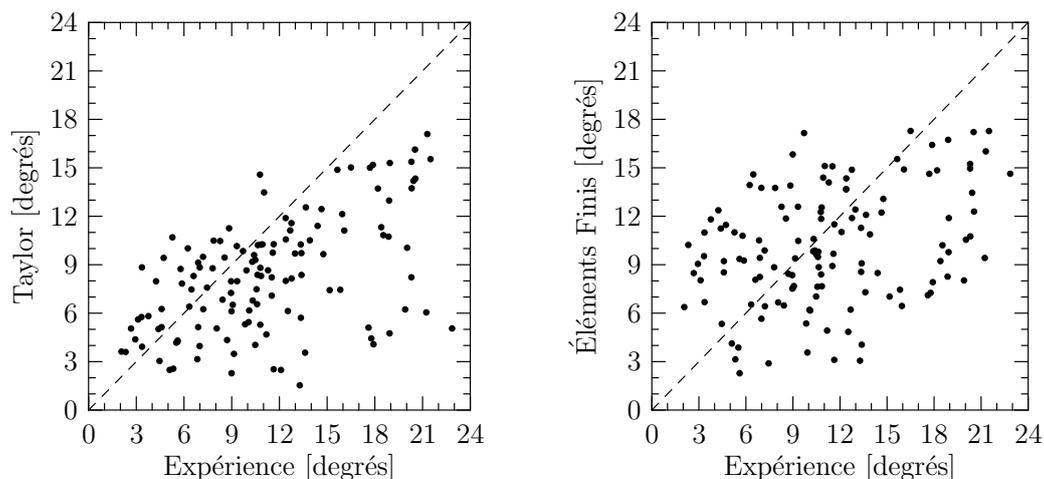
**Fig. D.2** : Comparaison des angles de rotation expérimentaux à ceux prédits par les modèles de Taylor et EF. (a) modèle de Taylor, (b) modèle EF.
