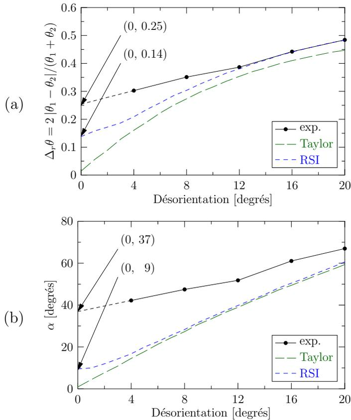
**Fig. VI.13** : Variabilité des rotations au premier incrément de déformation : (a) angles de rotation et (b) axes de rotation, dans l'expérience et pour les modèles de Taylor et RSI (voir le corps du texte pour les définitions des paramètres de variabilité  $\Delta_r \theta$  et  $\alpha$ , et de la désorientation). Les graphiques sont limités aux désorientations entre paires de grains inférieures à  $20^\circ$ .
