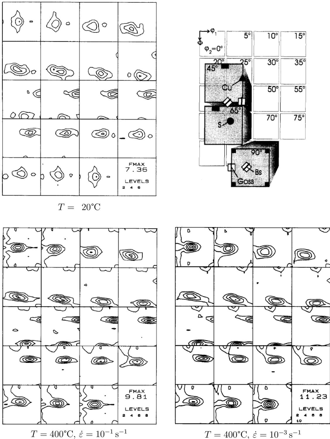
**Fig. I.2** : Textures de compression plane expérimentales d'un alliage d'aluminium Al-1%Mn-1%Mg à  $\epsilon = 1.5$ , d'après [49]. Influence de la température et de la vitesse de déformation. La légende indique les positions des principales composantes de texture.
