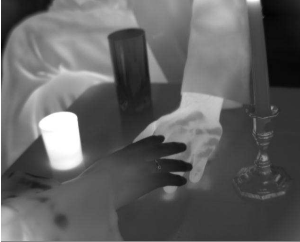
FIGURE 5.2: Extrait du film Infrablues. Réalisé à partir d'une caméra QWIP 8\ \mu\text{m} . Le verre rempli d'un liquide chaud apparaît en blanc sur la figure alors que celui rempli d'un liquide froid apparaît en noir.
