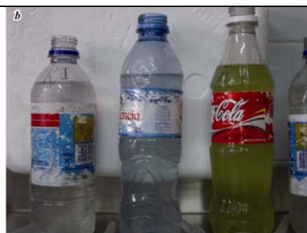
b : Couleur de l'eau dans le río Mendoza RI (à gauche) : eau transparente RII (au milieu) : eau transparente malgré le bleu de la bouteille RIII (à droite) : eau de couleur verte en aval des rejets de la station d'épuration de Paramillo.
