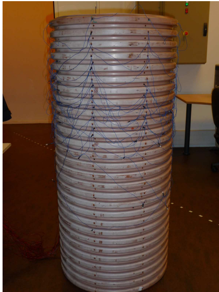
FIG. 2.15 – Photo de la mire d'étalonnage
