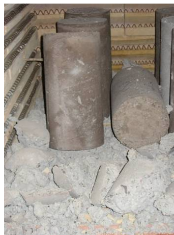
Figure 6 : à gauche, état d'une piste de décollage en béton à la suite de l'allumage du réacteur d'un avion de chasse. A droite, explosion d'éprouvettes cylindriques chauffées lentement dans un four électrique (Bohn M., Gianaria A. et al. 2008).
