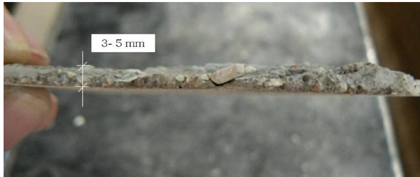
Figure 177 : cliché d'une écaille éjectée durant la première phase d'instabilité thermique durant les essais réalisés sur dalles conservées dans l'eau.
