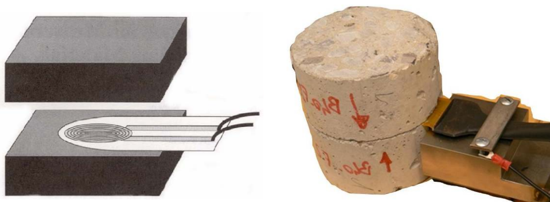
Figure 110 : principe de la mesure des propriétés thermiques selon la méthode "TPS" reposant sur la mise en place d'un disque fin entre deux éprouvettes du matériau à tester. A droite, photo de la mesure avec deux éprouvettes de béton.
