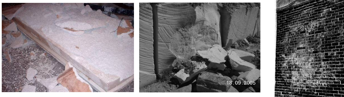
Figure 7 : instabilité thermique d'autres matériaux (de gauche à droite) : produits réfractaires durant la phase de séchage ( Meunier, Mindeguia et al. 2008 ), roche (grès) ( Smith and Pells 2008 ) et brique ( Davey and Ashton 1953 ).
