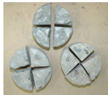
Figure 97 : éprouvettes utilisées pour la mesure de la porosité à l'eau : un quart de cylindre Ø 104 mm x h 50 mm.
