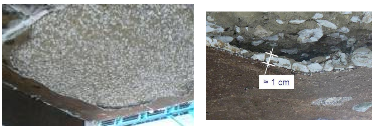
Figure 197 : à gauche, cliché de la face exposée d'une dalle après essai HCM et refroidissement. A droite, détail de la "croûte" de béton formée.
