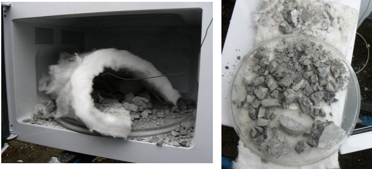
Figure 202 : clichés d'une éprouvette cylindrique après chauffage dans un four à micro-ondes. Mise en évidence de l'instabilité thermique du matériau.
