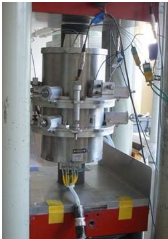
Figure 119 : vue du système expérimental complet de mesure des propriétés mécaniques à haute température des bétons.
