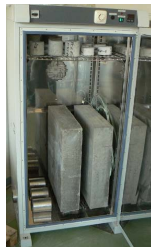
Figure 175 : pré séchage des dalles dans une étuve à 80 °C.
