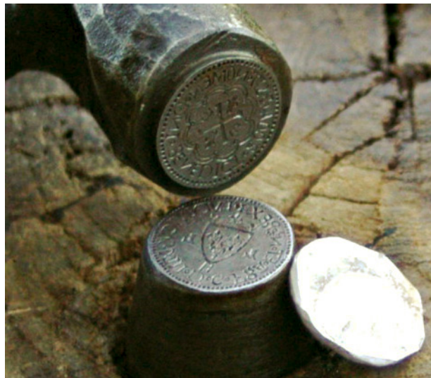
Figure 212 - Paire de coins monétaires utilisée lors des expérimentations.
