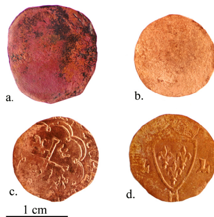
Figure 203 - Evolution de la couleur d'un monnayage de cuivre : a - Flan avant blanchiment (n° 08-10), b - Flan après blanchiment (n° 08-11), c - Monnaie frappée (n° 08-12), d - Monnaie oxydée (n° 08-13).
