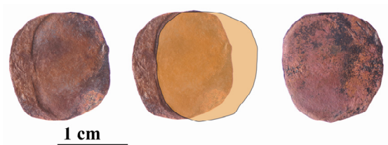
Figure 184 - Flans boués expérimentalement mettant en évidence un défaut potentiel de cette opération (n° 08-15).
