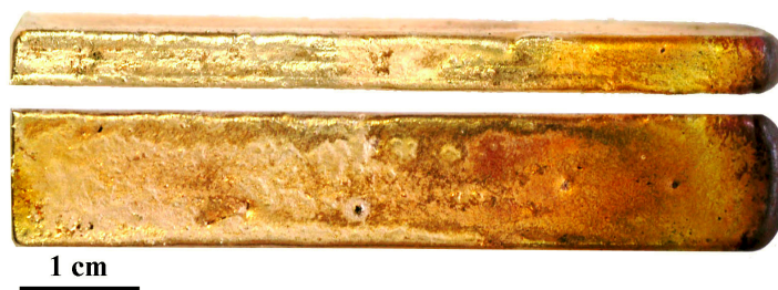
Figure 196 - lame coulée en lingotière (n° 05-30).
