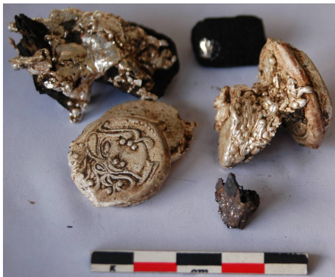
Figure 94 - Argent destiné à la fonte retrouvé dans le cendrier lors des expérimentations.
