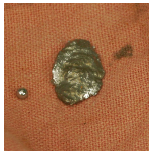
Figure 8 - Paillettes d'alliage dans l'amalgame.
