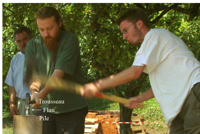
Figure 214 - Frappe expérimentale en binôme avec un coin emmanché.
