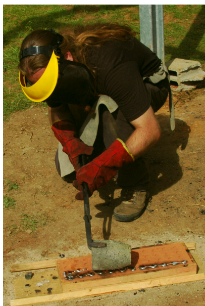
Figure 95 - Coulée à la pince avec un masque pour le visage, des gants et un tablier de cuir.
