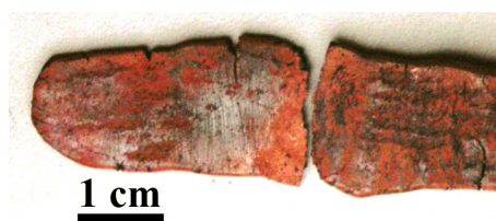
Figure 121 - Fissures et rupture d'un alliage cuivreux expérimental contenant 10 % mass de plomb.
