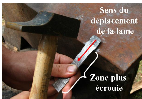
Figure 145 - Martelage sur l'arête de l'enclume.
