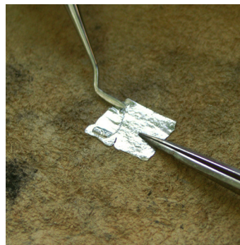
Figure 230 - Application facile de l'amalgame à la surface d'un échantillon de laiton préalablement recouvert de mercure (n° 06-11).
