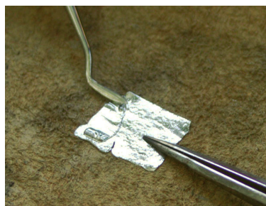
Figure 6 - Application de l'amalgame sur la surface préparée de l'échantillon.
