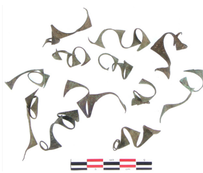
Figure 34 - Chutes correspondant à la découpe simultanée de quatre coins.
