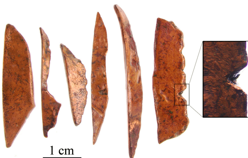
Figure 148 - Déchets de coupe retrouvés à La Rochelle et présentant des fissurations avec grossissement d'un détail (3009-16).
