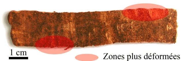
Figure 147 - Lame courbée par des martelages non homogènes (n° 05-02).
