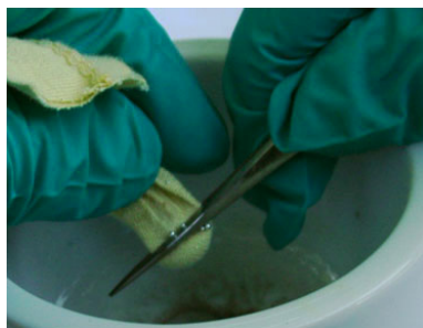
Figure 5 - Filtration de l'amalgame dans un tissu.
