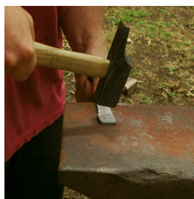
Figure 146 - Elargissement d'une lame avec l'arête d'un marteau.
