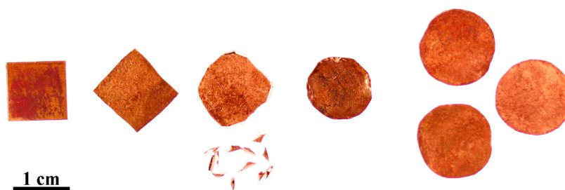
Figure 161 - Chaîne opératoire globale mise en œuvre lors de l'expérimentation (carreau, carreau battu, carreau ajusté avec 7,4 % de déchets, flan rechaussé, trois flans) 774 .
