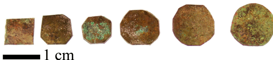
Figure 246 - Evolution morphologique au sein du corpus de carreaux et de flans du groupe A 1041 .
