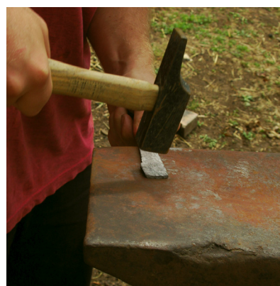
Figure 146 - Elargissement d'une lame avec l'arête d'un marteau.
