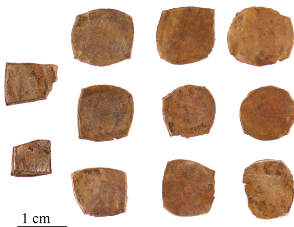
Figure 190 - Evolution de la morphologie des carreaux de bas billon au cours de leur mise en forme 837 .
