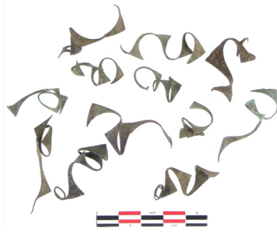
Figure 34 - Chutes correspondant à la découpe simultanée de quatre coins.
