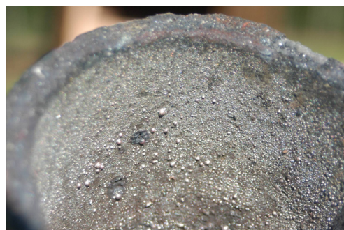
Figure 109 - Projections d'argent sur la surface interne des creusets (exp.).
