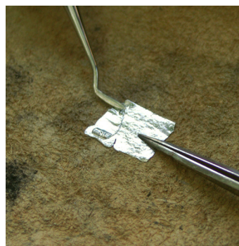
Figure 230 - Application facile de l'amalgame à la surface d'un échantillon de laiton préalablement recouvert de mercure (n° 06-11).
