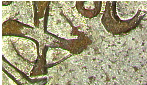
Figure 22 - Flan de cuivre argenté frappé sans avoir été bruni et détail de la surface (n° 06-31)
