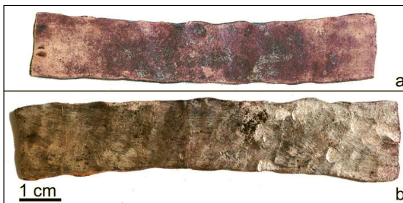
Figure 197 - lame après le troisième recuit (a. n° 05-36), lame après le dernier martelage (b. n° 05-37).
