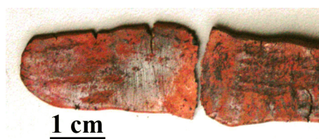
Figure 121 - Fissures et rupture d'un alliage cuivreux expérimental contenant 10 % mass de plomb.
