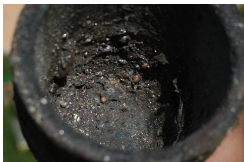
Figure 108 - Scories accumulées dans le creuset et métal à la base interne du bec de coulée (exp.).
