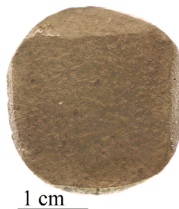
Figure 182 - Martelage en bordure d'un flan de quart d'écu (2010-03).
