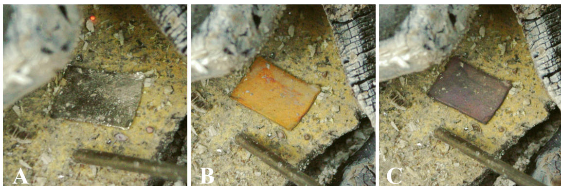
Figure 14 - Evolution de la couleur de l'argenture au cours de la chauffe.
