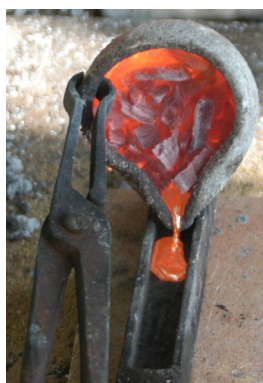
Figure 137 - Coulée en lingotière.
