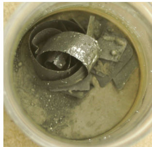
Figure 7 - Amalgamation avec l'alliage à base de laiton.
