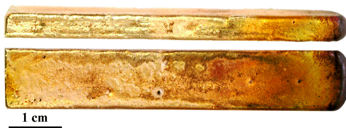
Figure 196 - lame coulée en lingotière (n° 05-30).
