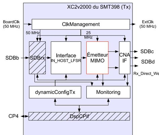
FIGURE 4.30 – Schéma de l'émetteur MIMO-MC-CDMA dégradé à une seule antenne d'émission.
