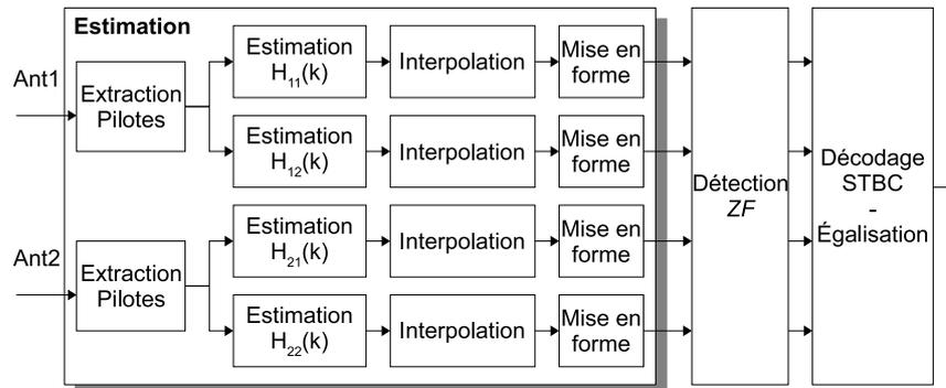
FIGURE 4.25 – Détail du bloc d'estimation dans l'opération d'estimation/égalisation.
