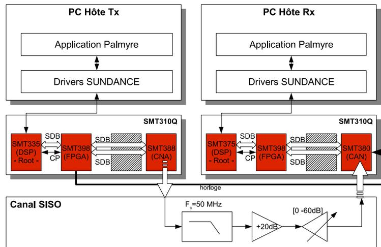
FIGURE 3.9 – Architecture globale de la plate-forme PALMYRE (SISO).
