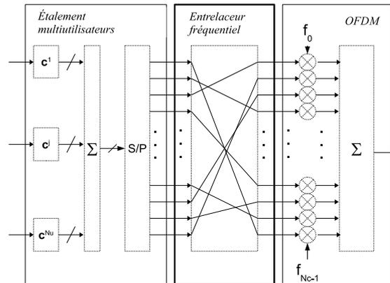
FIGURE 2.13 – Positionnement de l'entrelaceur dans le système MC-CDMA.
