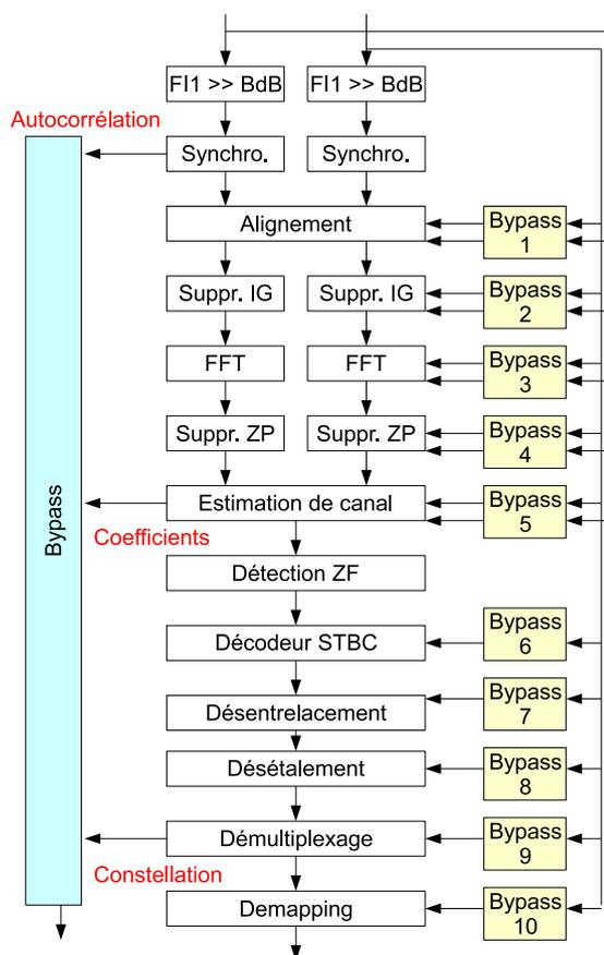
FIGURE 4.34 – Le bloc *RécepteurMIMO* implanté.
