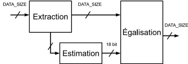
FIGURE 4.9 – L'estimation et l'égalisation en réception dans le cas SISO (DATA\_SIZE vaut 12 bit).
