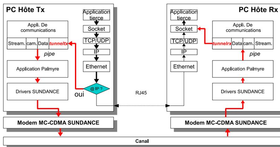
FIGURE 4.42 – L'application TUNNEL dans la plate-forme Palmyre.
