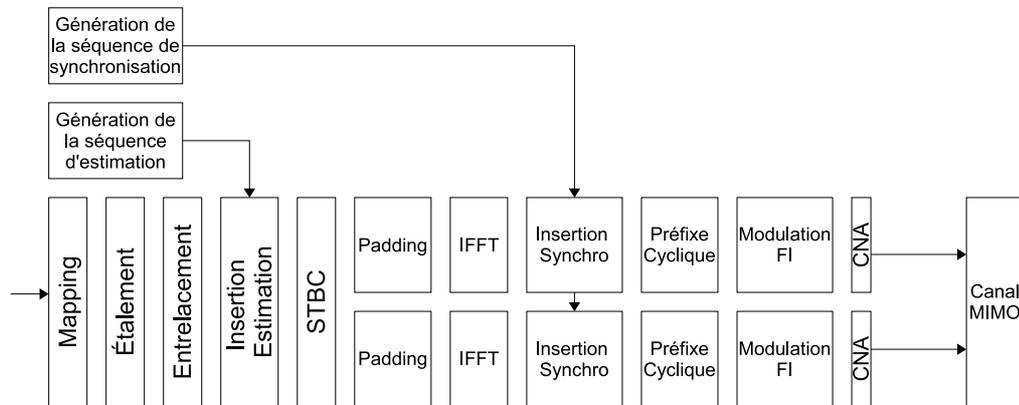
FIGURE 2.25 – Schéma de l'émetteur MIMO-MC-CDMA considéré.
