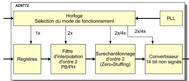
FIGURE 3.5 – Schéma du convertisseur AD9772 du module SMT388.
