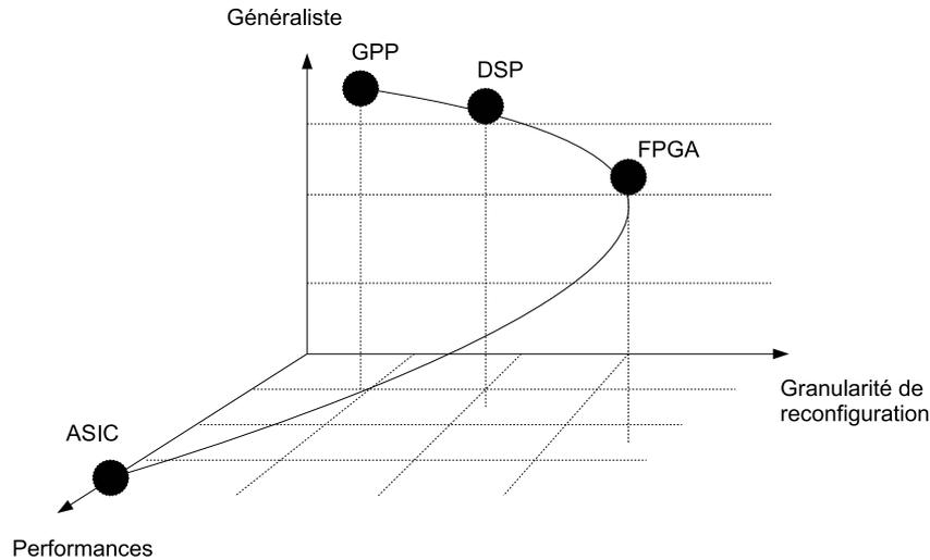
FIGURE 1.7 – Comparaison des processeurs issue de [11] selon leur degré de performance, de programmation, et de granularité.
