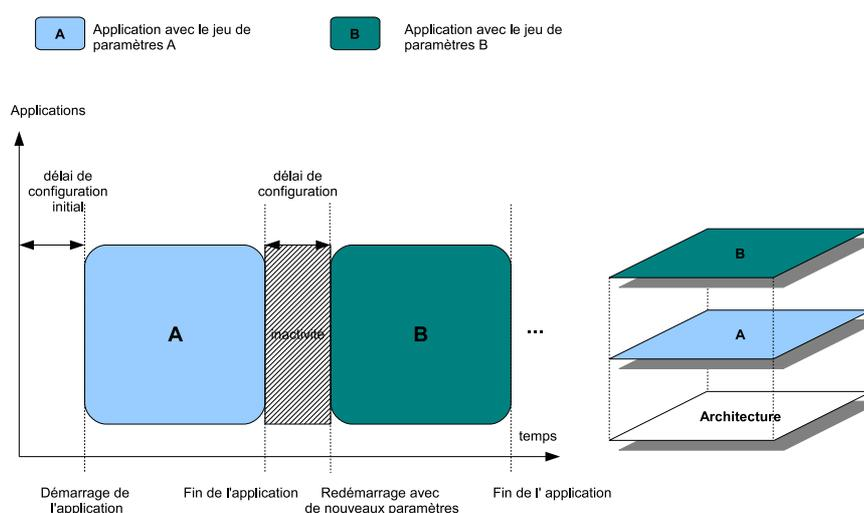
FIGURE 1.8 – La reconfiguration statique d’une architecture pour une application à plusieurs jeux de paramètres A et B.
