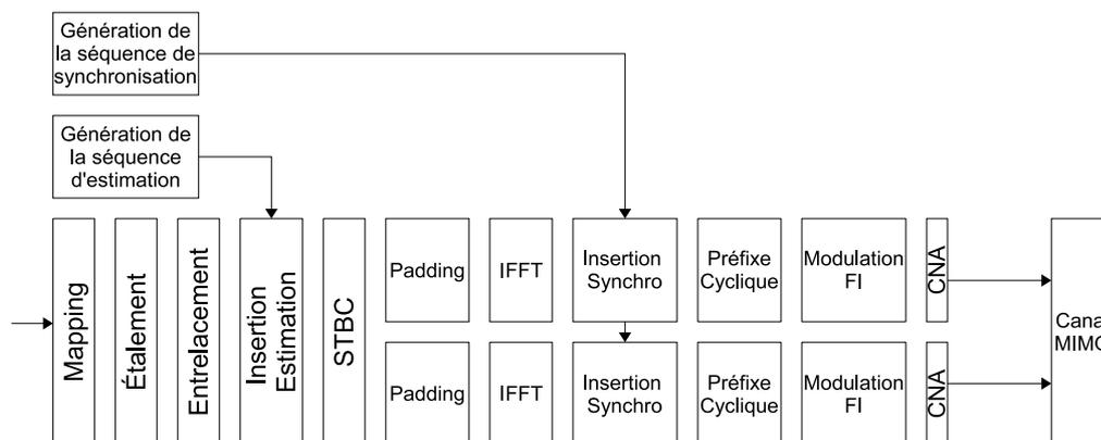
FIGURE 4.18 – Schéma classique MIMO-MC-CDMA à l'émission.
