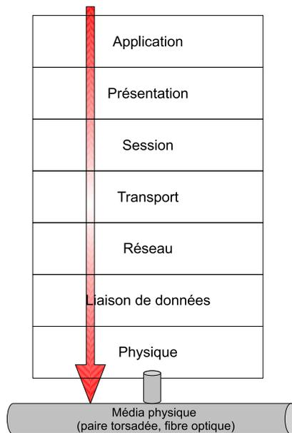
FIGURE 1.1 – Les 7 couches du modèle OSI.
