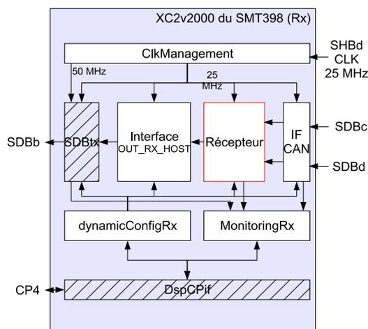
FIGURE 3.16 – Description du récepteur implanté sur le FPGA Virtex2.
