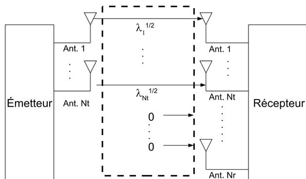
Modèle de canal MIMO équivalent (cas  $N_t < N_r$ )(b)  $N_t < N_r$
