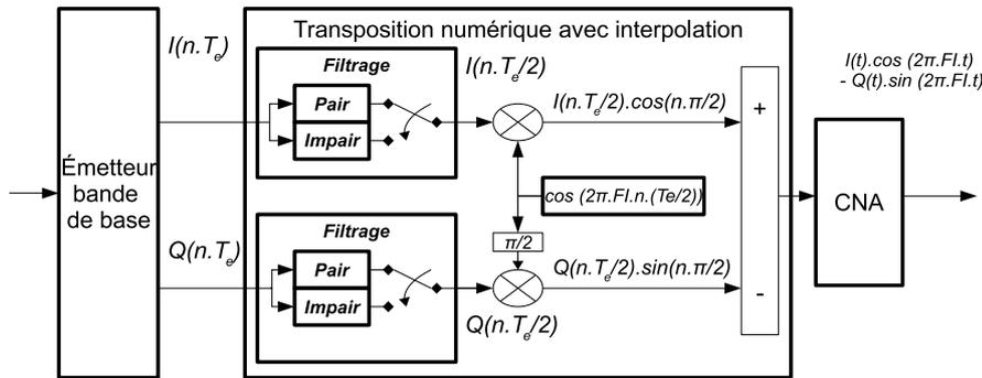
FIGURE 4.7 – Interpolateur à base de deux demi-filtres.
