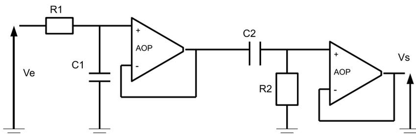
FIGURE 4.37 – Schéma du filtre passe-bande réalisé à partir d'un passe-bas et d'un passe-haut.
