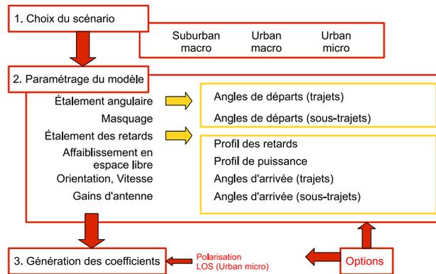
FIGURE 2.3 – Génération des coefficients du modèle SCM.
