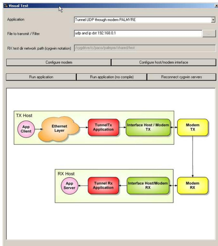
FIGURE 4.46 – Intégration de l'application TUNNEL dans VisualTest.
