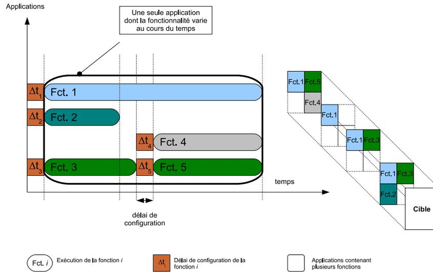
FIGURE 1.9 – La reconfiguration dynamique (ici partielle) d’une architecture.
