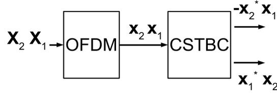
FIGURE 4.21 – Nouveau schéma OFDM-CSTBC optimisé ( $N_t = 2$ ).
