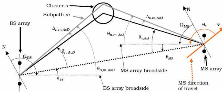
FIGURE 2.4 – Le canal MIMO SCM du 3GPP (figure issue de [18]).
