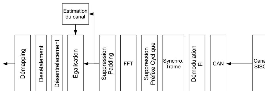
FIGURE 2.24 – Schéma du récepteur SISO-MC-CDMA.
