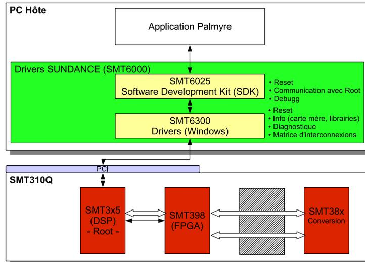
FIGURE 3.10 – Architecture logicielle de la plate-forme : des librairies SUNDANCE font l'interface entre application et matériel.
