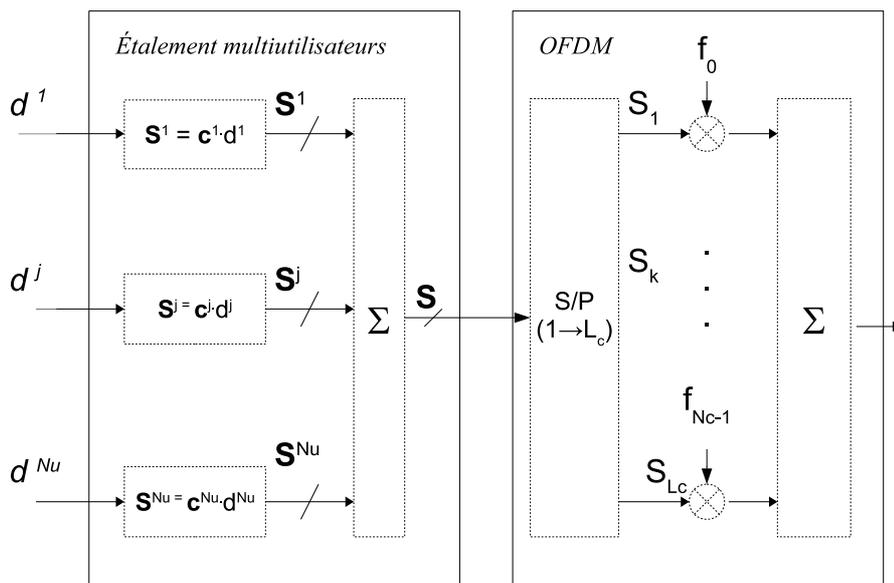
FIGURE 2.10 – Modulateur MC-CDMA et accès multiple (cas  $L_c = N_c$ ).
