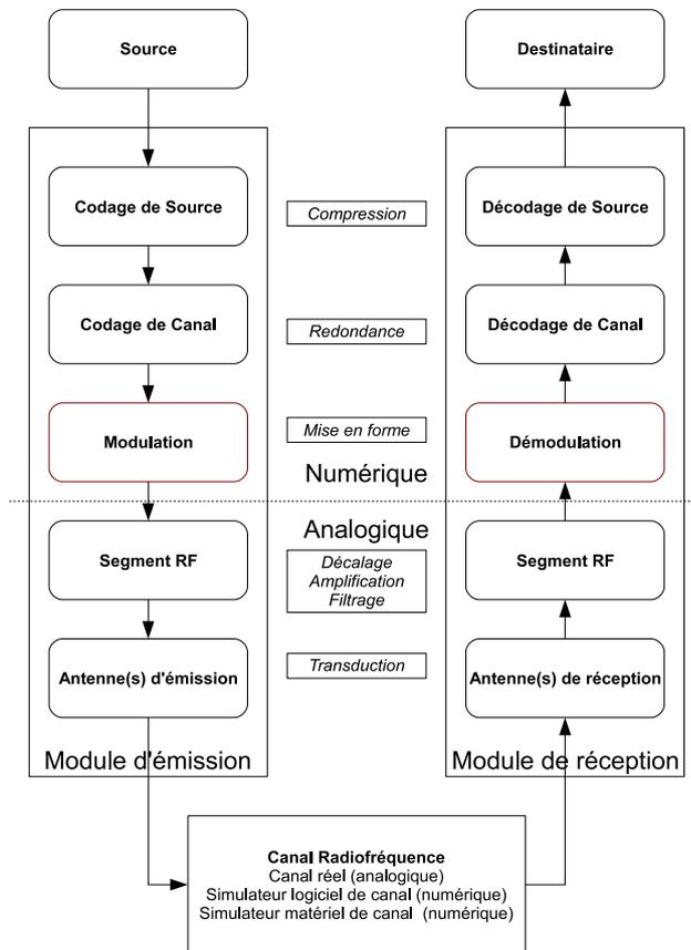
FIGURE 2.6 – Représentation d'une chaîne d'émission-réception. La partie modulation est l'objet de la contribution.
