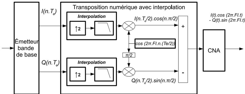
FIGURE 4.3 – L'interpolation évite la perte de données lors du passage en FI1.
