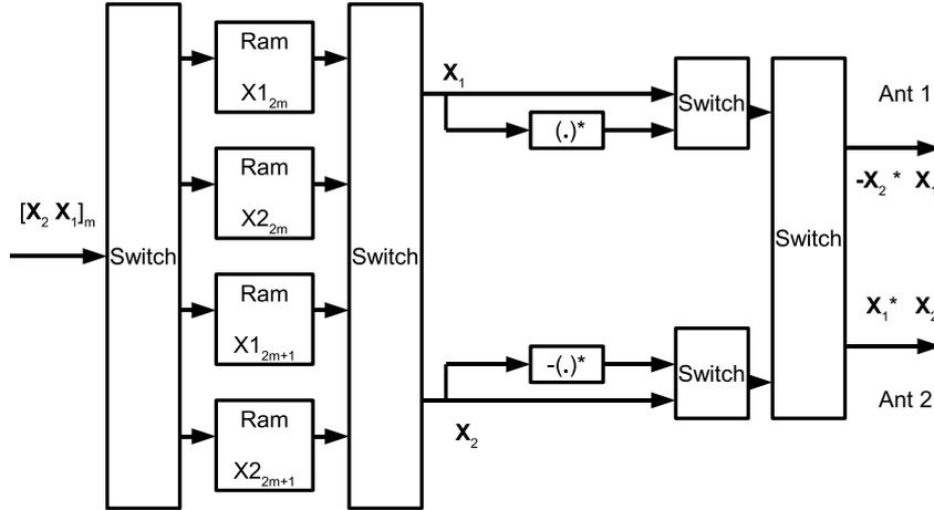
FIGURE 4.23 – Architecture du bloc CSTBC.
