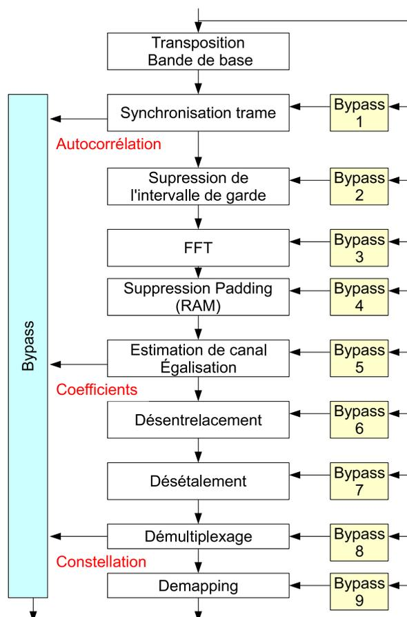
FIGURE 4.17 – Schéma final comprenant la synchronisation trame, côté réception.
