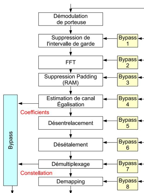
FIGURE 3.17 – Détail du bloc récepteur et description de la technique MC-CDMA implantée.
