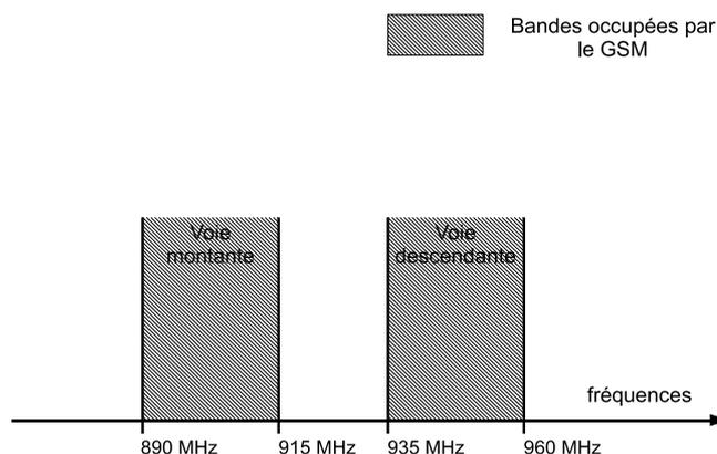
FIGURE 1.4 – L'occupation du spectre par le GSM.
