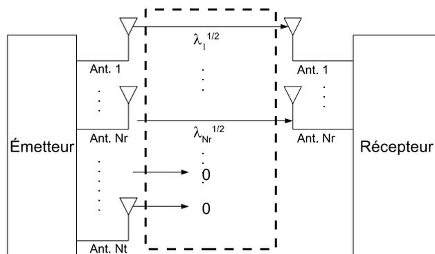
Modèle de canal MIMO équivalent (cas  $N_t > N_r$ )(c)  $N_t > N_r$
