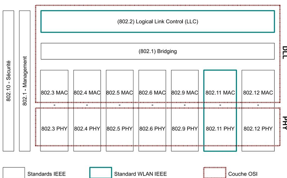
FIGURE 1.2 – Schéma des groupes de travail IEEE pour implémenter les couches basses du modèle OSI.
