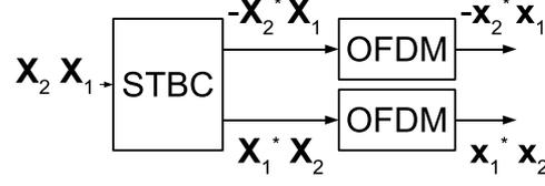
FIGURE 4.20 – Schéma STC-OFDM classique.
