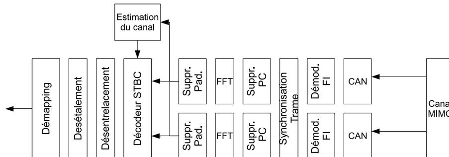
FIGURE 2.26 – Schéma du récepteur MIMO-MC-CDMA considéré.
