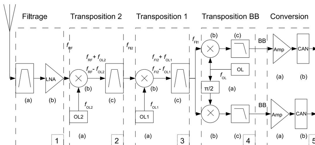
1a : le passe-bande isole le signal autour de RF
