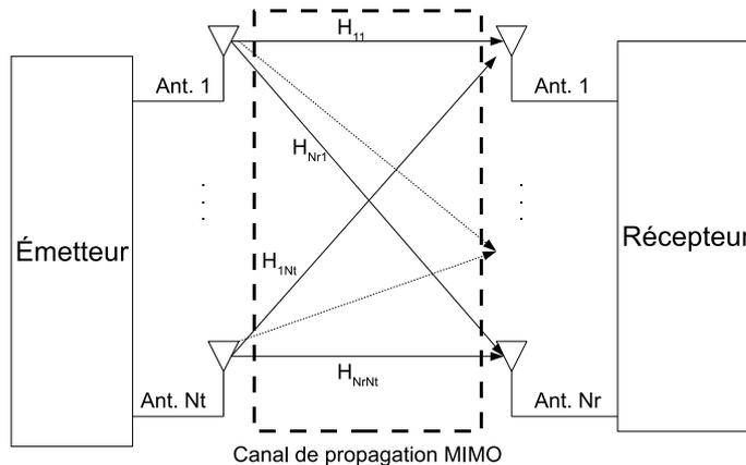
FIGURE 2.14 – Un système MIMO à  $N_t$  antennes d'émission et  $N_r$  antennes de réception.  $N_t \times N_r$  trajets sont créés. Chacun des trajets est représenté par un coefficient complexe  $h_{ij}$ .
