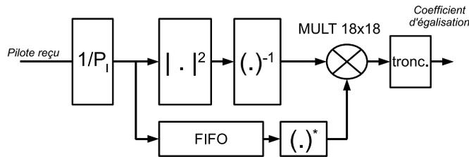
FIGURE 4.10 – Architecture du bloc *Estimation* (technique ZF).
