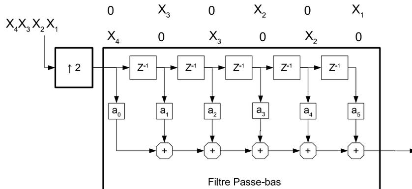
FIGURE 4.5 – Exemple d'interpolateur à base de suréchantillonneur d'ordre 2 et de filtre passe-bas d'ordre 5.
