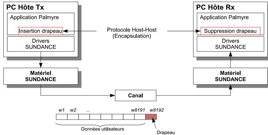
FIGURE 3.12 – Le protocole Host-Host : encapsulation des données utilisateur dans une trame de 8192 mots de 32 bit. Le dernier mot contient la valeur 0 (en cours de transmission) ou la valeur -1 (dernière trame, fin de transmission).
