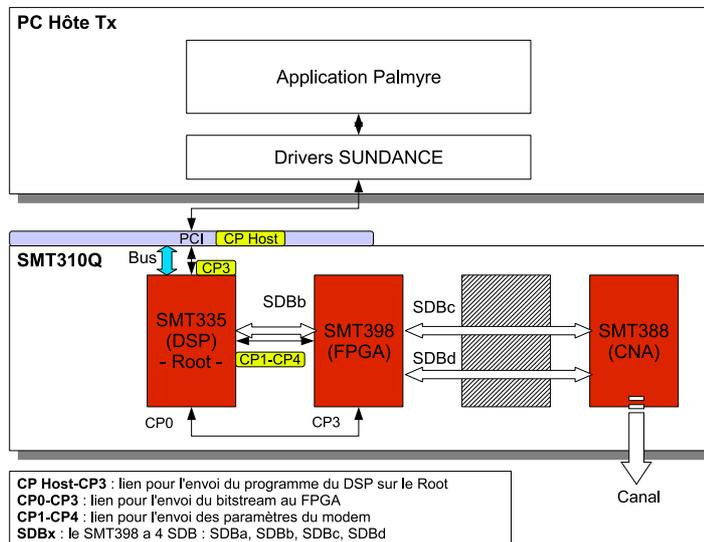
FIGURE 3.7 – Architecture de la plate-forme en émission (SISO).
