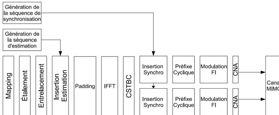
FIGURE 4.24 – Schéma original MIMO-MC-CDMA à l'émission.
