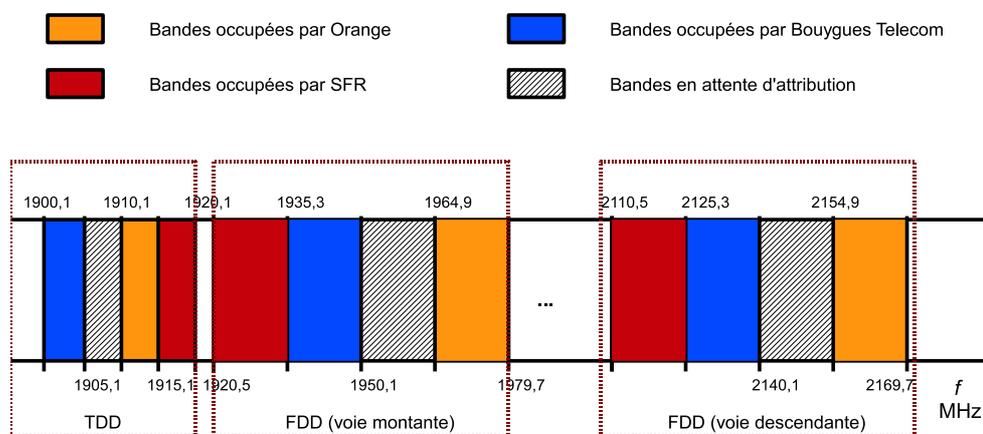
FIGURE 1.6 – Le partage de la bande 2,1 GHz entre les opérateurs en France.
