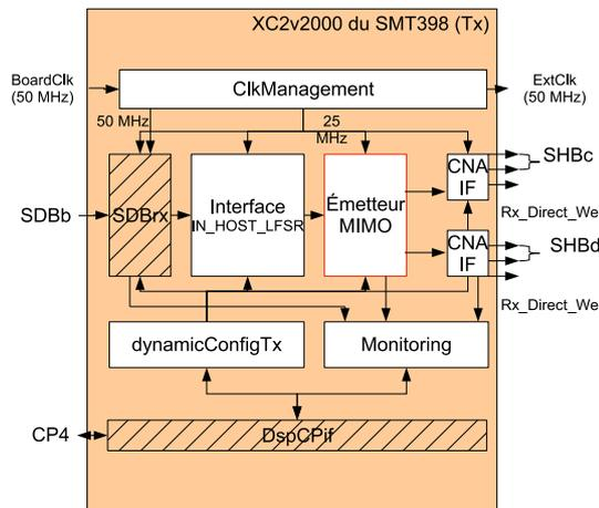
FIGURE 4.29 – Schéma de l'émetteur MIMO-MC-CDMA complet (non implantable).
