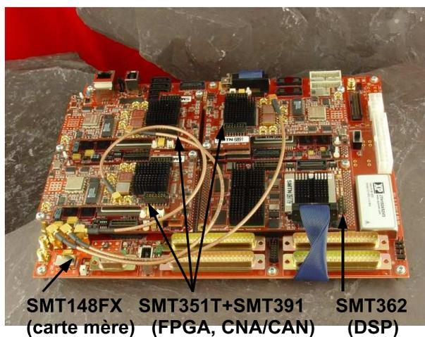
FIGURE 3.22 – Solution radio-logicielle SDR de SUNDANCE.
