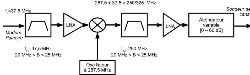
FIGURE 4.36 – Détail de la transposition en  $FI3 = 250$  MHz. Les filtres passe-bande doivent être paramétrables.
