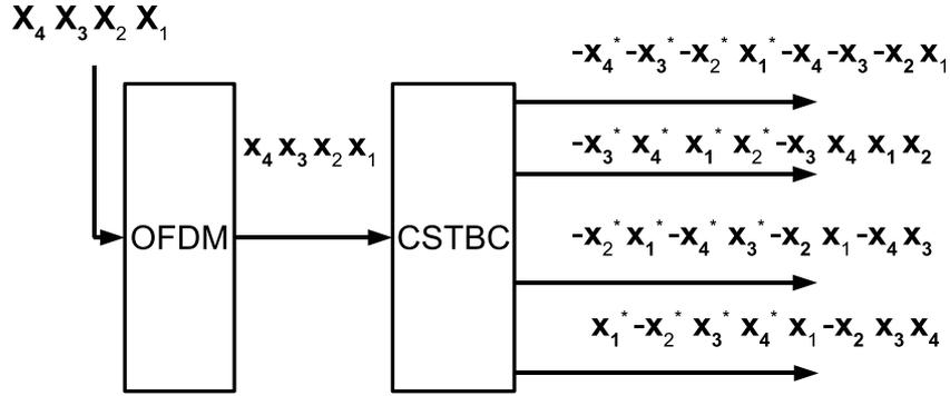
FIGURE 4.22 – Schéma OFDM-CSTBC optimisé pour  $N_t = 4$ .
