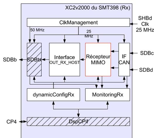
FIGURE 4.33 – Schéma du récepteur implanté sur le FPGA : les données d'une seule des deux antennes de réception peuvent être démodulées.
