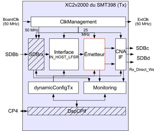
FIGURE 3.14 – Description de l'émetteur implanté sur le FPGA Virtex2.
