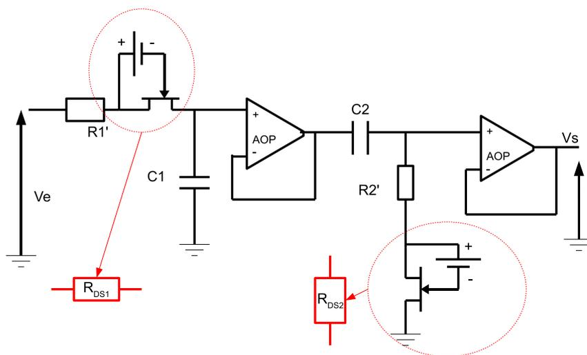
FIGURE 4.38 – Schéma final du filtre passe-bande après rajout des transistor JFET (résistance variable).
