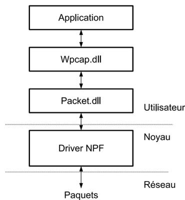
FIGURE 4.41 – L'architecture d'une application utilisant la librairie WinPcap.
