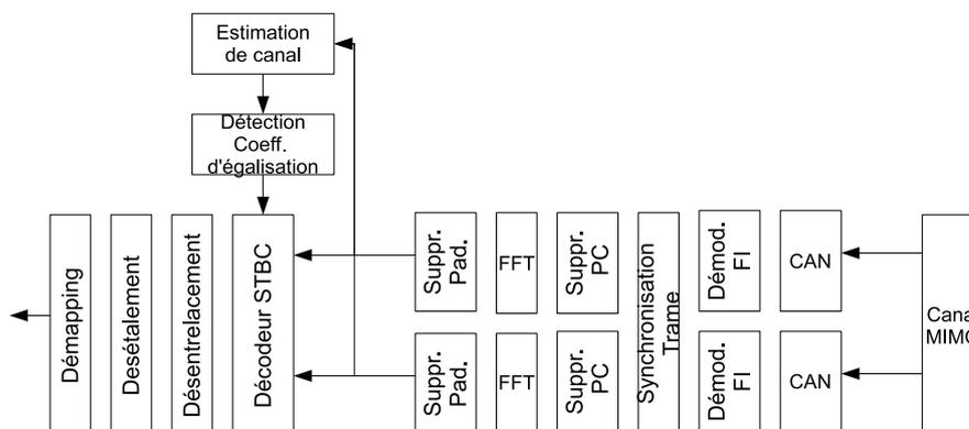
FIGURE 4.19 – Schéma classique MIMO-MC-CDMA en réception.
