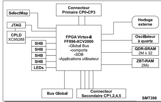
FIGURE 3.3 – Schéma du module TIM SMT398.
