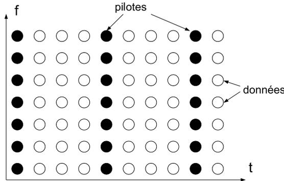
FIGURE 2.21 – Grille temps-fréquence (2D) pour l'estimation de canal.
