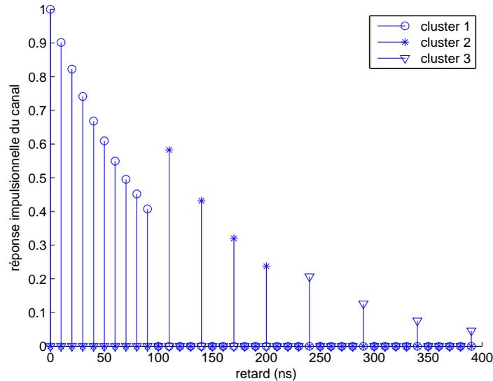
FIGURE 2.2 – Réponse impulsionnelle du canal BRAN A.
