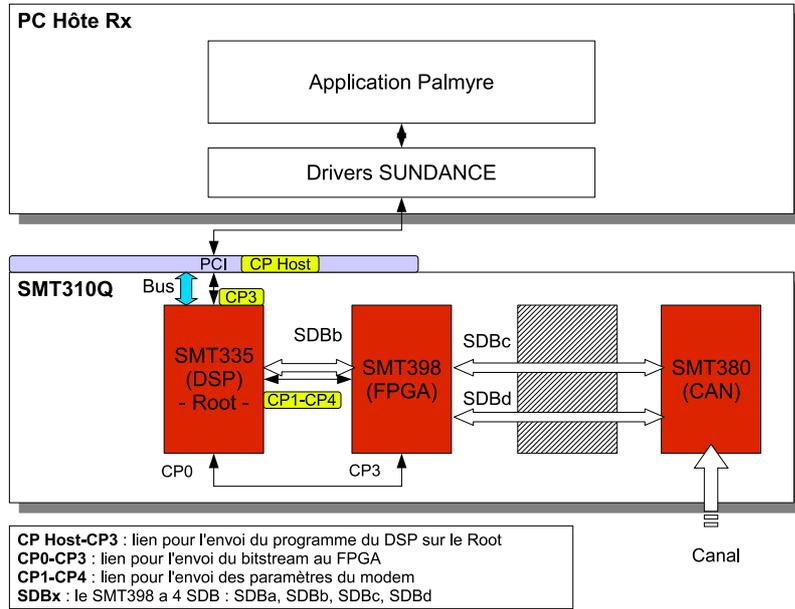
FIGURE 3.8 – Architecture de la plate-forme en réception (SISO).
