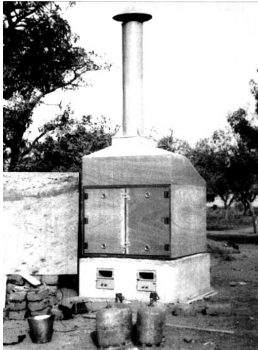
Photo. 3.1 : Séchoir à Gaz Atesta (Anon., 2006a) (Photo Geres)
