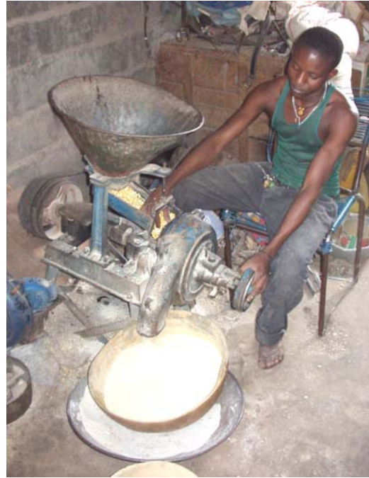
Photo. 1.2 : Burkina Faso Moulin à céréales utilisé en prestation de service
