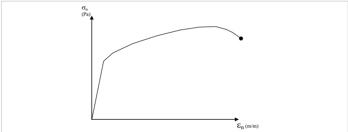
Figure 2-6 : Courbe de contrainte nominale / déformation nominale.
