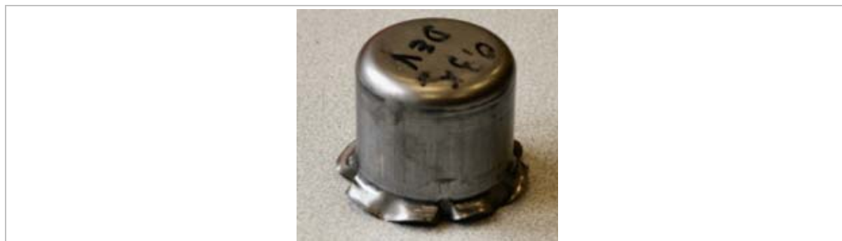
Figure 8-18: Test sur une pièce réelle de l'apparition du flambage.
