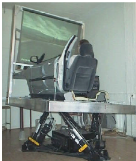
FIGURE 1.6 – Simulateur à plateforme parallèle de l'université de Chalmers - Suède
