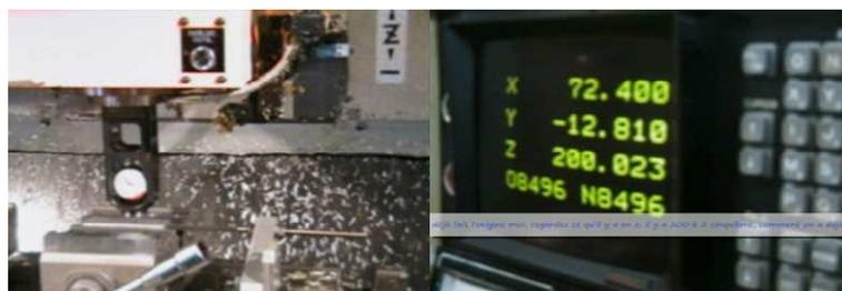
PREF en Z changement d'outil et point de contact capture d'écran avec le point de contact qui coïncide aussi avec l'ancienne origine
