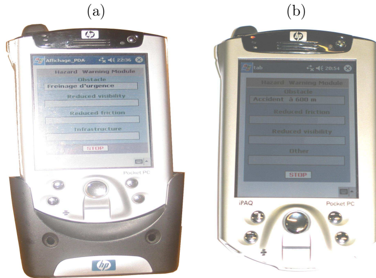
FIG. 5.17 – affichage de l’alerte sur PDA : (a) détection d’un freinage d’urgence, (b) détection d’un accident .
