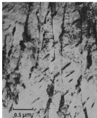
Figure I-16 : Orientations des particules de cémentite par rapport aux plaquettes de bainite [BE80].
