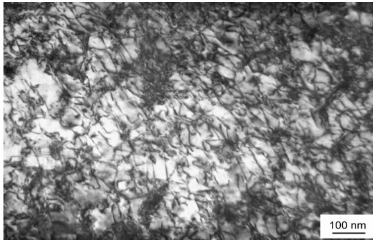
Figure II-28 : Microstructure de la martensite revenue déformée de e=9\% .
