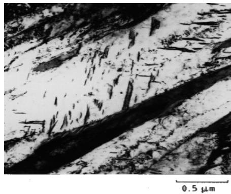
Figure I-15 : Microstructure de la bainite inférieure [BE80].
