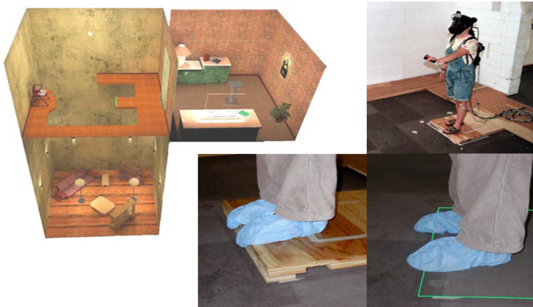
Fig. 1.16: L'utilisateur voit dans le monde virtuel un trou dans l'une des chambres. Le rebord dans la pièce est, soit complètement virtuel, soit simulé en utilisant un véritable plancher.
