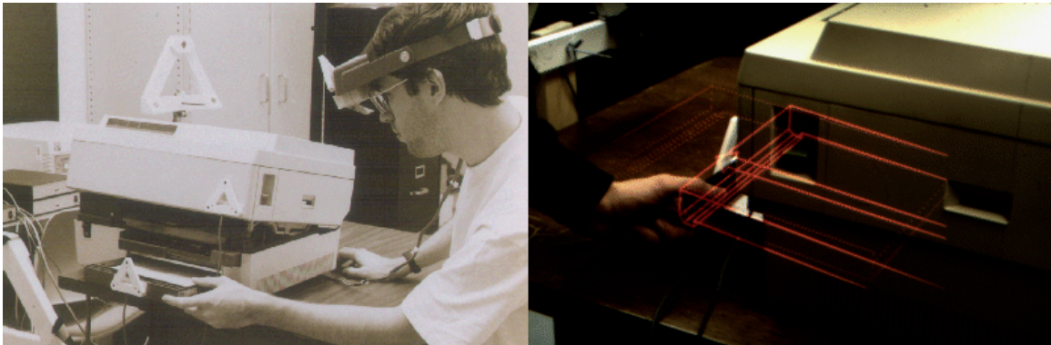
Fig. 1.2: Illustration du projet KARMA : banc de test et exemple d'ajout d'information visuelle pour la maintenance d'un photocopieur.
