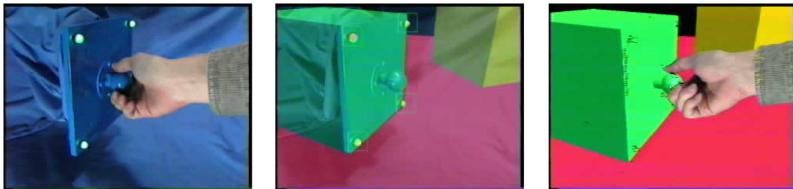
Fig. 1.18: Présentation du concept What You See Is What You Feel : une image réelle de l'interaction entre l'utilisateur et l'objet est enregistrée. Le modèle virtuel existe. La superposition des informations est possible et l'utilisateur a l'impression de toucher réellement l'objet qu'il manipule.
