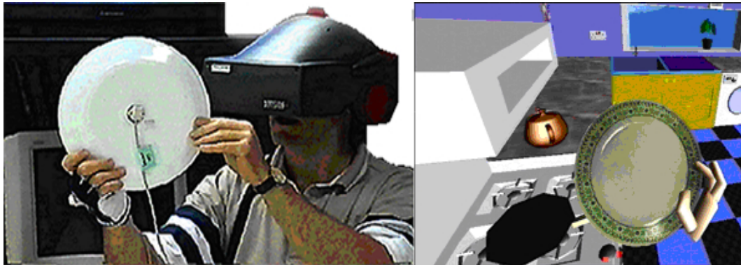
Fig. 1.15: L'utilisateur voit dans le monde virtuel une assiette et il la manipule dans le monde réel ce qui permet d'augmenter sa sensation d'immersion et le réalisme.
