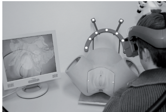
Fig. 1.4: Illustration du système de RA pour l'apprentissage au geste pour l'accouchement. L'écran sur la gauche présente ce que l'utilisateur voit à travers son visio-casque.
