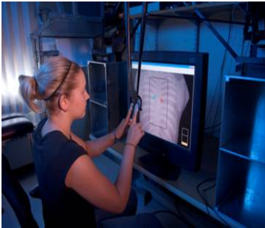
Fig. 1.9: Le simulateur VHB, Virtual Haptic Back, pour l'apprentissage du diagnostic palpatif.
