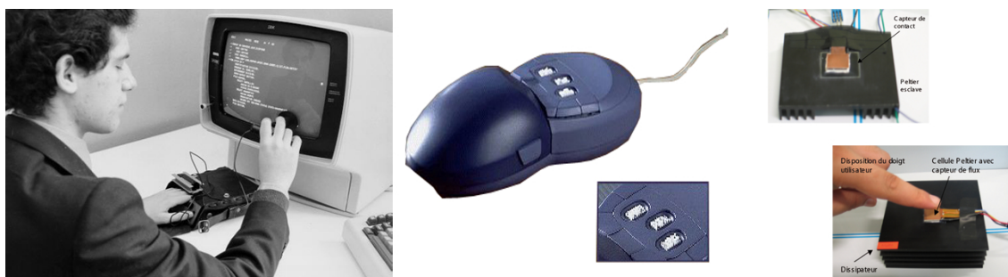
Fig. 1.8: Présentation de différentes interfaces tactiles : l'interface Optacon, Virtouch et une solution thermique à base d'interface Peltier.
