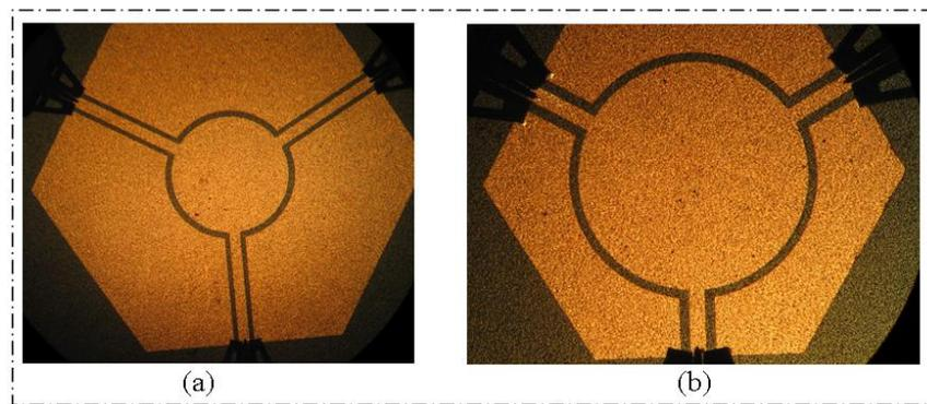
Figure IV-23 : une cliché des prototypes fabriquées : (a) les prototypes initiale avant ( $12 \times 12 \text{ mm}^2$ ), (b) après où les accès sont raccourcies ( $6 \times 6 \text{ mm}^2$ ).
