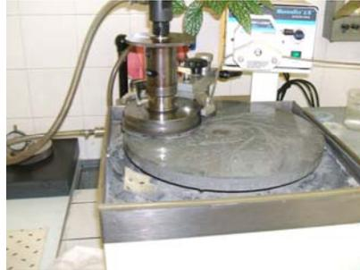
Figure IV-7: Meuleuse utilisée pour le rodage de ferrite.
