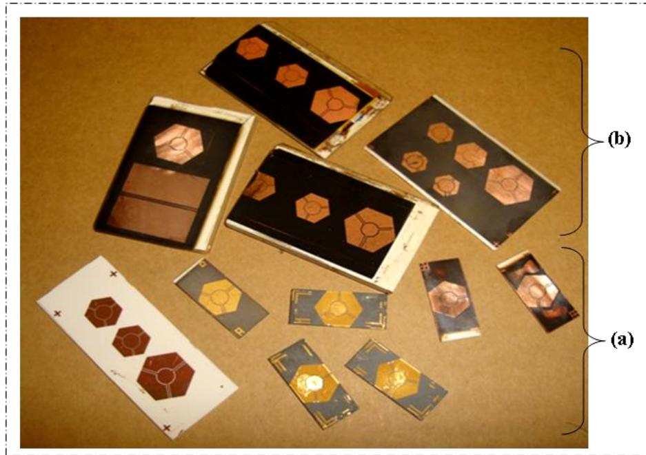
Figure IV-9: Différents échantillons réalisés avec (a) des couches de Y10 en or (b) des couches de Y101 en cuivre.
