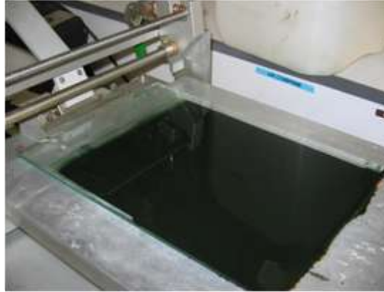
Figure 8 : Réalisation d'un film à l'aide d'un filmographe sur un support plastique
