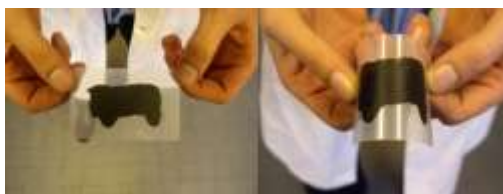
Figure 10 : Photo de films réalisés montrant la facilité de mise en œuvre des composites
