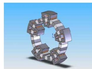
Figure 36: exemple demachine à plot pentaphasée [50]
