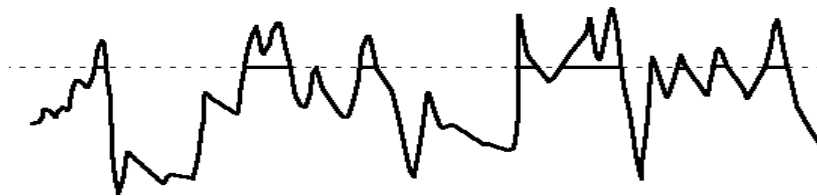
Figure I.21 : Définition de l'interférence des aspérités avec un plan horizontal
