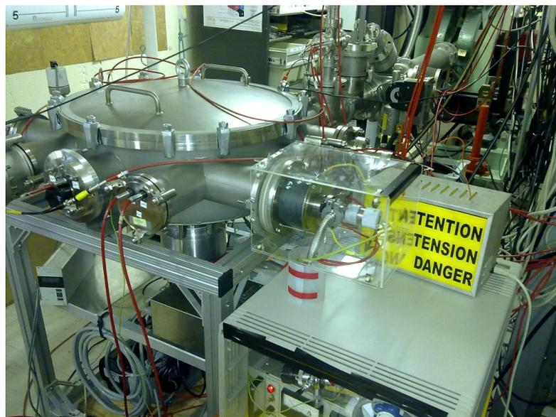
FIGURE B.11 – *Photo générale de l'expérience avec la source Penning sur une bride de l'enceinte du Cirque ( Février 2008)*
