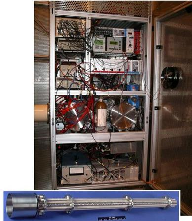
FIGURE 5.8 – Photo de la cage contenant le piège de refroidissement et l'électronique associée. Le détail du bas montre le RFQ seul
