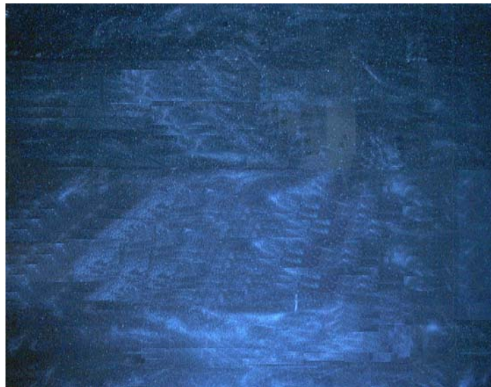
Figure 3.46 Visualisation du régime turbulent à Ta/Ta_{c1} = 106 , \Omega = 1.97tr/s
