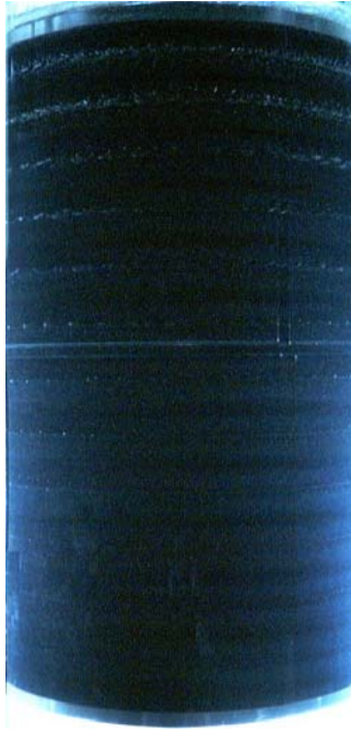
Figure 5.3 Visualisation de l'arrangement des bulles à Ta=4500 13 colliers stratifié, Pe= 10 kPa.
