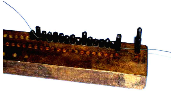
FIG. 5.9: Mise en forme du fil ondulé
