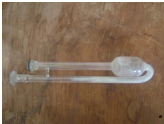
Figure 11 : Réacteur utilisé pour les analyses RTP
