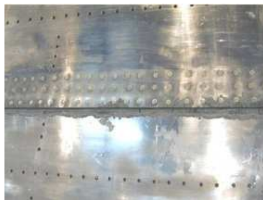
FIG. 1.2 – Gros-plan sur une partie de carlingue d'avion mettant en évidence les lignes de joints rivetés.
