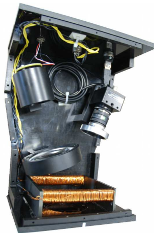
FIG. 2.55 – Vue de la tête magnéto-optique intégrée du prototype EADS.
