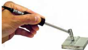
FIG. 1.8 – Exemple de capteur crayon utilisé pour l'inspection d'une soudure.
