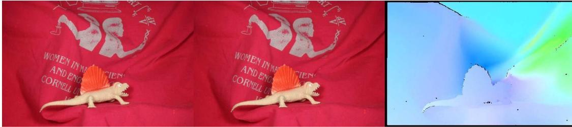
FIGURE 1.5 – L'exemple Dimetrodon issu de la base de données Middlebury, disponible à l'adresse <http://vision.middlebury.edu/flow/data/>. À gauche et au milieu : une paire d'images issues d'une séquence vidéo. À droite : la vérité terrain du flot optique, encodée en format (teinte, saturation) par Baker et al. [2007]. Le lecteur se référera à l'Annexe C pour plus de détails à ce sujet.
