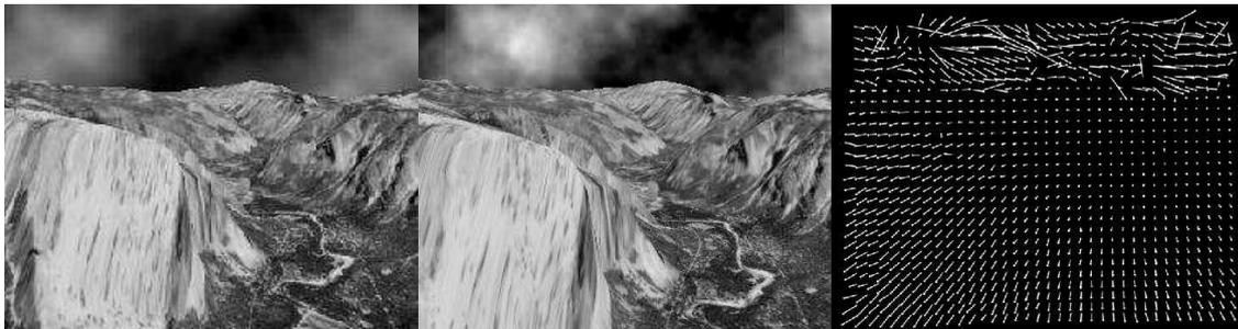
FIGURE 1.3 – La séquence de test Yosemite disponible à l'adresse <http://www.cs.brown.edu/~black/images.html>. À gauche et au milieu : une paire d'images extraites de la séquence. À droite : le flot optique estimé par la méthode de B.Horn and B.Schunck [1981].
