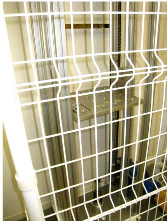
FIGURE 5.7 – À gauche, le montage expérimental. Le modèle (1) est placé sur un plateau (2) qui peut être translaté verticalement avec un guidage avec des rails (4) et des galets (5). Pendant l'expérience, le plateau est monté à une hauteur de 2 mètres et tombe en chute libre. b) Le modèle est alors stoppé avec un amortisseur progressif sur 5 cm (3). A droite, la cage englobant le dispositif de chute de la maquette.
