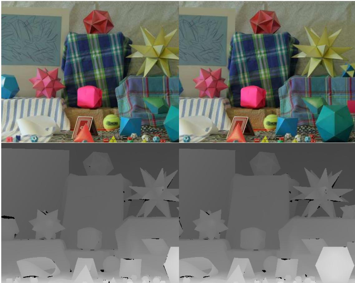
FIGURE 2.9 – En haut : paire stéréo Moebius composée des images 1 et 5. En bas : disparités associées. En bas à gauche : disparité entre les images 1 et 2 de la séquence. En bas à droite : disparité entre les images 5 et 6 de la même séquence. La séquences est téléchargeable sur <http://vision.middlebury.edu/flow/data/>
