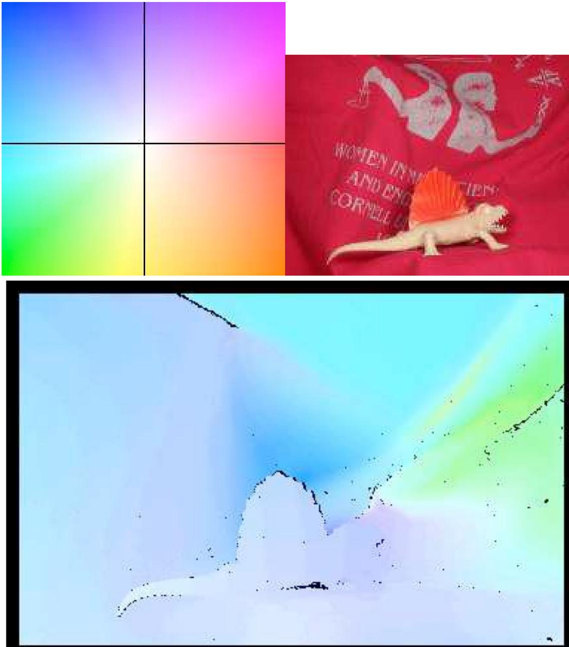
FIGURE C.1 – En haut à gauche : grille de couleurs utilisée pour représenter les valeurs (norme et angle) d'un champ vectoriel 2D, ou d'un champ scalaire. Dans ce dernier cas les valeurs sont encodées sur l'axe des abscisses. En haut à droite : la première image de la séquence Dimetrodon de la base de données Middlebury. En bas : la vérité terrain en codage (teinte, saturation)
