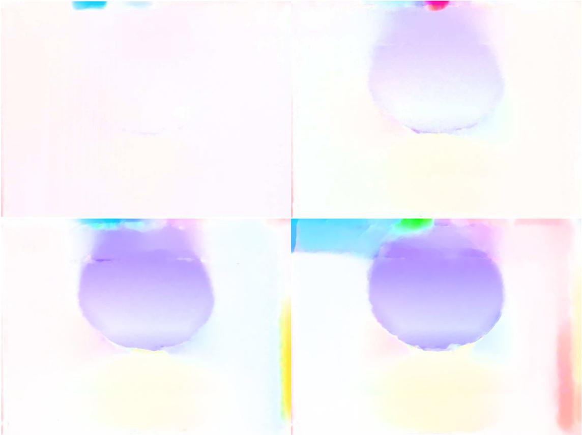
FIGURE 5.20 – Codage (teinte, saturation) de l'évolution de la composante flot optique ( $U, V$ ) du flot de scène. En haut à gauche : entre les paires 1 et 2. En haut à droite : entre les paires 2 et 3. En bas à gauche : entre les paires 3 et 4. En bas à droite : entre les paires 4 et 5. Outre l'effondrement d'un des versants, on constate bien l'apparition d'un déplacement symétrique sur l'autre versant.
