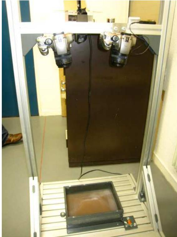
FIGURE 1.1 – Système stéréoscopique composé d’une paire d’appareils photos numériques observant un même objet. Dans ce cas les appareils ne sont pas parallèles, et la baseline correspond simplement à l’écart entre les deux appareils photos mesuré sur la barre métallique leur servant de support.
