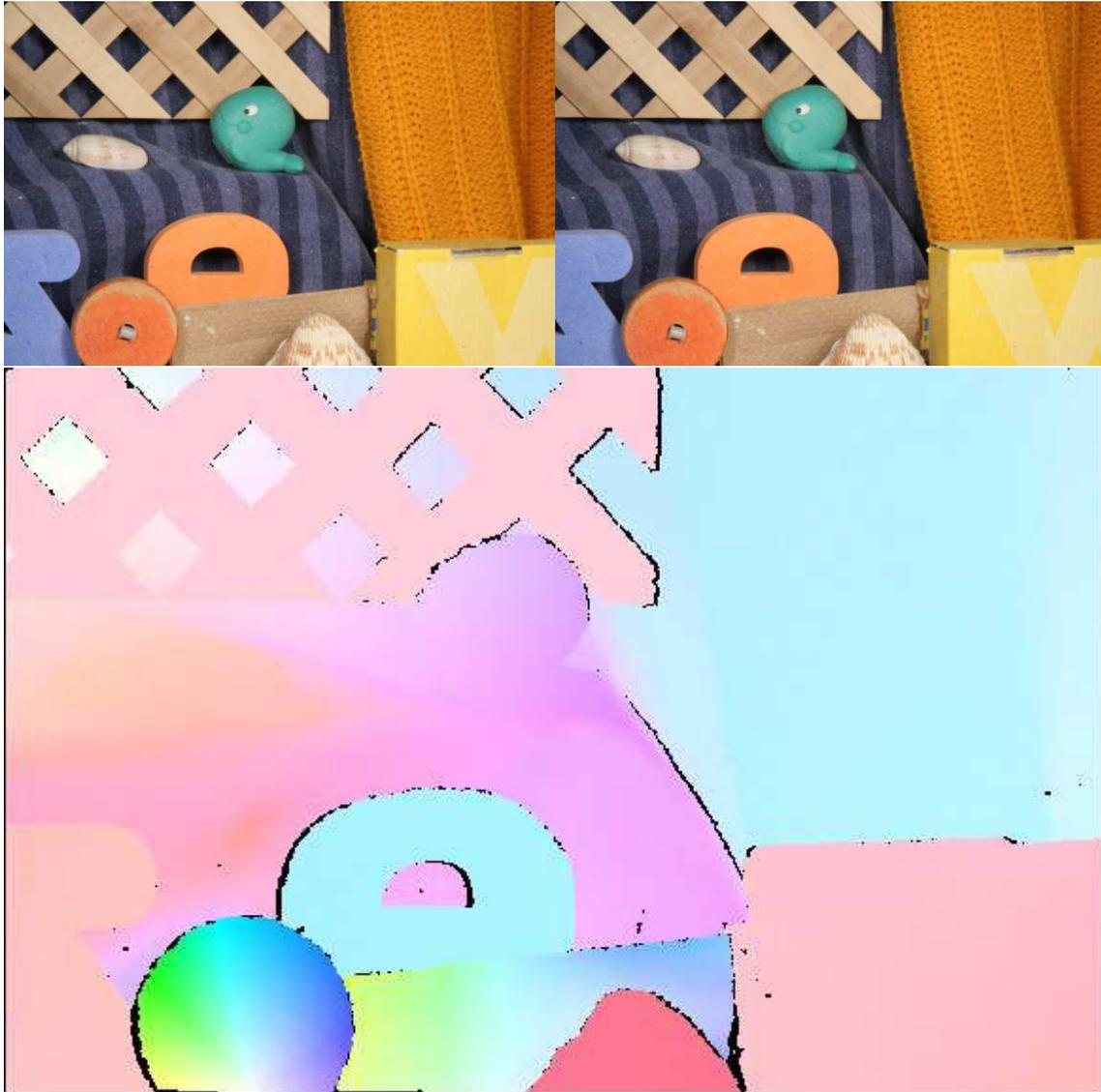
FIGURE 3.2 – L'exemple RubberWhale issu de la base de données Middlebury, disponible à l'adresse <http://vision.middlebury.edu/flow/data/>. Les deux premières images constituent deux images consécutives d'une séquence. La troisième image donne la vérité terrain du flot optique. On remarque immédiatement que les contours des objets coïncident avec les discontinuités du flot optique.
