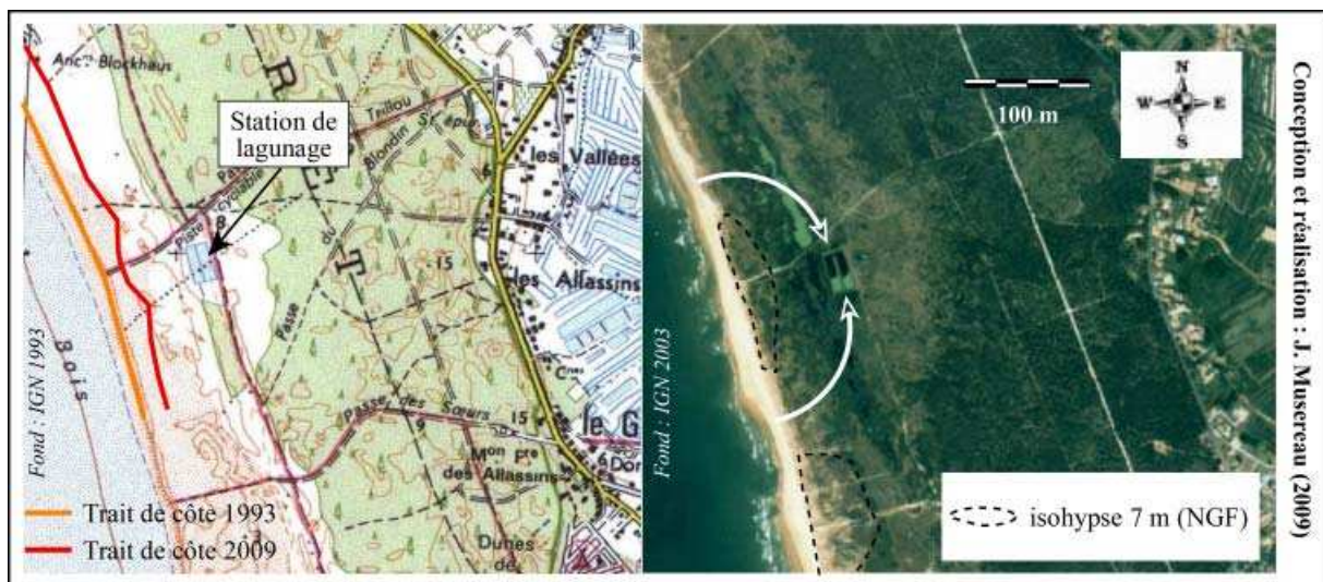
Figure 115 : Risque encouru au niveau de la station de lagunage des Allassins
