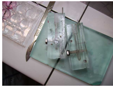
Figure 3.15: Photo d'un tissu biologique (culture cellulaire) monté sur une chambre d'ussing.
