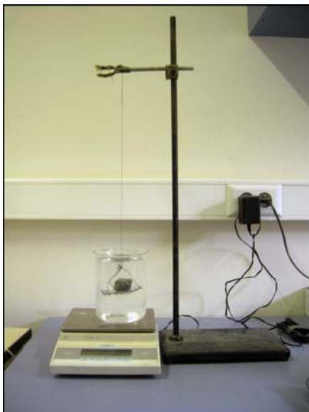
Figure 2.7 Photographie et schéma du dispositif permettant la mesure de la masse volumique des clastes > -4 φ (16 mm) par immersion.
