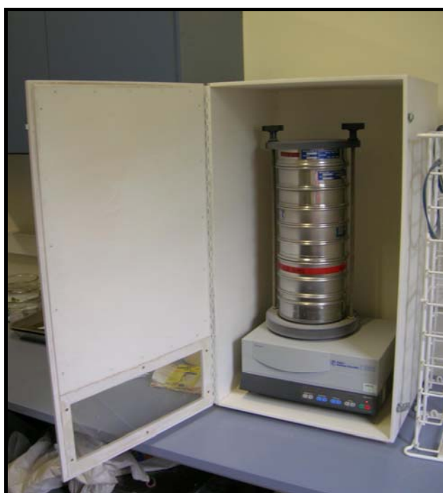
Figure 2.10 Photographie d'une colonne vibrante de tamis rangés par taille de maille croissante.
