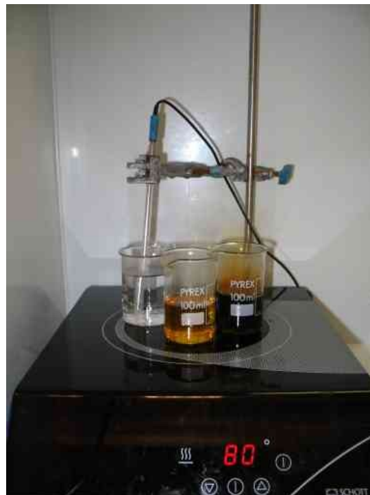
Figure 3-6 : Préparation chimique de la puce FPGA avec le mélange "eau oxygénée – ammoniacale" à 80°C
