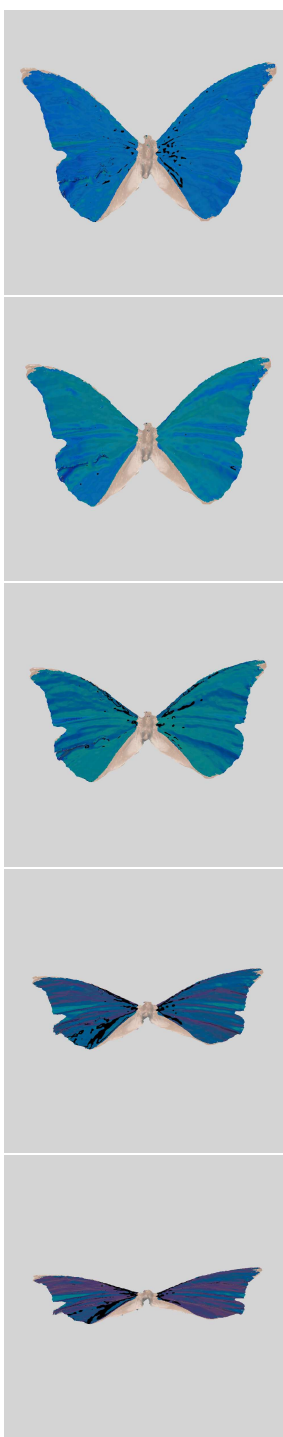
FIG. 6.1 – Images virtuelles de M. rhetenor simulées avec la méthode RCWA et le logiciel virtuelium. L'angle entre la normale au papillon et la caméra prend les valeurs 0, 20, 40, 60 et 70°.
