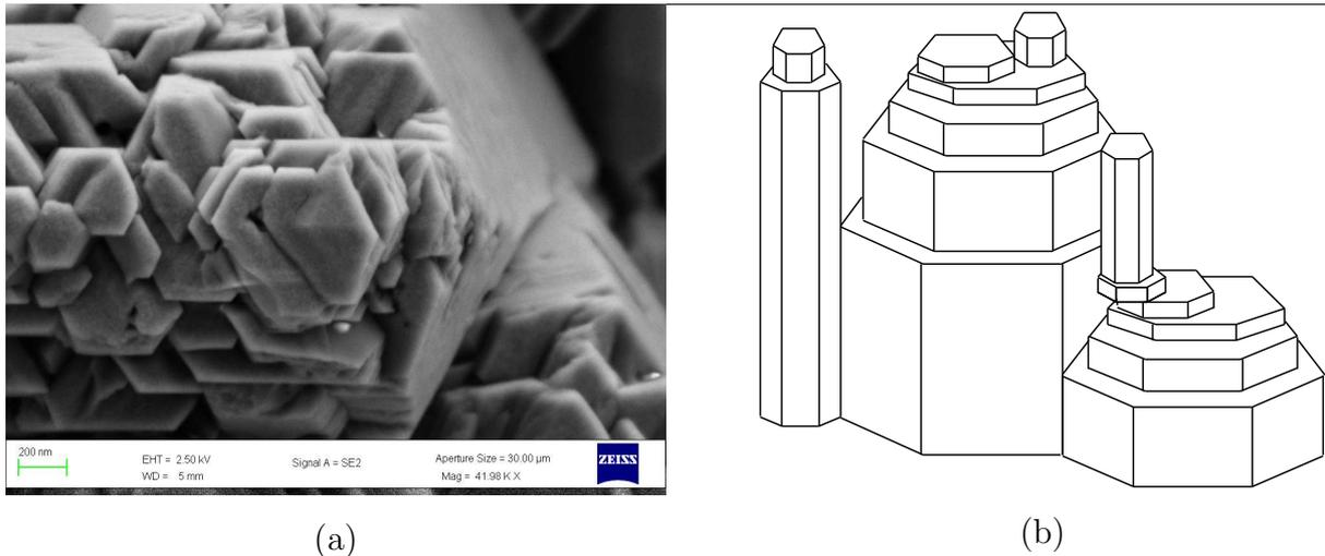
**Fig. 5.9:** Image MEB d'un bâtonnet dans le cas d'un ajout de CAP en goutte à goutte (a) et un schéma probable du modèle de croissance (b).
