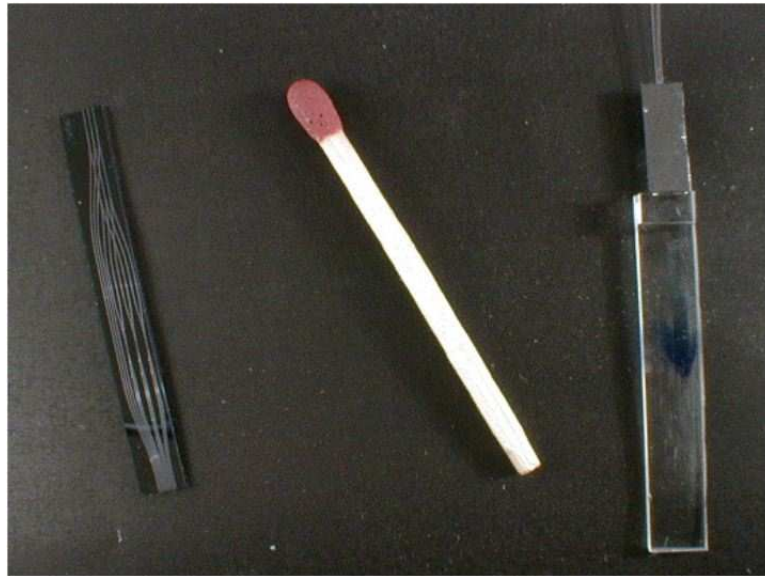
FIG. 5.11 – Recombineur en optique intégrée à trois faisceaux (LETI).
