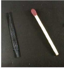
FIG. 3.2 – Gauche : Photographie d'un recombineur en optique intégrée. Sa taille miniature lui confère une grande stabilité vis-à-vis de la température notamment. Droite : Schéma du recombineur à trois télescopes IONIC (site du LAOG). Des jonctions Y divise un faisceau en deux pour l'acheminer vers les coupleurs X qui assurent la combinaison coaxiale avec un autre faisceau. Le symbole * désigne un interférogramme complémentaire.
