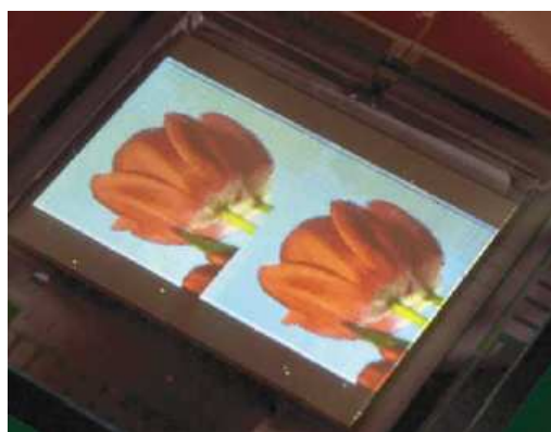
Figure 13: Ecran polychrome tout polymère à base de OLED réalisé par Philips Electronics [66].
