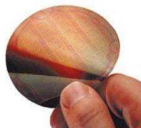
Figure 18: Premier "wafer" souple de transistors 'tout organique' réalisé par Philips [113].
