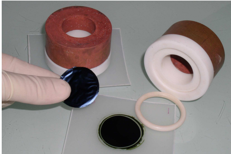
Figure 71: Films de PANI dopée sur substrat et auto-supportés.
