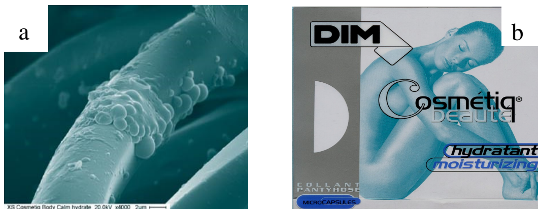
Figure 4. Microcapsules utilisées dans le domaine textile. (a) Microscopie des microcapsules intégrées dans les textiles. (b) Collant hydratant en textile à microcapsules.
