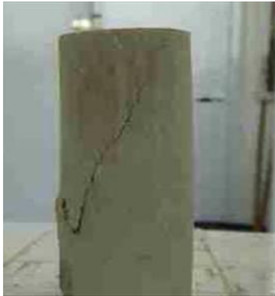
Figure 5.10 : Rupture d'un échantillon en compression simple
