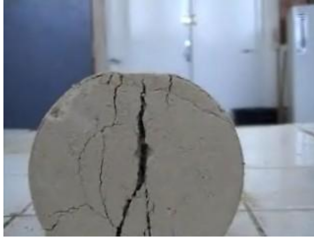
Figure 5.21 : Poinçonnement de l'éprouvette au voisinage de la génératrice de chargement
