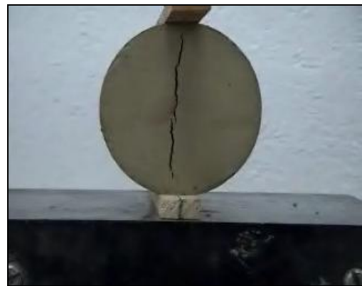
Figure 5.24b : Rupture de l'éprouvette à la vitesse 1mm/min
