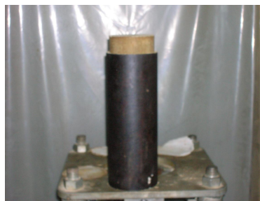
Figure 5.8 : Moule de compactage des éprouvettes cylindriques
