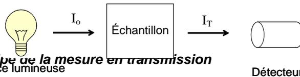
Figure 2-24 : Principe de la mesure en transmission
