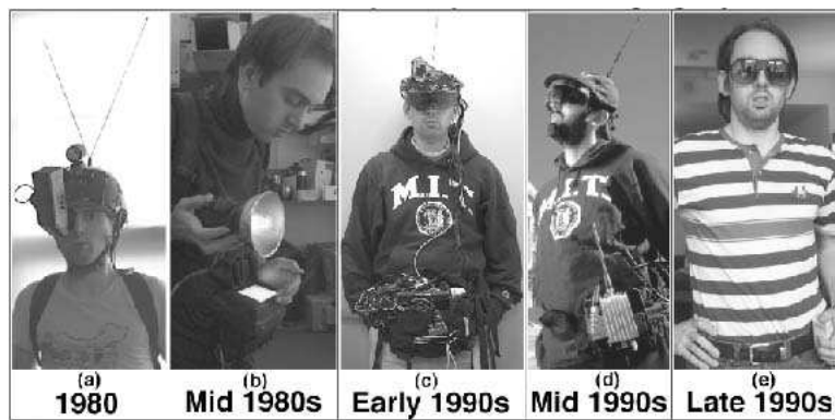
FIG. 1.12 – Évolution au fil des années de l'équipement de Steve Mann, l'un des cyborgs du MIT qui portent en permanence des ordinateurs vestimentaires dans le but de les tester et de les améliorer [MANN 96].
