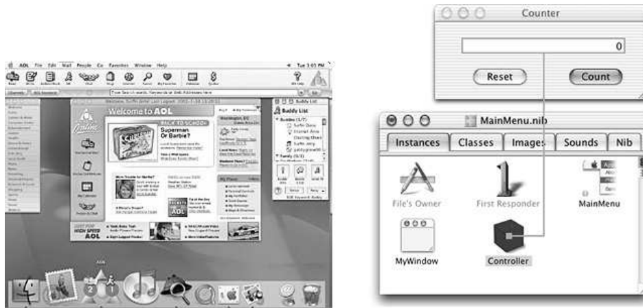
FIG. 5.16 – À gauche : le dock de Mac OS X (en bas de la fenêtre). À droite : Interface Builder d'Apple, qui permet de connecter graphiquement des widgets à leur modèle, et de visualiser ces connexions à tout moment.
