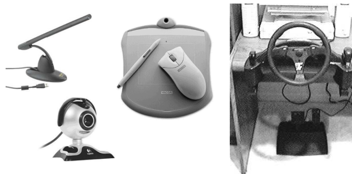
FIG. 1.14 – Trois dispositifs grand public à prix abordable (microphone, webcam et tablette graphique), ainsi qu'un ordinateur personnel configuré pour un jeu de course automobile.
