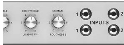
FIG. 3.2 – Façade d’un amplificateur de guitare électrique (1959SLP de chez Marshall) comportant quatre entrées distinctes. Chaque entrée contrôle un type de son particulier en termes de gain et de brillance.
