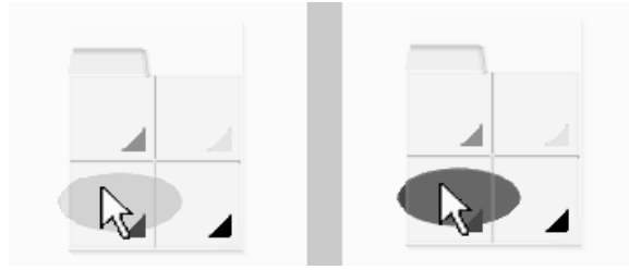
FIG. 1.20 – Une toolglass comportant quatre outils de changement de couleur. L'utilisateur clique sur une ellipse à travers l'un de ces outils, ce qui a pour effet de modifier la couleur de l'objet graphique.
