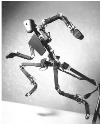
FIG. 1.8 – L'armature mécanique Monkey de Digital Image Design. Les parties peuvent être réassemblées pour former d'autres personnages [KNEP et al. 95].
