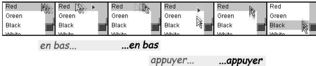
FIG. 4.32 – Exemple d'utilisation du curseur vocal. Les mots gris sont les mots prononcés, et les mots en noir sont les mots reconnus. Les images ont été retouchées pour rendre compte des mouvements du pointeur.
