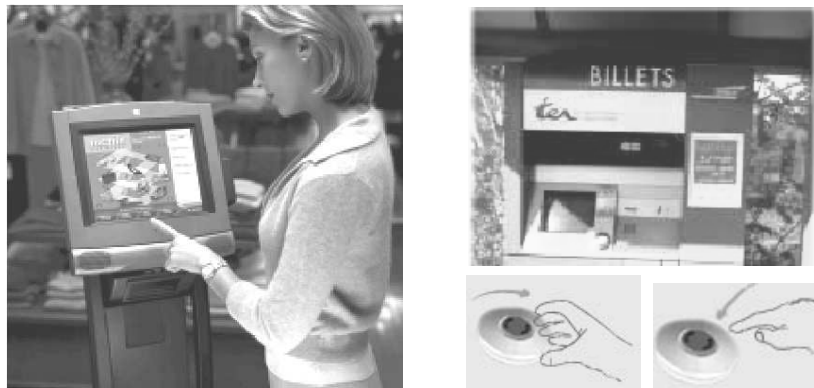
FIG. 1.10 – À gauche : une borne d'information utilisant un écran tactile. À droite : la "molette" employée dans le Distributeur de Billets Régionaux de la SNCF.
