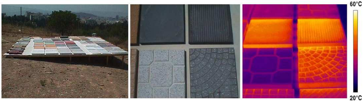
Figure 1.9 : Photo et thermographies IRT des revêtement testés dans l'étude de [Doulos et al., 2004]
